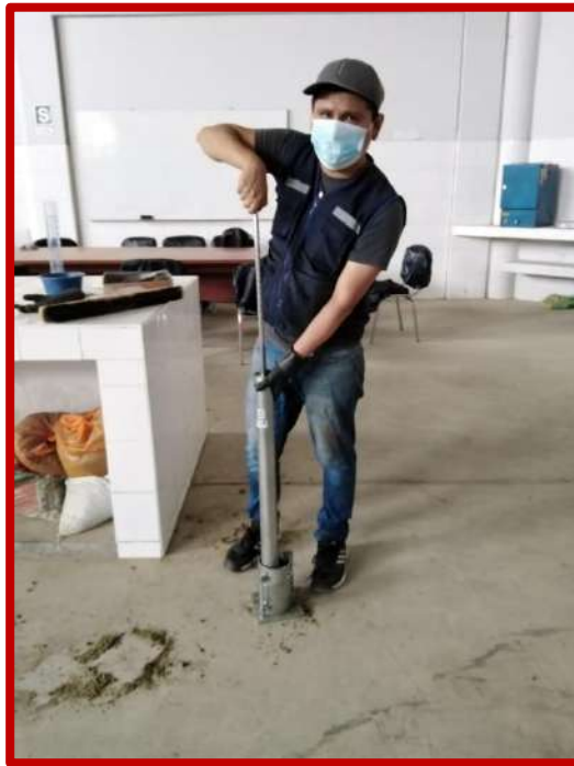
Figura N°63 y 64: compactación del material en 5 capas, haciendo uso del pisón manual y peso del molde con la mezcla de suelo natural y escoria compactada.
