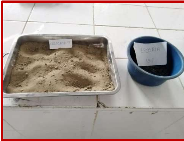
Figura N°57 y 58: preparación de suelo natural de la calicata N°4 con 15% y 25% de escoria.
