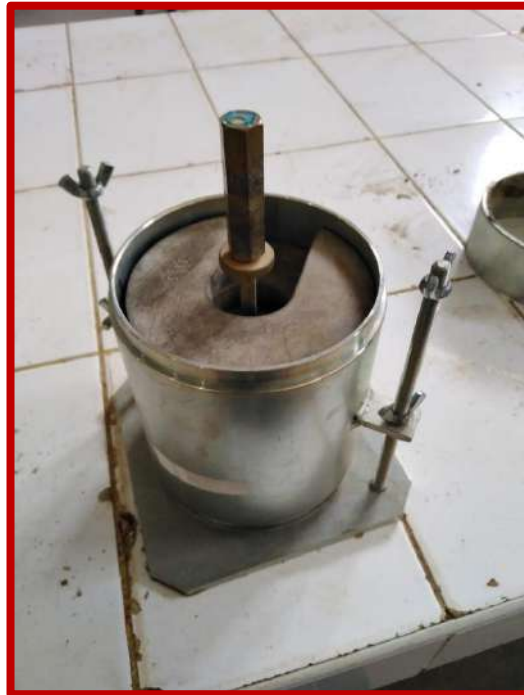
Figura N°42: se colocan las sobre cargas anular, circular y la placa perforada con vástago sobre los moldes de CBR
