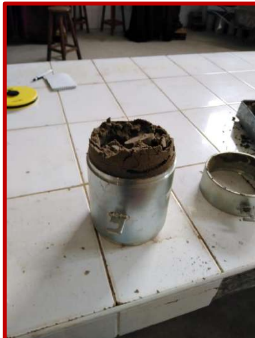
Figura N°39, 40 y 41: toma de muestra, compactación de la mezcla de suelo con su óptimo contenido de humedad, haciendo uso del pisón en 5 capas de suelo natural.
