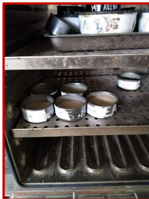
Figura N°16, 17 Y 18: determinación de contenido de humedad de las muestras de suelo.
