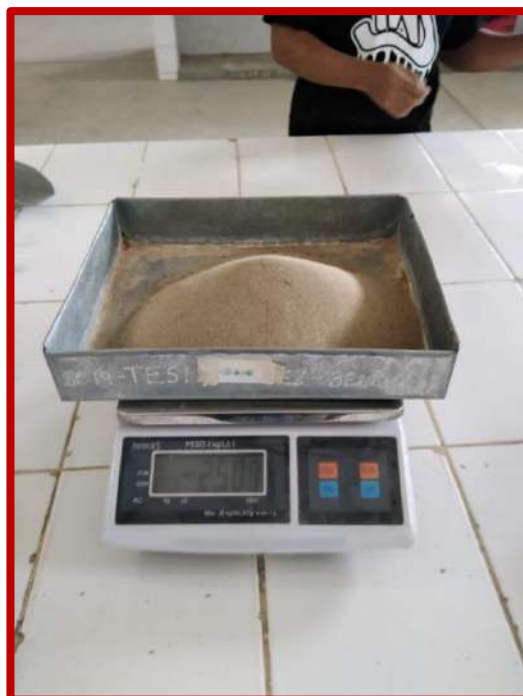
Figura N°34 y 35: preparación de muestra representativa para el ensayo de Proctor modificado del terreno natural.
