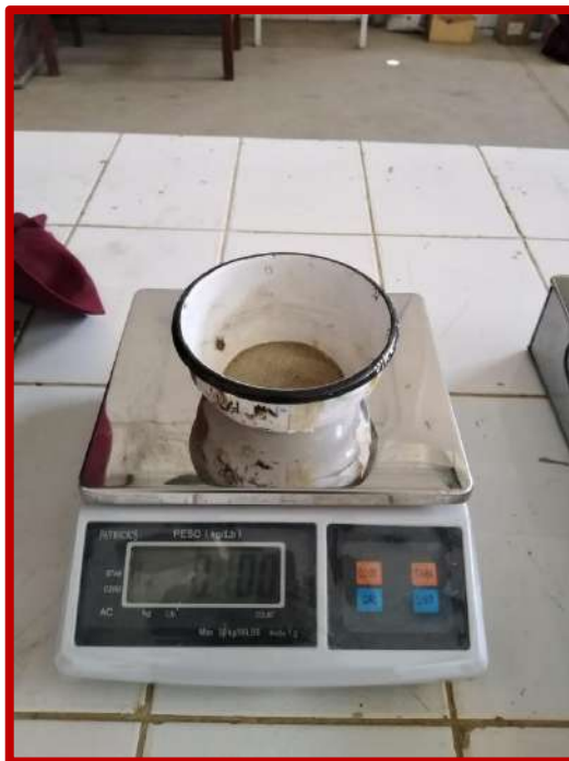
Figura N°31 y 32: peso de muestra representativa y vertido de este en el picnómetro haciendo uso del embudo.
