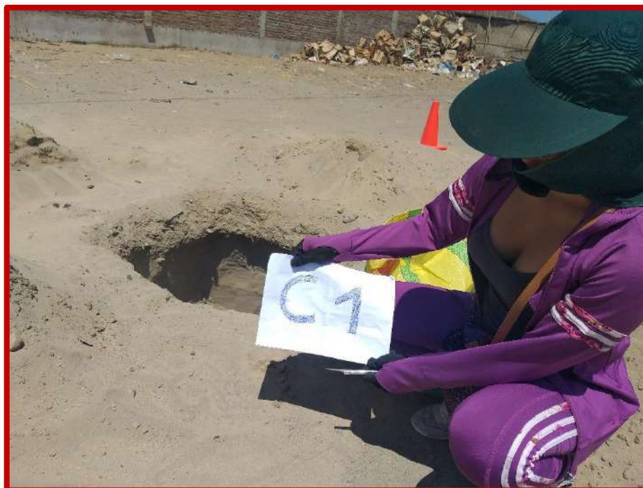
Figura N°06: excavación de calicata N°01 a una profundidad de 1.50m
