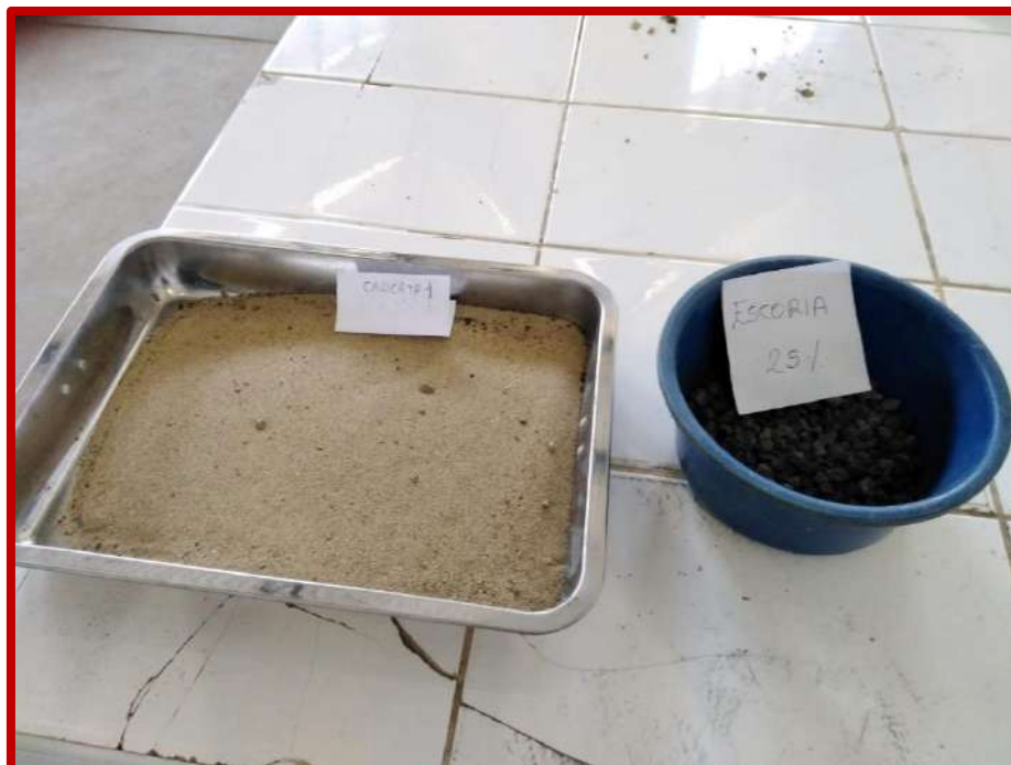
Figura N°53: preparación de muestra de suelo natural de la calicata 1 con 25% de escoria
