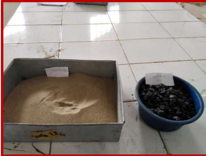
Figura N°60 y 61: preparación de suelo natural de la calicata N°2 con 40% de escoria mezclado con su óptimo contenido de humedad
