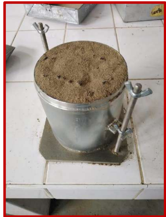
Figura N°63 y 64: compactación del material en 5 capas, haciendo uso del pisón manual y peso del molde con la mezcla de suelo natural y escoria compactada.
