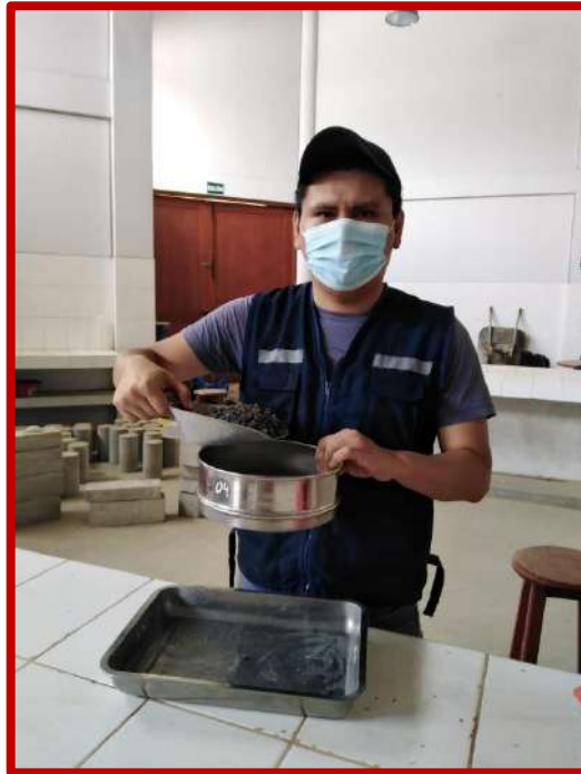
Figura N°46: tamizaje del material de escoria por la malla N°04
