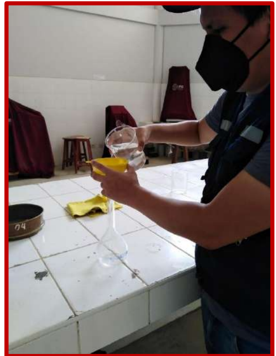
Figura N°29 y 30: llenado con agua destilada del picnómetro, hasta la marca de calibración
