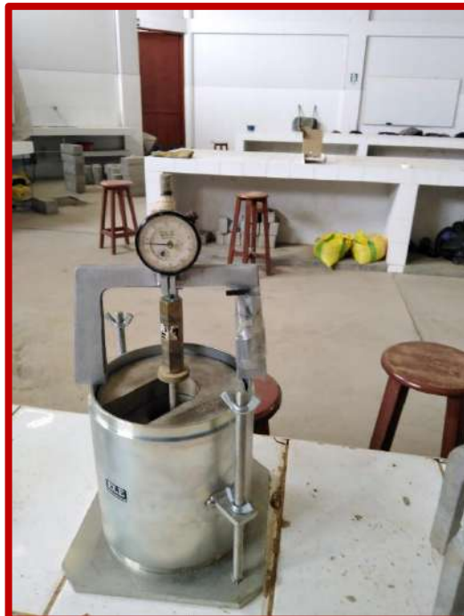
Figura N°43: se procede a la saturación, para eso se coloca el trípode con el dial de deformaciones sobre el canto de molde y se ajusta el vástago de placa perforada. Se registra la lectura antes de sumergir al agua.
