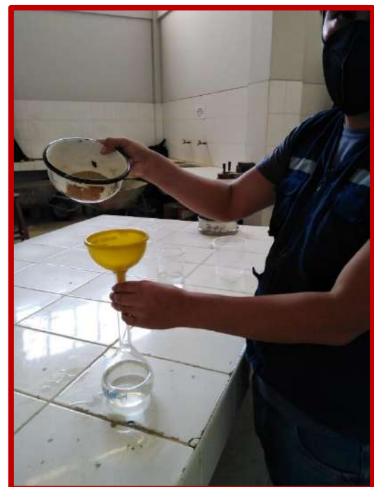
Figura N°31 y 32: peso de muestra representativa y vertido de este en el picnómetro haciendo uso del embudo.
