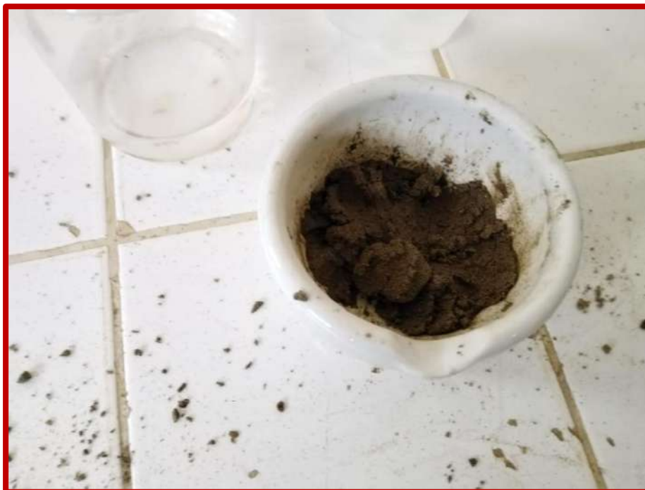
Figura N°23: preparación de la muestra de suelo para posteriormente ser aplicada en la copa de Casagrande y determinar su contenido líquido.
