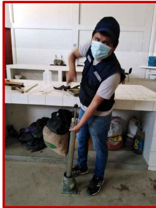
Figura N°36: compactación del suelo natural, mediante un pisón manual dando 25 golpes por capa.
