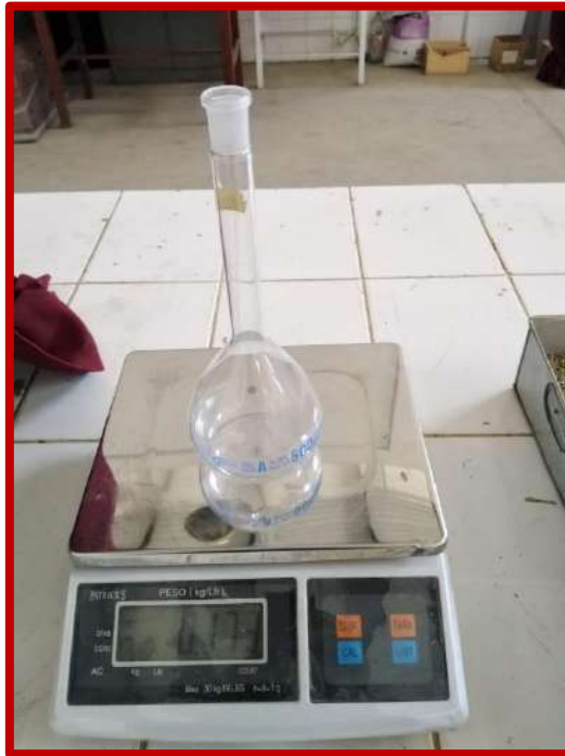
Figura N°29 y 30: llenado con agua destilada del picnómetro, hasta la marca de calibración
