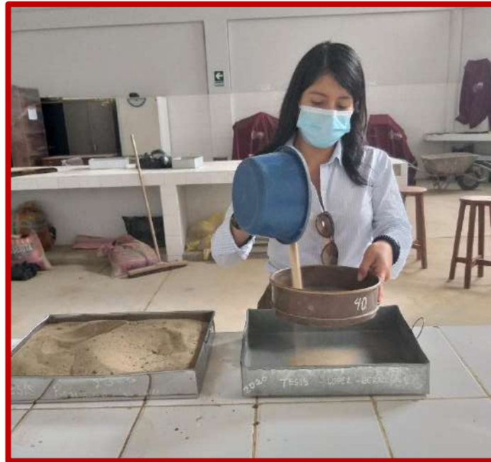
Figura N°22: muestra representativa de suelo, pasada por el tamiz N°40
