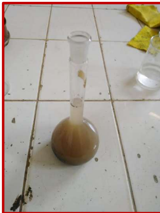
Figura N°33 y 34: proceso de ebullición para posteriormente determinar la gravedad específica del sólidos de suelos mediante picnómetro de agua (MTC E 113)
