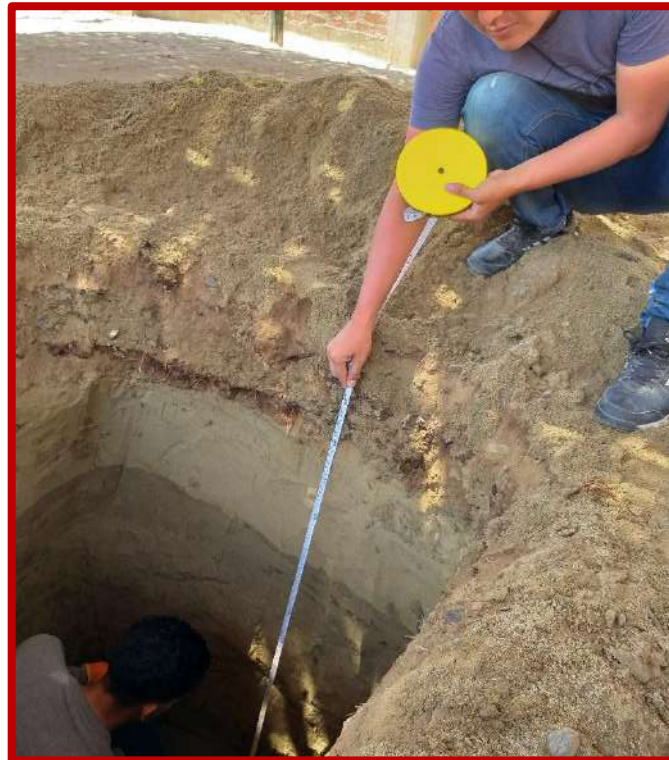
Figura N°10: calicata N°03 con profundidad de 1.50m
