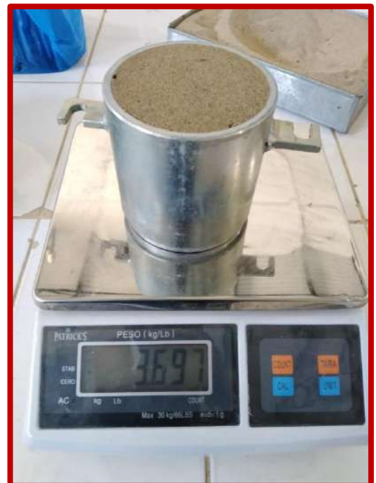
Figura N°50 y 51: retiro de collar sobre el molde de 6” y peso del molde con la muestra previamente enrasada y compactada.
