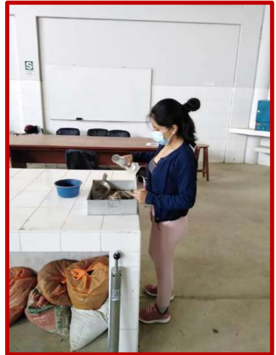
Figura N°60 y 61: preparación de suelo natural de la calicata N°2 con 40% de escoria mezclado con su óptimo contenido de humedad
