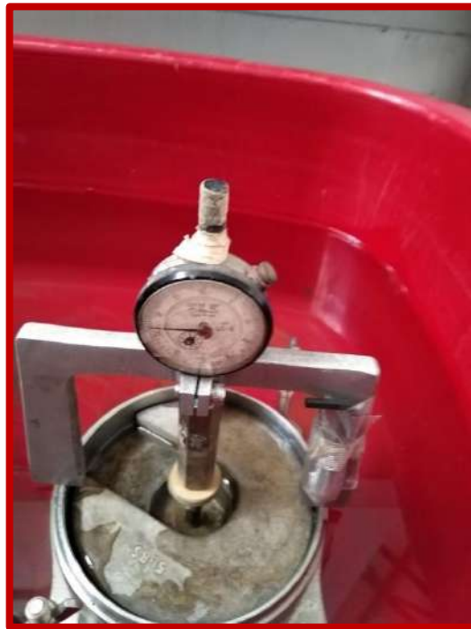
Figura N°44: molde sumergido en agua, proceso de saturación del terreno natural.
