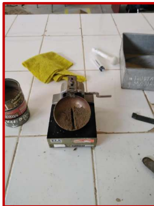
Figura N°25: determinación del límite líquido, haciendo uso de la copa de Casagrande.
