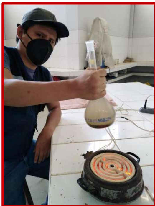
Figura N°33 y 34: proceso de ebullición para posteriormente determinar la gravedad específica del sólidos de suelos mediante picnómetro de agua (MTC E 113)
