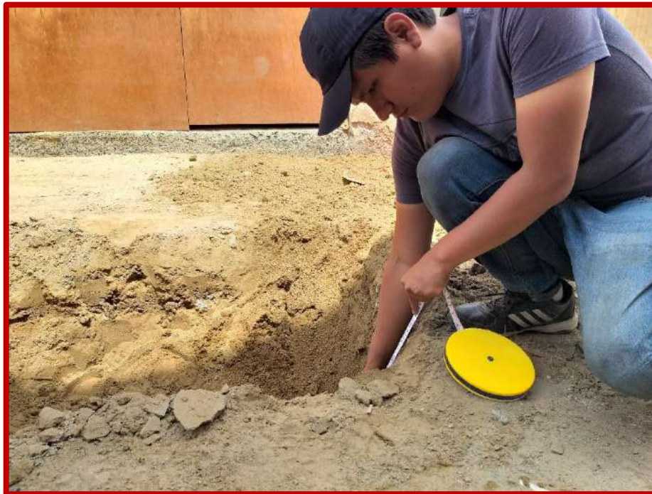
Figura N°11: calicata N°04 con profundidad de 1.50m
