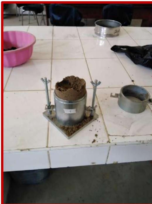
Figura N°50 y 51: retiro de collar sobre el molde de 6” y peso del molde con la muestra previamente enrasada y compactada.
