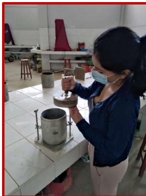
Figura N°65: colocación de sobre cargas anular, circular y la placa perforada con vástago sobre los moldes de CBR
