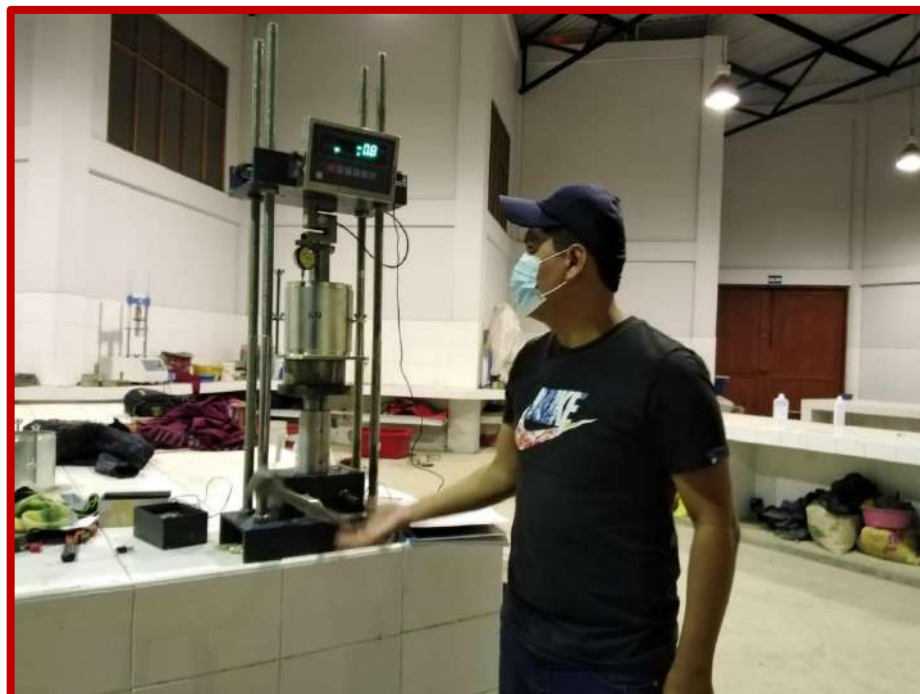
Figura N°68: ensayo de penetración de las muestras en las prensas hidráulicas
