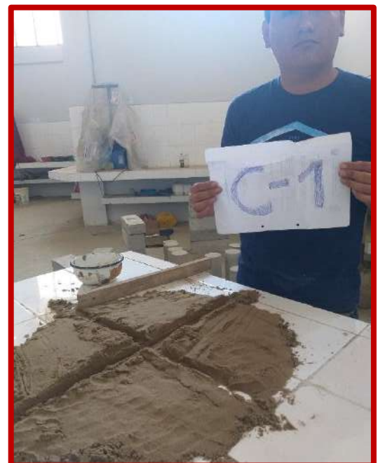
Figura N°13, 14 Y 15: cuarteo de muestra representativa de la calicata N°01
