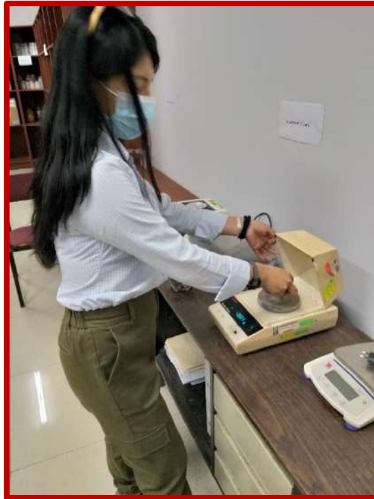
Figura N°69: peso de las muestras de suelo extraídas después del ensayo de penetración para determinar su contenido de humedad.
