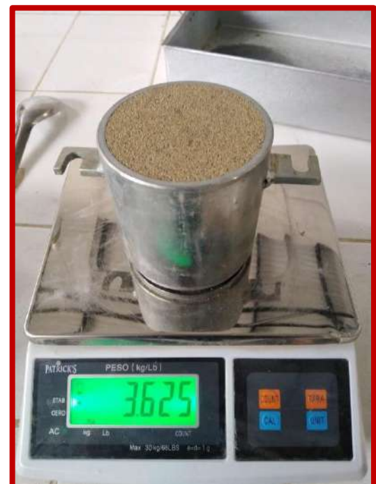
Figura N°55 y 56: preparación de suelo natural de la calicata N°2 con 24% de escoria y peso del molde y material previamente compactado y enrasado.
