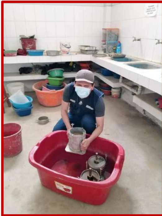
Figura N°66 y 67: colocación de moldes en agua, proceso de saturación.
