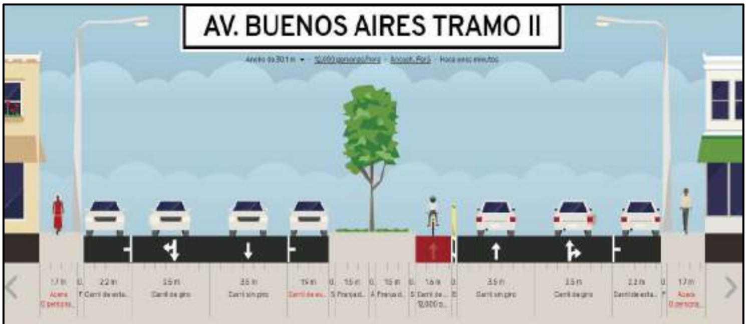
FIGURA 137. Trazado de la red de ciclovia y su perfil longitudinal en la Av. Buenos Aires Tramo II Fuente: Elaboración propia, Google Earth.
