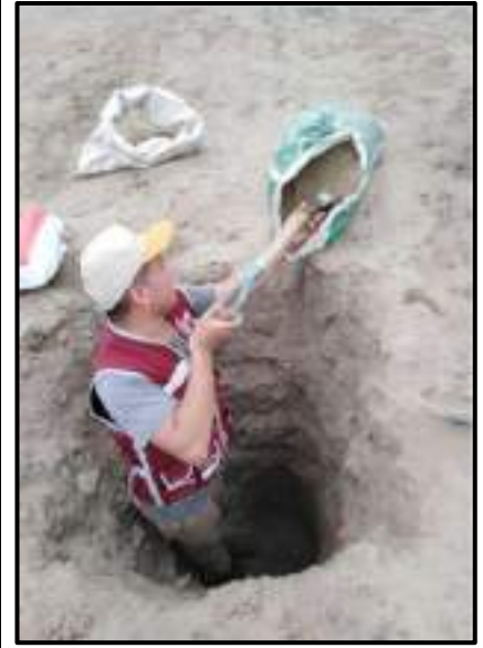
Fotografía N°01-02: Excavación y recojo de muestras de suelo con el muestreador manual y palana de las calicatas en el Ov. San Pedro.
