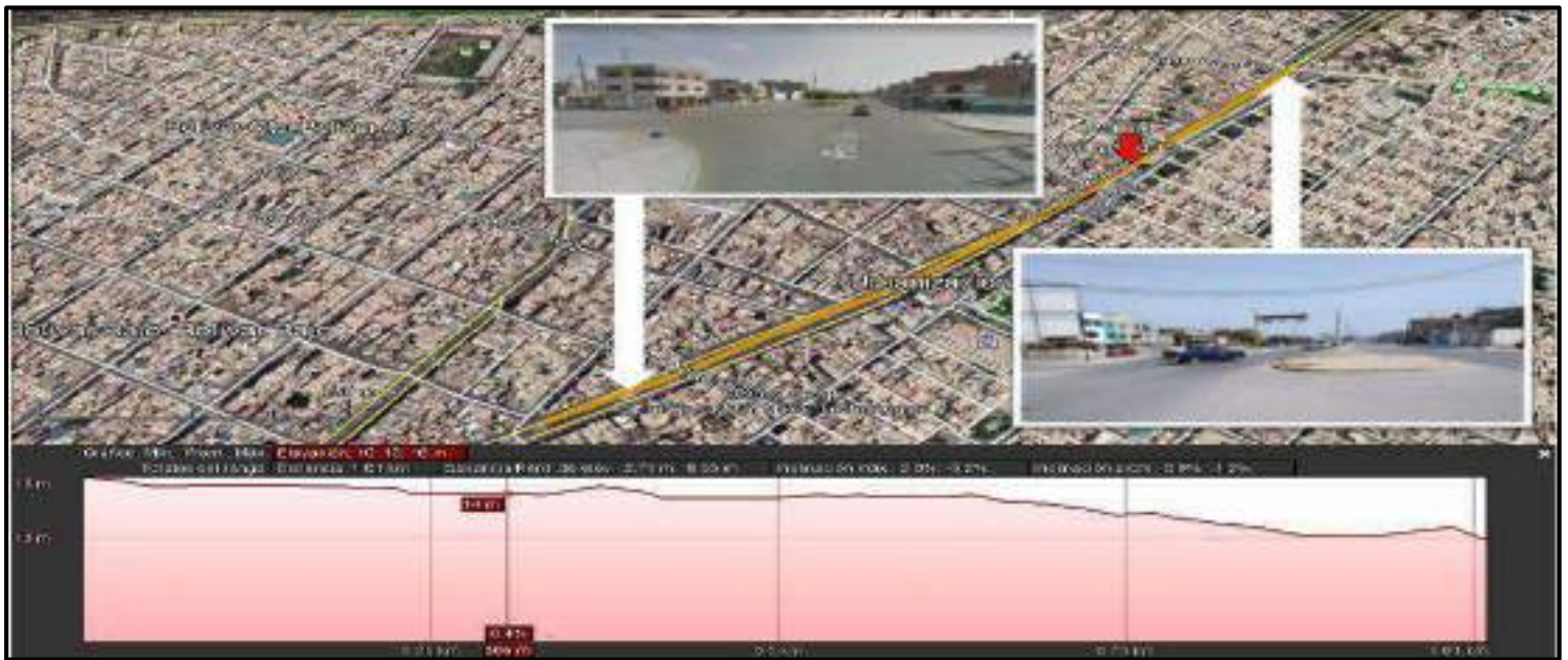
FIGURA 137. Trazado de la red de ciclovia y su perfil longitudinal en la Av. Buenos Aires Tramo II Fuente: Elaboración propia, Google Earth.
