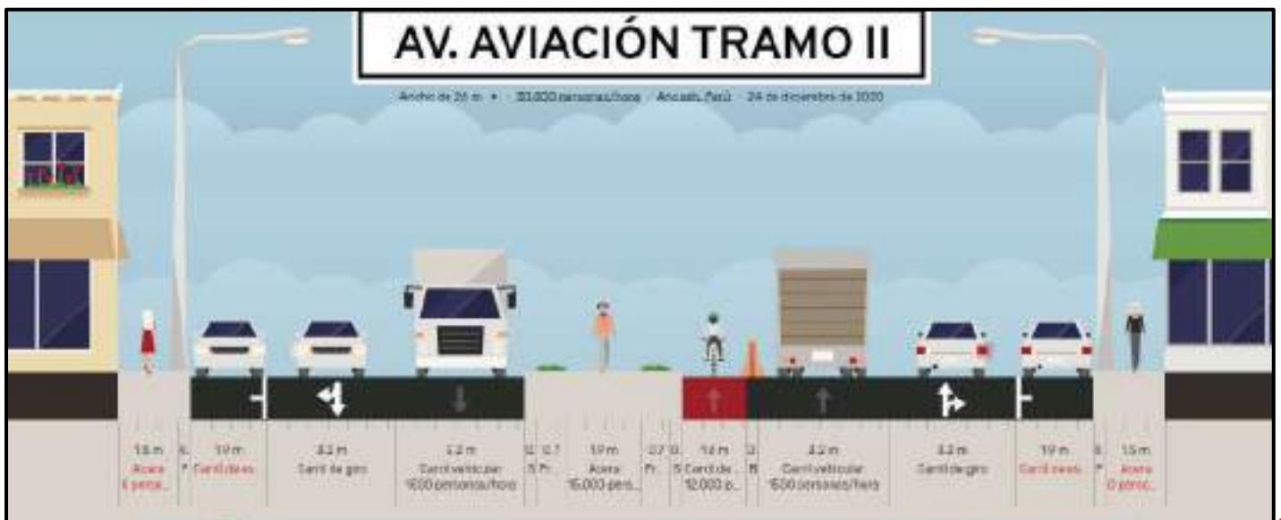
FIGURA 146. Trazado de la red de ciclovia y su perfil longitudinal en la Av. Aviación Tramo II Fuente: Elaboración propia, Google Earth
