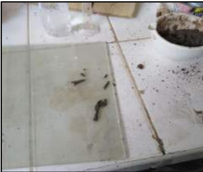
Fotografía N°21-22: Por tratarse de un suelo tipo SP, los demás estratos de las calicatas 01 y 02 extraídas del Ov. San Pedro, no presentan límite plástico.
