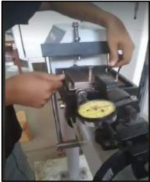
Fotografía N°31-32: Ejecución del ensayo de corte directo en el equipo, durante su proceso se registra las lecturas de deformación normal, para ser representados gráficamente las lecturas de deformación normal contra el tiempo.
