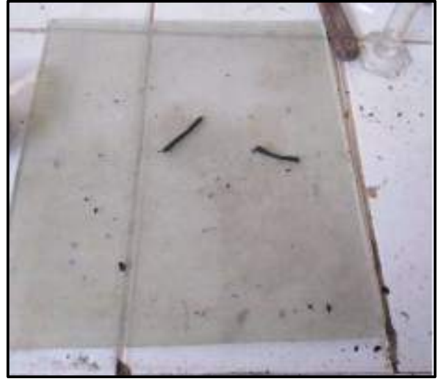
Fotografía N°19-20: Determinación del límite plástico de la calicata 02, estrato 02 del suelo extraído del lugar de estudio.
