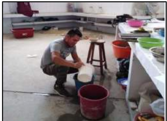
Fotografía N°13-14: Para los estratos que contienen buena cantidad de limos y arcillas, el análisis de la muestra se realizó, previamente realizando un lavado sobre el tamiz N°200 y su posterior secado en el horno.
