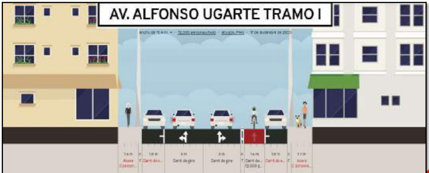
FIGURA 107. Trazado de la red de ciclovia y su perfil longitudinal en la Av. Alfonso Ugarte tramo I Fuente: Elaboración propia, Google Earth
