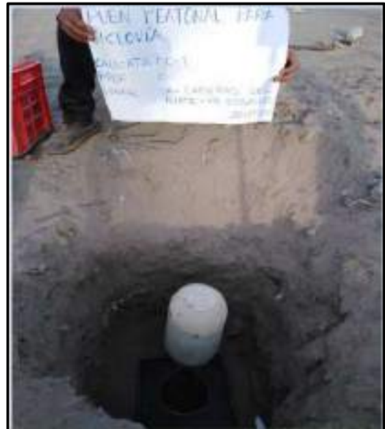
Fotografía N°04: Realización del ensayo de Densidad de Campo en una de las calicatas.
