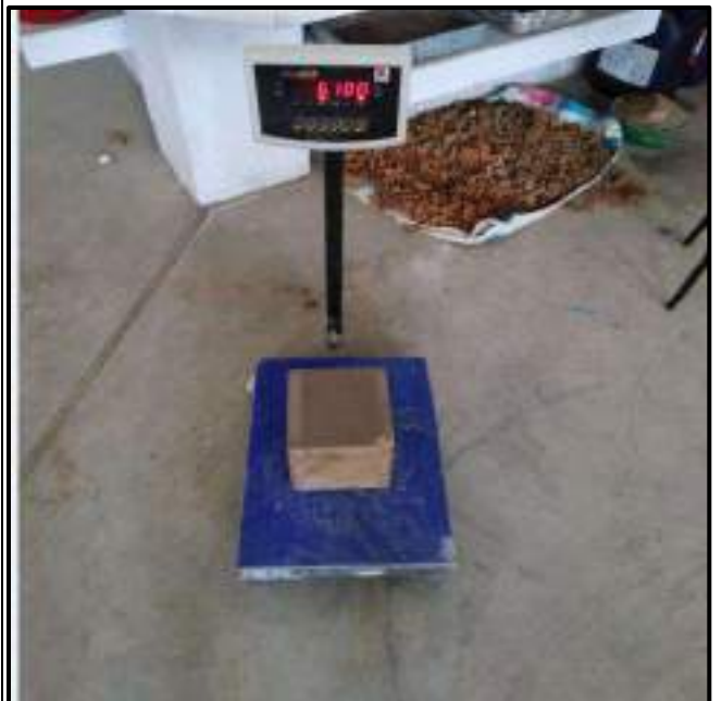
Fotografía N°25-26: Realización del ensayo para la determinación de la densidad mínima en cada uno de los estratos descritos en las imágenes anteriores.
