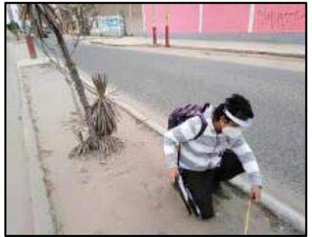
Fotografía N°51-52: Realización de la toma de medidas de cada elemento que forma parte de la sección transversal de la Av. Laderas del Norte, para la posterior configuración, adecuando a la cicloavía en su espacio.
