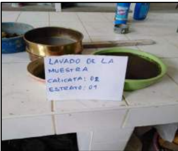
Fotografía N°13-14: Para los estratos que contienen buena cantidad de limos y arcillas, el análisis de la muestra se realizó, previamente realizando un lavado sobre el tamiz N°200 y su posterior secado en el horno.
