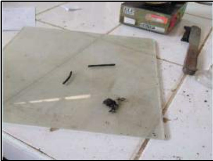
Fotografía N°19-20: Determinación del límite plástico de la calicata 02, estrato 02 del suelo extraído del lugar de estudio.
