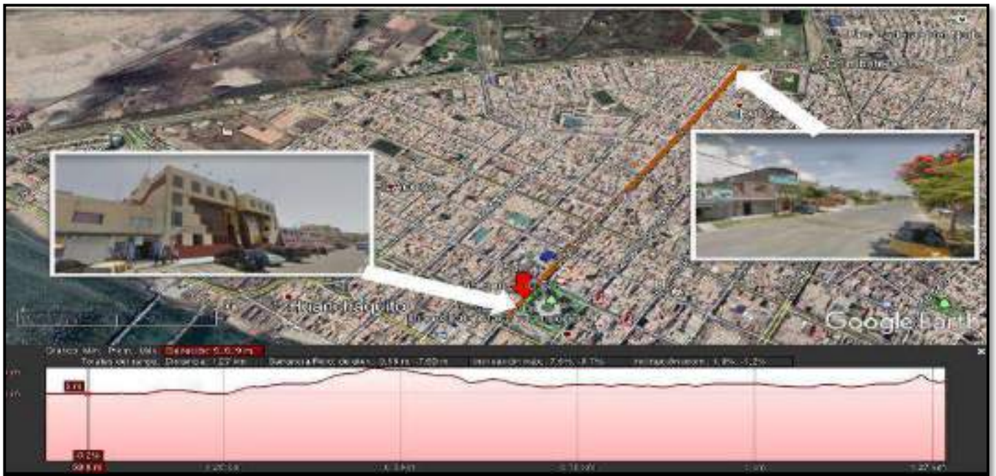
FIGURA 98. Trazado de la red de ciclovia y su perfil longitudinal en el Jr. Enrique Palacios Fuente: Elaboración propia, Google Earth
