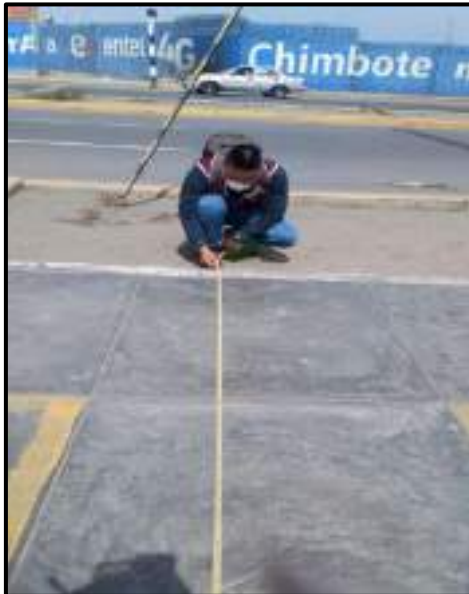
Fotografía N°49-50: Realización de la toma de medidas de cada elemento que forma parte de la sección transversal de la Av. Industrial, para la posterior configuración, adecuando a la ciclovía en su espacio.
