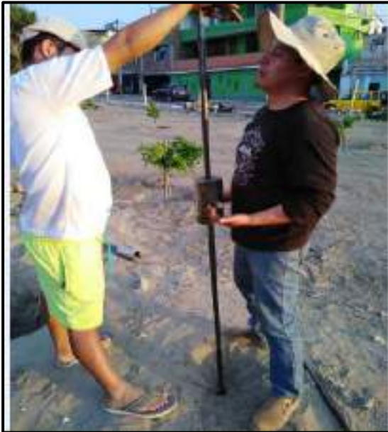
Fotografía N°03: Ensayo de Penetración Dinámica Ligera (DPL), ubicado en el Ov. San Pedro.
