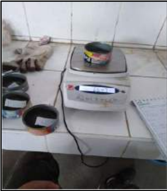
Fotografía N°09-10: Peso de las taras más muestras representativas en la balanza electrónica, antes y después del secado en el horno eléctrico, para la determinación del contenido de humedad de cada estrato.
