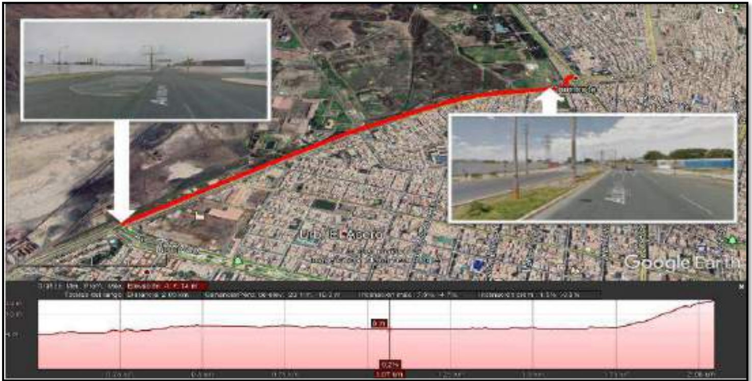
FIGURA 113. Trazado de la red de ciclovia y su perfil longitudinal en la Av. Industrial Fuente: Elaboración propia, Google Earth.
