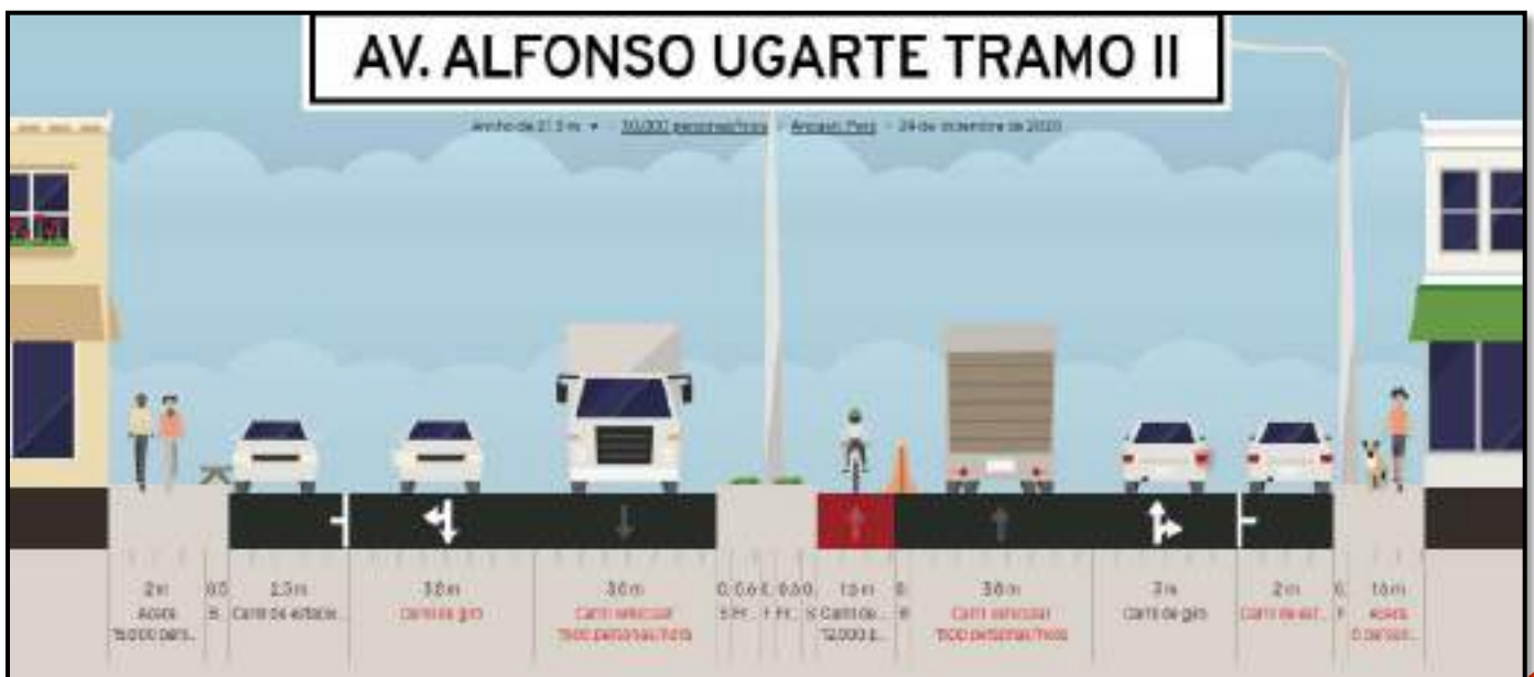
FIGURA 110. Trazado de la red de ciclovia y su perfil longitudinal en la Av. Alfonso Ugarte tramo II Fuente: Elaboración propia, Google Earth
