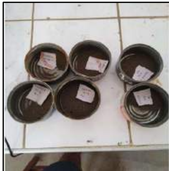
Fotografía N°33-34: Terminado el ensayo en el equipo de corte, se remueve una pequeña muestra de la caja de corte, para la determinación de su humedad.
