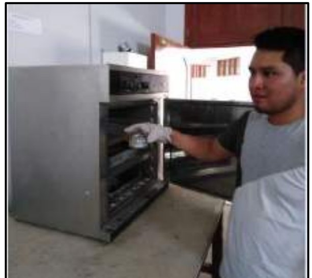
Fotografía N°17-18: Muestras representativas obtenidas del límite líquido para su determinación de contenido de humedad.
