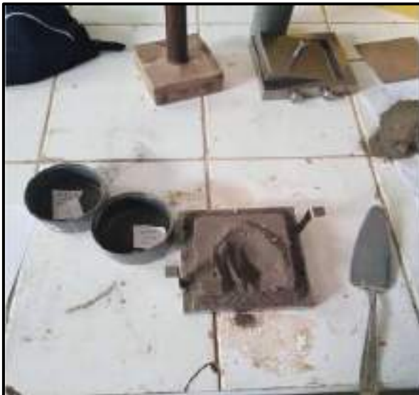
Fotografía N°33-34: Terminado el ensayo en el equipo de corte, se remueve una pequeña muestra de la caja de corte, para la determinación de su humedad.
