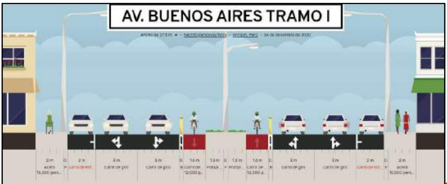
FIGURA 134. Trazado de la red de ciclovia y su perfil longitudinal en la Av. Buenos Aires Tramo I Fuente: Elaboración propia, Google Earth
