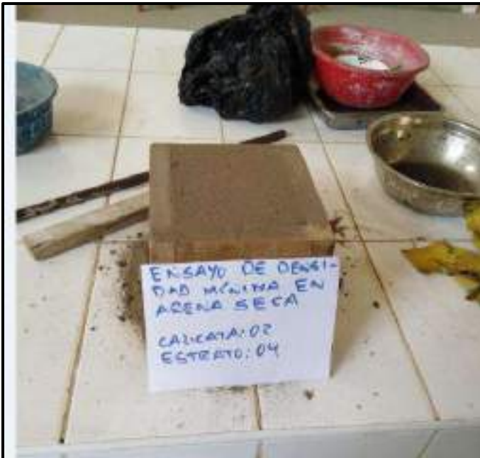
Fotografía N°25-26: Realización del ensayo para la determinación de la densidad mínima en cada uno de los estratos descritos en las imágenes anteriores.
