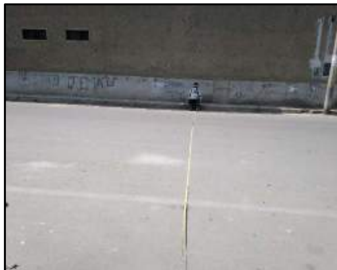
Fotografía N°61-62: Realización de la toma de medidas de cada elemento que forma parte de la sección transversal del Jr. Abancay, para la posterior configuración, adecuando a la ciclovía en su espacio.
