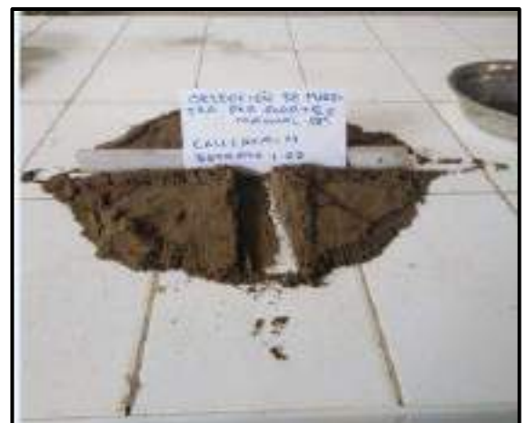
Fotografía N°06-08: Obtención de muestras representativas de cada estrato extraídas de las calicatas, por medio del cuarteo manual, en el laboratorio de la UNS.
