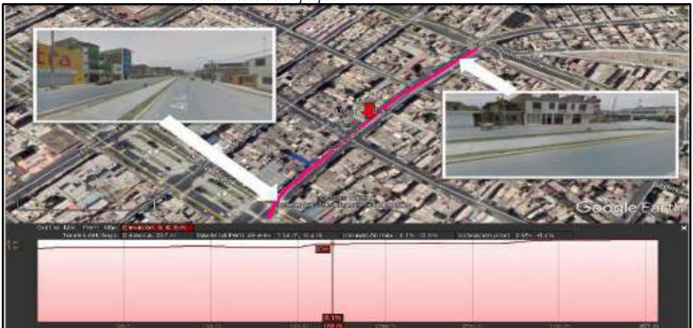
FIGURA 146. Trazado de la red de ciclovia y su perfil longitudinal en la Av. Aviación Tramo II Fuente: Elaboración propia, Google Earth
