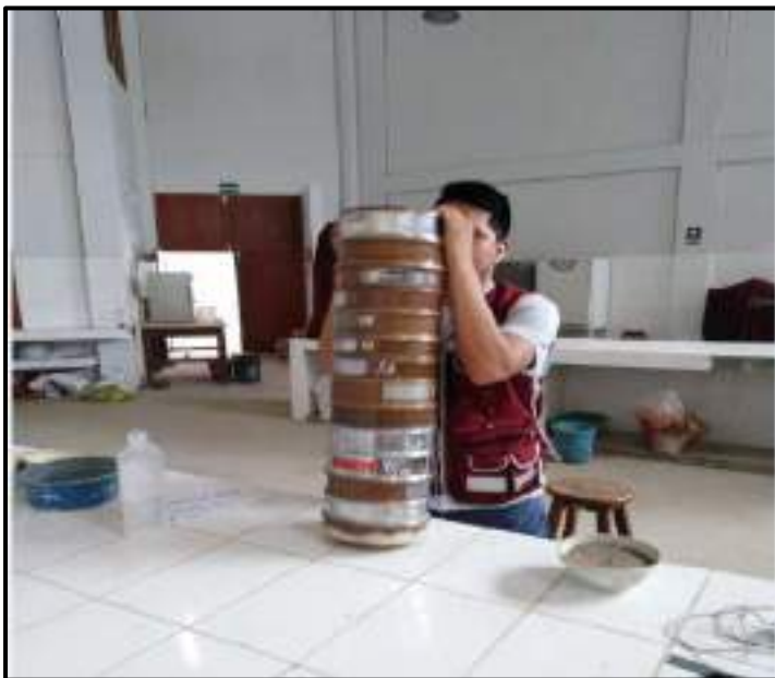
Fotografía N°11-12: Realización del tamizaje manual con cada uno de los tamices descritos en el Manual de Ensayo de Materiales, para la obtención de la curva granulométrica de cada uno de los estratos.
