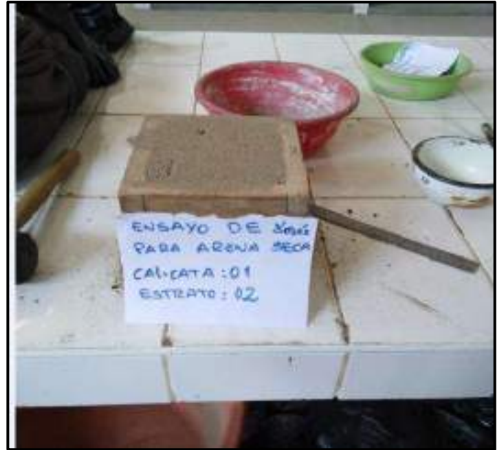
Fotografía N°27-28: Realización del ensayo para la determinación de la densidad máxima en cada uno de los estratos descritos en las imágenes anteriores.
