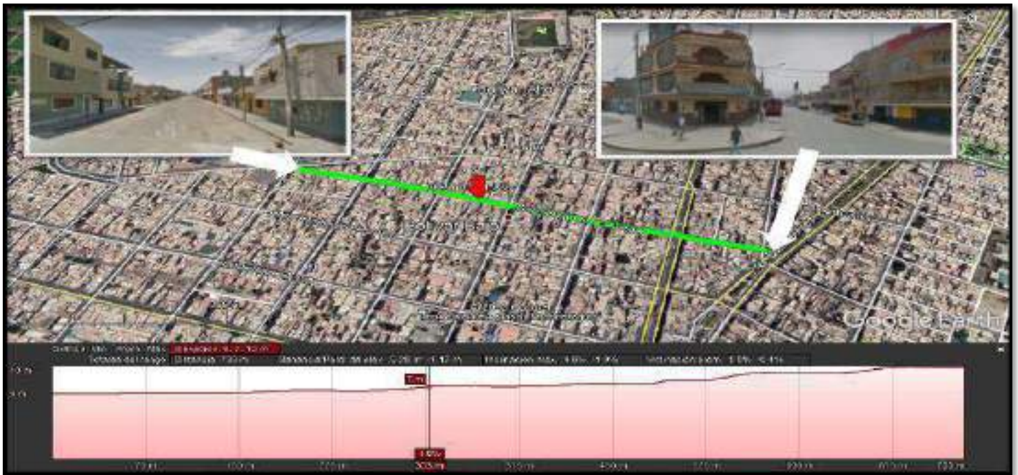
FIGURA 101. Trazado de la red de ciclovia y su perfil longitudinal en el Jr. Garcilazo de la Vega Fuente: Elaboración propia, Google Earth
