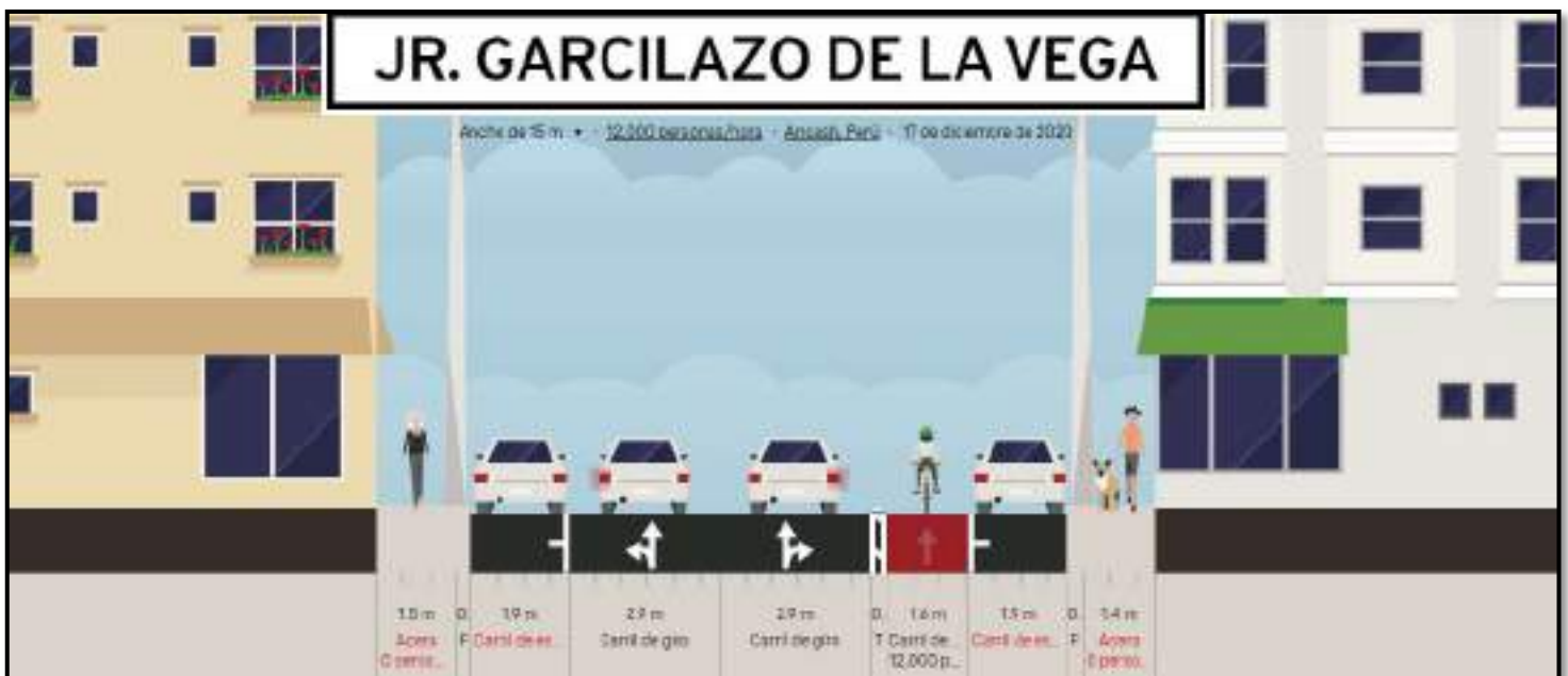
FIGURA 101. Trazado de la red de ciclovia y su perfil longitudinal en el Jr. Garcilazo de la Vega Fuente: Elaboración propia, Google Earth
