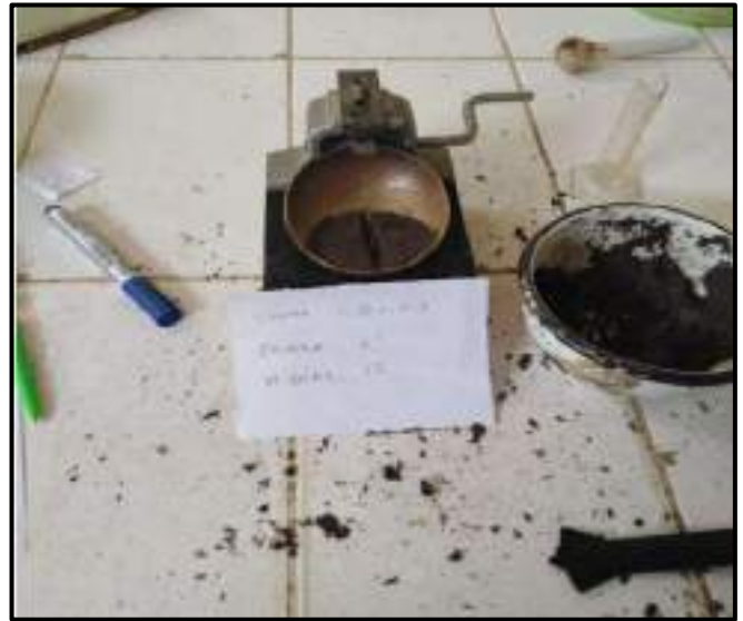
Fotografía N°15-16: Determinación del límite líquido, de acuerdo al (MTC E 110), con lo materiales y equipos necesarios para su realización de la calicata 02, estrato 02, los demás estratos la tratarse de un tipo de suelo SP, no presentan limite líquido.
