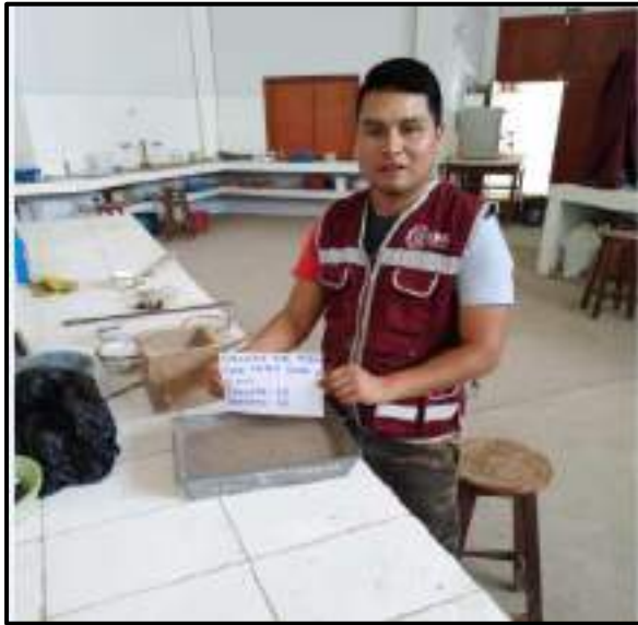
Fotografía N°23-24: Secado de las muestras representativas de los estratos 02 y 03 (C-01) y los estratos 03 y 04 (C-02) para la determinación experimental de las densidades máximas y mínimas.
