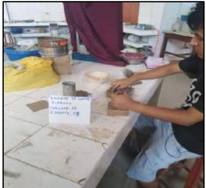
Fotografía N°29-30: Preparación del espécimen de los estratos 02 y 03 (C-01) y los estratos 03 y 04 (C-02), para su posterior ejecución.
