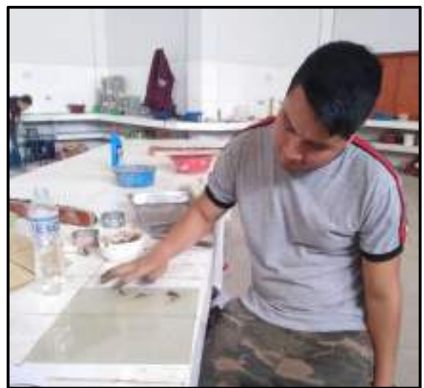
Fotografía N°21-22: Por tratarse de un suelo tipo SP, los demás estratos de las calicatas 01 y 02 extraídas del Ov. San Pedro, no presentan límite plástico.
