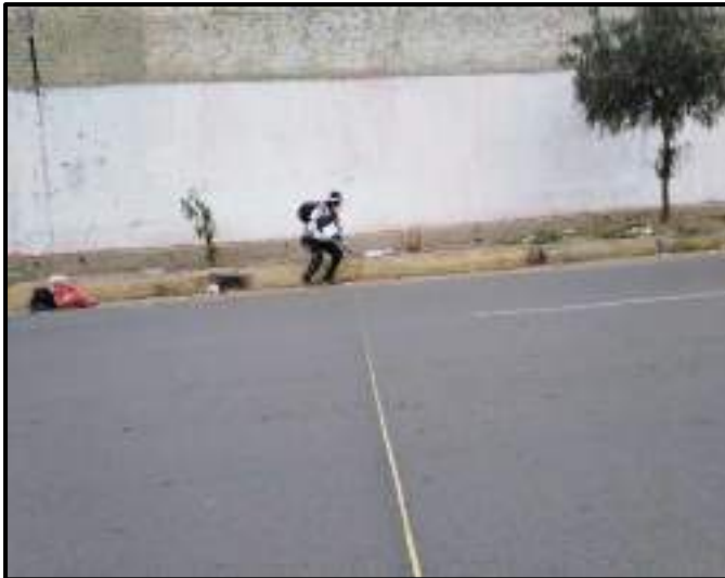
Fotografía N°53-54: Realización de la toma de medidas de cada elemento que forma parte de la sección transversal del Jr. Atahualpa, para la posterior configuración, adecuando a la cicloavía en su espacio.
