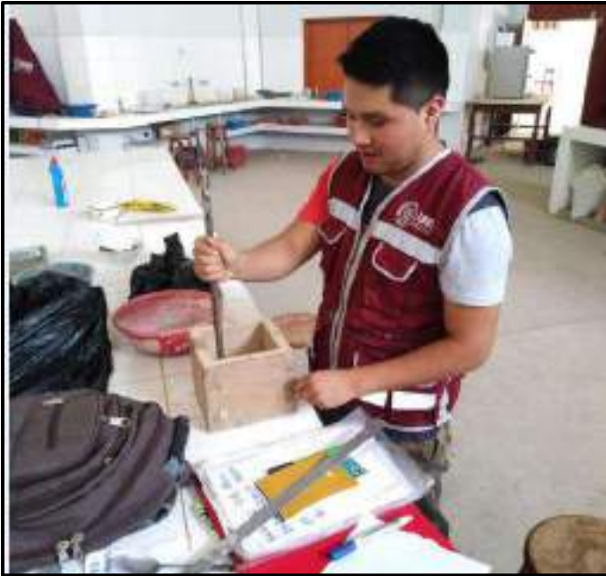
Fotografía N°27-28: Realización del ensayo para la determinación de la densidad máxima en cada uno de los estratos descritos en las imágenes anteriores.
