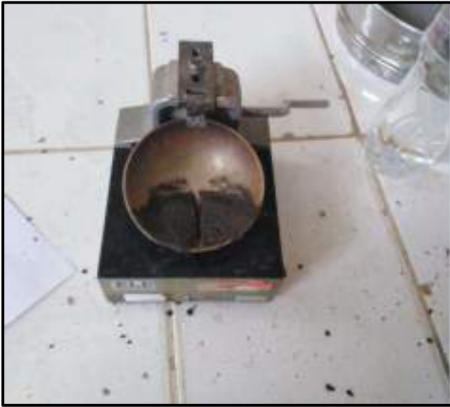
Fotografía N°15-16: Determinación del límite líquido, de acuerdo al (MTC E 110), con lo materiales y equipos necesarios para su realización de la calicata 02, estrato 02, los demás estratos la tratarse de un tipo de suelo SP, no presentan limite líquido.
