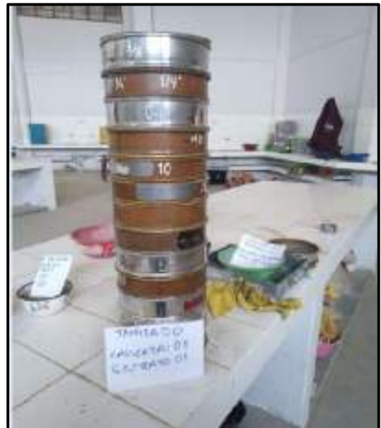
Fotografía N°11-12: Realización del tamizaje manual con cada uno de los tamices descritos en el Manual de Ensayo de Materiales, para la obtención de la curva granulométrica de cada uno de los estratos.
