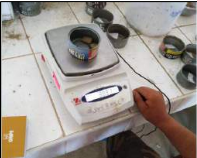
Fotografía N°17-18: Muestras representativas obtenidas del límite líquido para su determinación de contenido de humedad.
