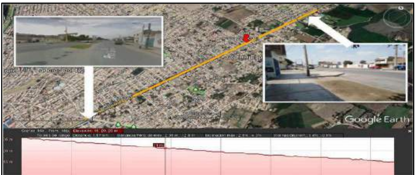
FIGURA 134. Trazado de la red de ciclovia y su perfil longitudinal en la Av. Buenos Aires Tramo I Fuente: Elaboración propia, Google Earth
