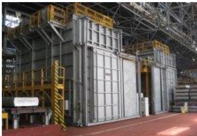
Figura 10 Sistema de precalentamiento de carga en un horno por lotes
