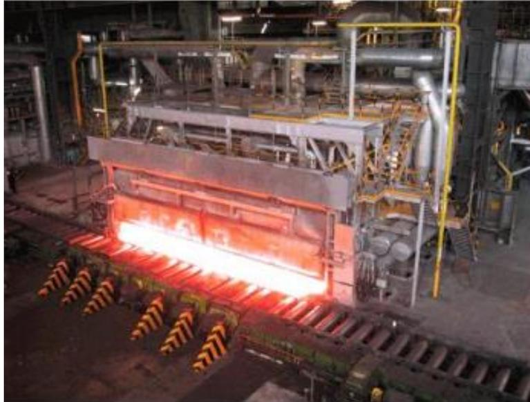
Figura 06 Descarga de palanquillas en horno continuo
