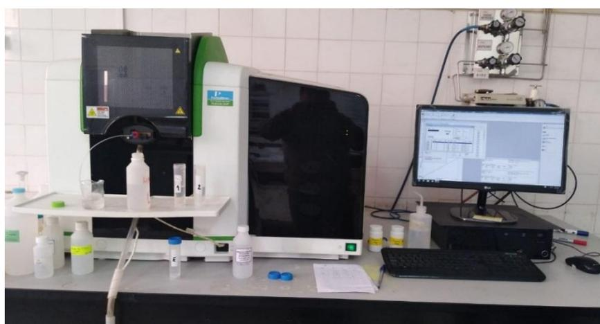
**Figura 20.** *Espectrofotómetro de absorción atómica, Perkin Elmer 900 última generación -LASACI, Universidad Nacional de Trujillo*
