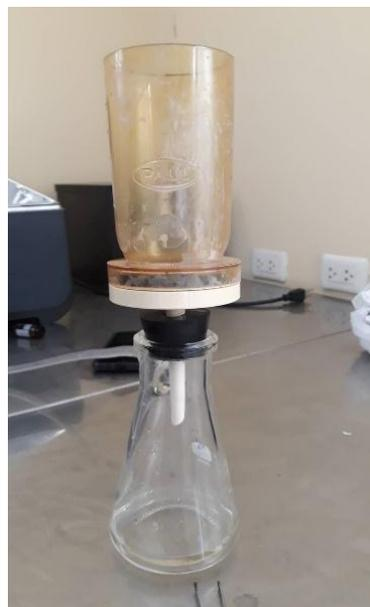
**Figura 18.** *Sistema de filtración al vacío*
