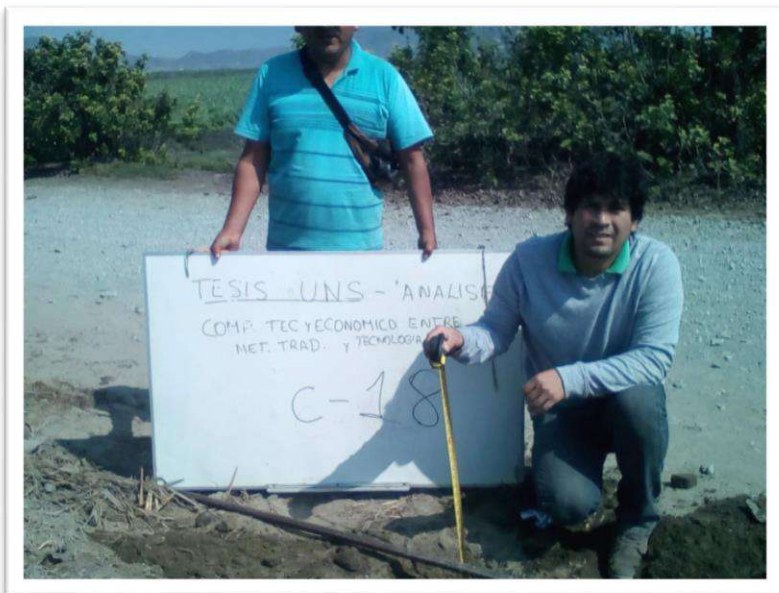
FOTO N° 16: Ubicación de la calicata C-18, presencia de relleno de 0.00 m a 0.15 m., con presencia de gravas y arena de 0.15 m. a 1.65 m.
