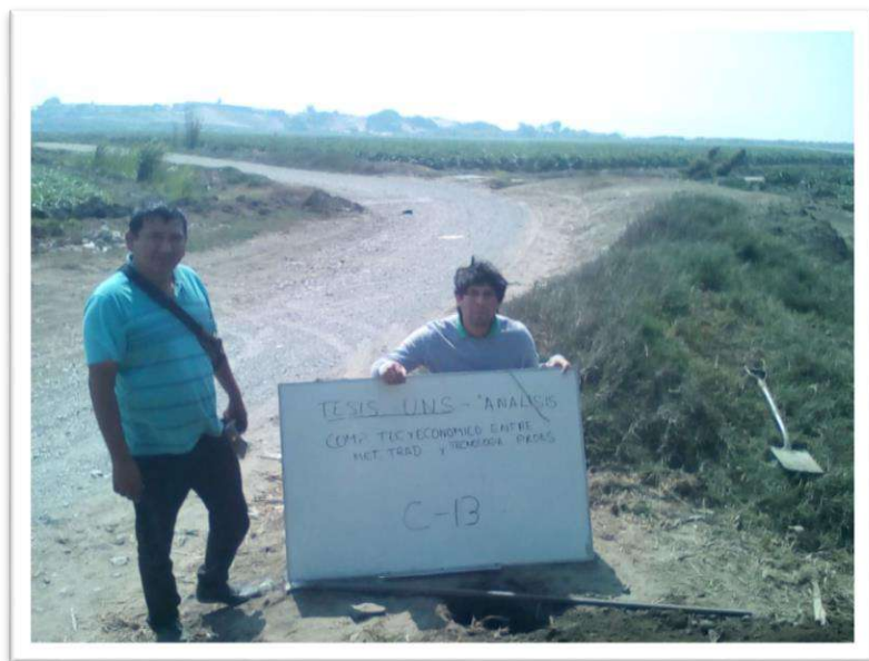
FOTO N° 10: Ubicación de la calicata C-13, El Suelo de 0.00 m. a 0.15 m. conformado generalmente por relleno, con presencia de gravas y arena de 0.15 m. a 1.00 m.
