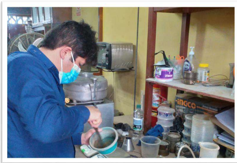
Foto N° 25: Incorporación de agua a la muestra obtenido del tamizado.
