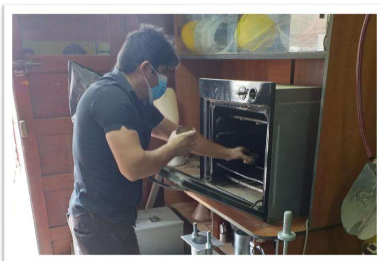
Foto N° 35: Una vez pesadas las muestras se procede al secado para la obtener su contenido de humedad.
