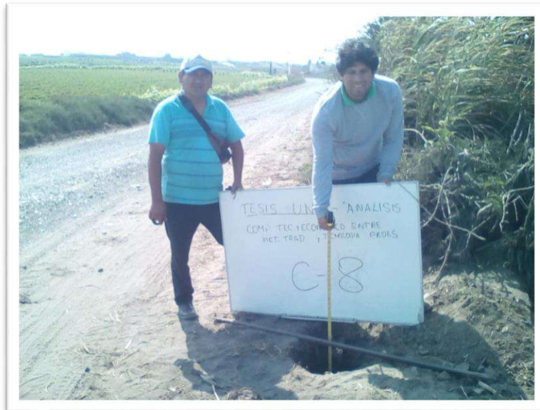
FOTO N° 05: Ubicación de la calicata C-08, El Suelo de 0.00 m a 0.15 m conformado generalmente por relleno, con presencia de gravas y arena de 0.15 m. a 0.75 m., presencia de arcilla y limos de 0.75 m. a 1.60 m.
