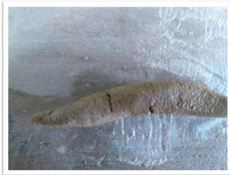
Foto Nº 31: en este caso no presenta límite plástico debido que el bastoncito se vuelve quebradizo mucho antes de llegar a los 3 mm de diámetro requerido.
