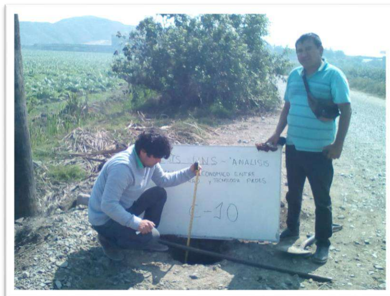
FOTO N° 08: Ubicación de la calicata C-10, El Suelo de 0.00 m a 0.20 m conformado generalmente por relleno, con presencia de gravas y arena de 0.20 m. a 0.60 m., presencia de arcilla y limos de 0.60 m. a 1.65 m.
