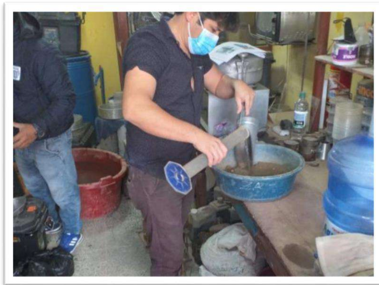
Foto N° 32: Incorporación de diversas cantidades de agua para a la muestra para ensayo de Proctor Modificado.
