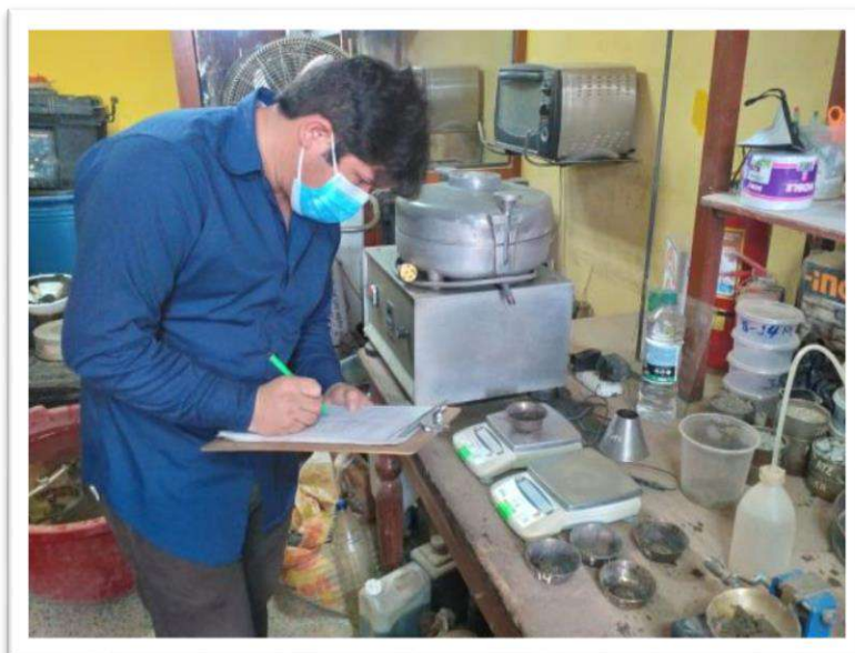
Foto N° 28: Pesado de la muestra obtenida del ensayo y toma de datos.
