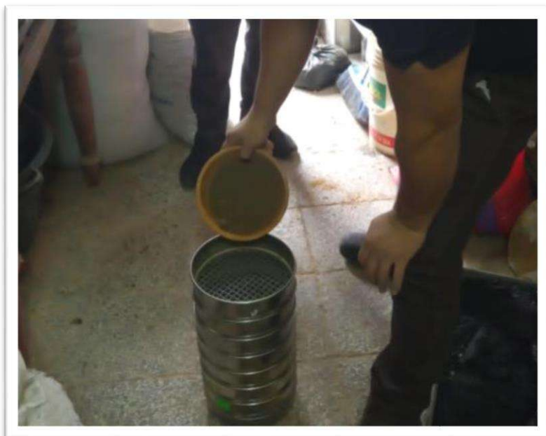
Foto N° 22: tamizaje manual de la muestras extraída de las calicatas.
