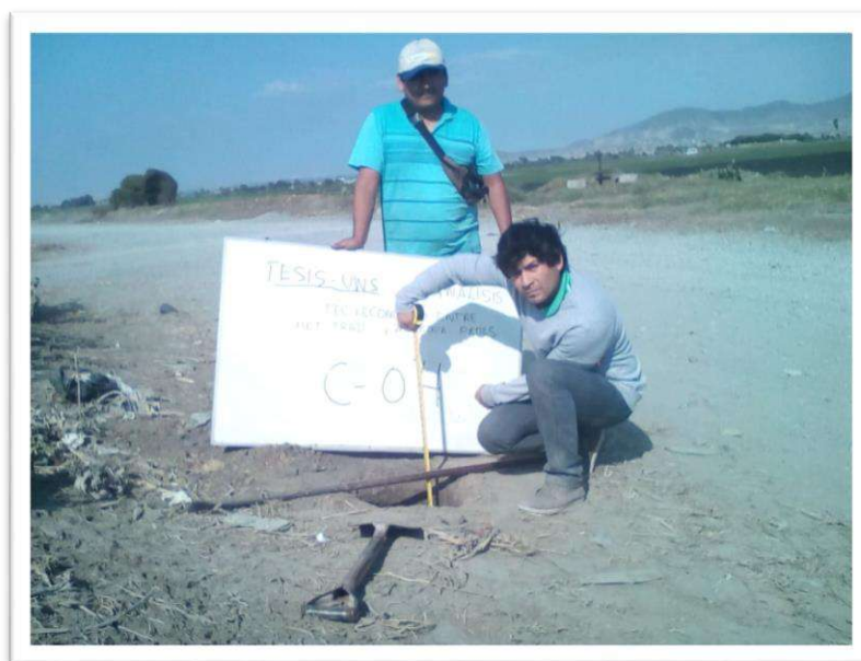
FOTO N° 03: Ubicación de la calicata C-04, El Suelo de 0.0 m a 0.20 m conformado generalmente por relleno, con presencia de gravas y arena de 0.20 m. a 1.30 m., presencia de arcilla y limos de 1.30 m. a 1.65 m.
