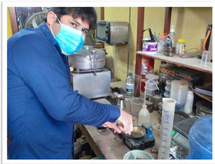
Foto N° 26: colocación de la muestra en forma homogénea y horizontal en la copa casa grande
