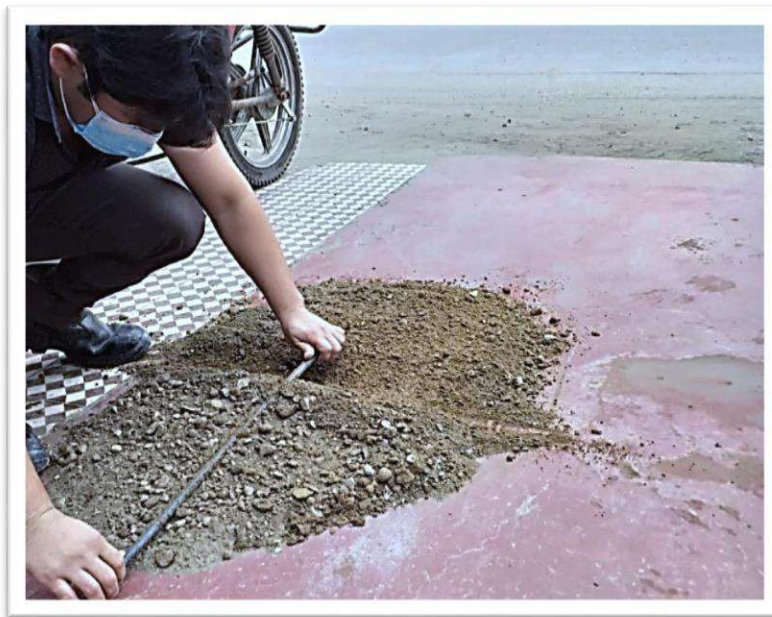
Foto N° 20: Obtención de una muestra representativa mediante cuarteo..
