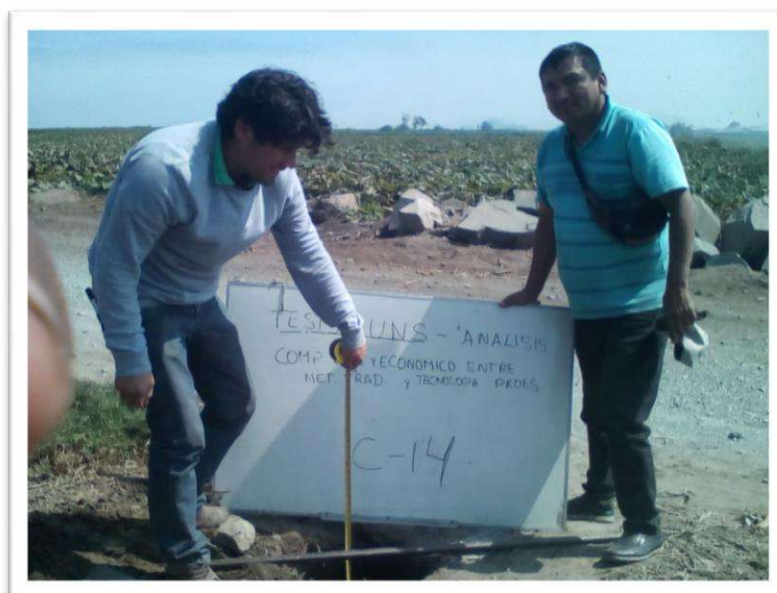
FOTO N° 12: Ubicación de la calicata C-14, El Suelo de 0.0 m. a 0.25 m. conformado generalmente por relleno, presencia de arcilla y limos de 0.25 m. a 1.60 m.
