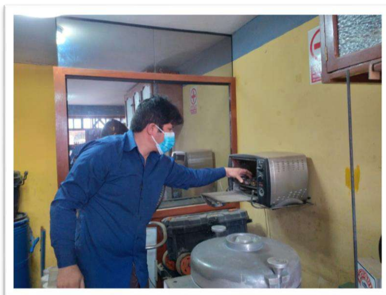
Foto N° 29: Secado de la muestra para poder obtener el contenido de humedad.
