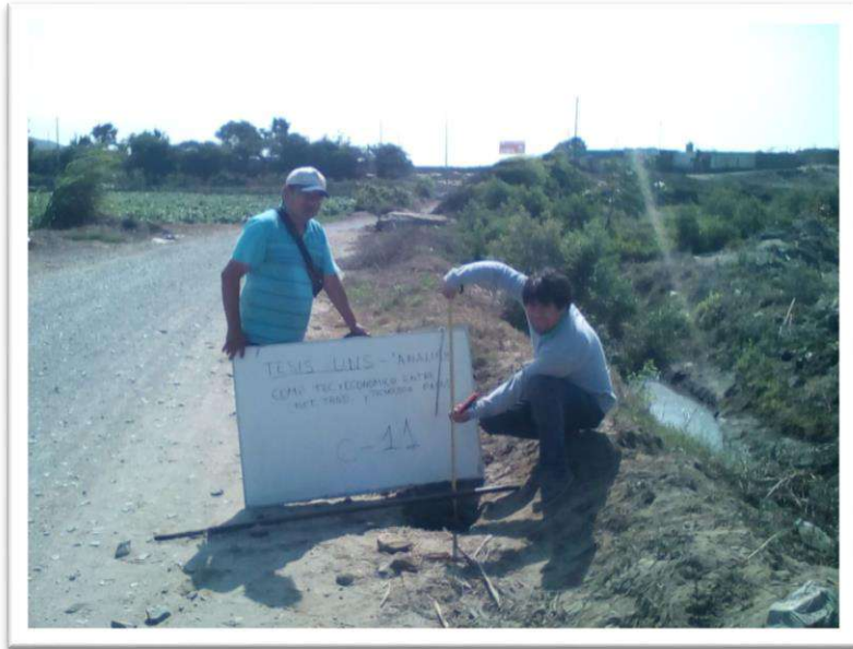
FOTO N° 09 Ubicación de la calicata C-11, El Suelo de 0.00 m. a 0.50 m conformado generalmente por relleno, limo y arcillas con material orgánico de 0.50 m. a 1.00 m., con presencia de gravas y arena de 1.00 m. a 1.50 m., presencia de arcilla y limos de 1.50 m. a 1.75 m.
