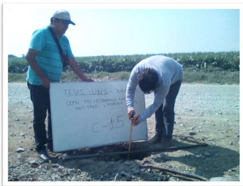
FOTO N° 13: Ubicación de la calicata C-15, El Suelo de 0.0 m. a 0.50 m. conformado generalmente por relleno, con presencia de gravas y arena de 1.00 m. a 1.70 m.
