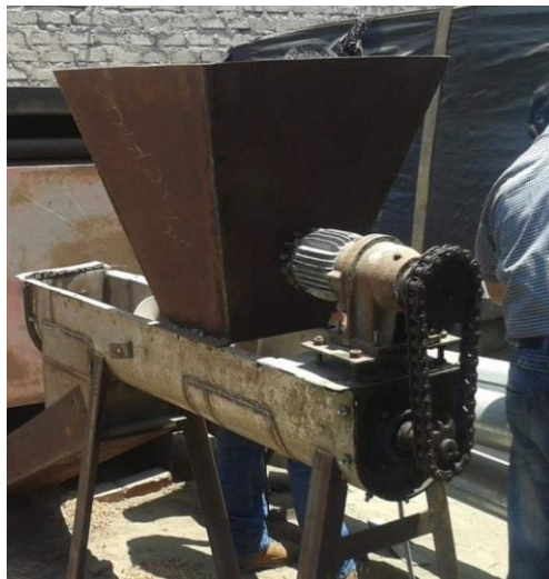
Figura 20 Diseño final de tolvin de alimentación de aserrín
