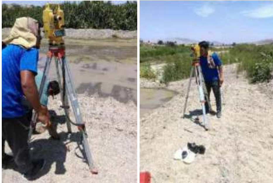
Figura 77 y Figura 78: Se procedió a ubicar lugares estratégicos que servirían para realizar el levantamiento topográfico. Primero se procedió a ubicar BM's que servirían para los cambios de estación, posteriormente se niveló el teodolito electrónico y se ingresaron los datos del GPS para la georreferenciación.
