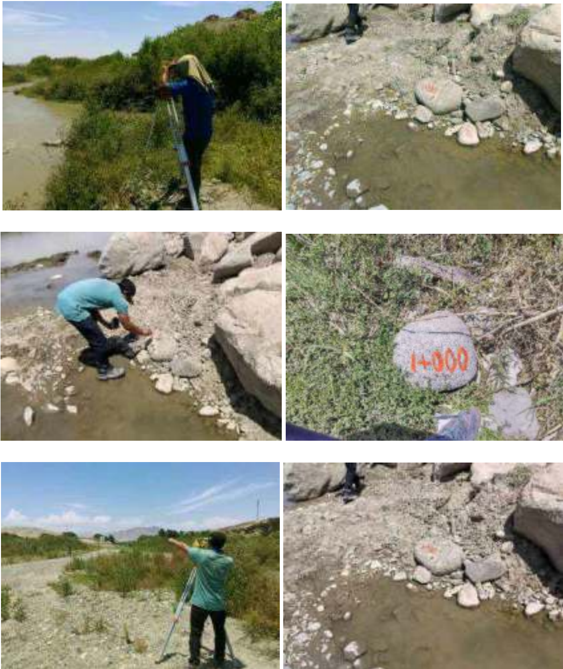
Figura 81, Figura 82, Figura 83, Figura 84, Figura 85 y Figura 86: Durante los cambios de estación se siguieron marcando las progresivas en el río cada 500m.
