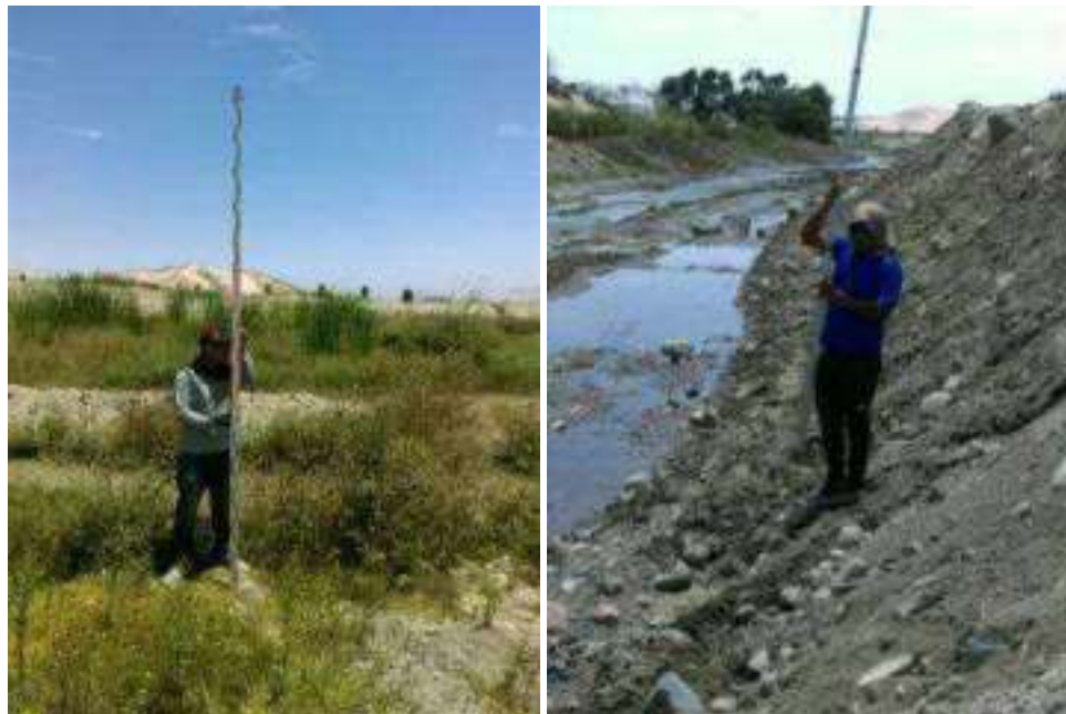
Figura 79 y Figura 80: Para los trabajos de levantamiento se necesitó personal de ayuda y así poder mejorar el avance diario, tomando lecturas cada 50m, a lo largo del tramo de estudio.
