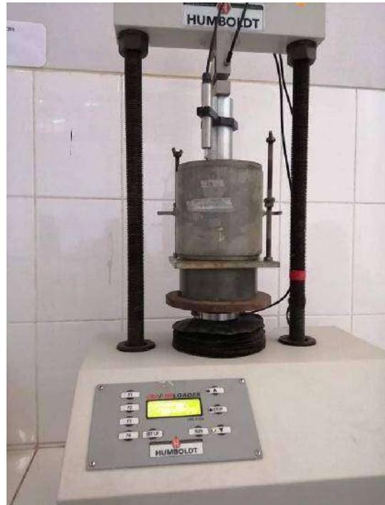
**FOTO N° 09 Y 10:** Ensayo de California Bearing Ratio (CBR), en el laboratorio de la Universidad Nacional del Santa.
