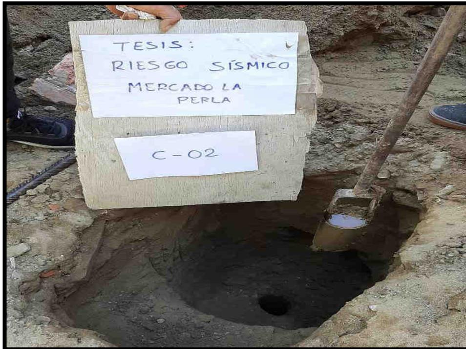
**FIGURA N° 07:** Excavación del suelo de la calicata C-02 en el mercado la Perla de Chimbote
