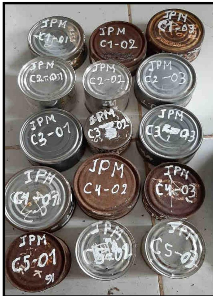
FIGURA N° 23,24: Preparando el material obtenido en campo para sacar contenido de humedad, para el tamizado.
