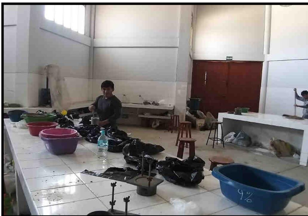
**FIGURA N° 21,22:** Preparando el material obtenido en campo para sacar contenido de humedad, para el tamizado.
