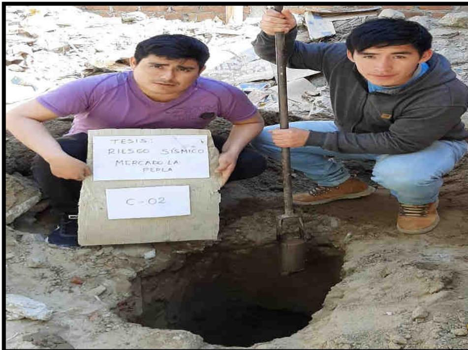
**FIGURA N° 05:** Excavación y toma de muestra del suelo de la calicata C-02 en el mercado la Perla de Chimbote
