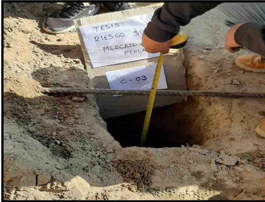
**FIGURA N° 11:** Verificando altura de la calicata C-03 en el mercado la Perla de Chimbote
