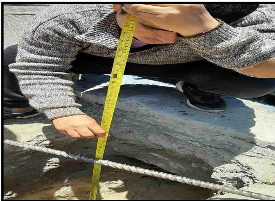
**FIGURA N° 02:** Verificando altura de la calicata C-01 en el mercado la Perla de Chimbote
