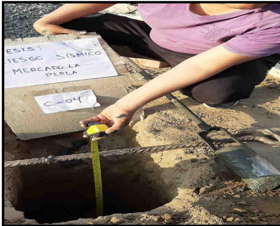
**FIGURA N° 15:** Verificando altura de la calicata C-04 en el mercado la Perla de Chimbote
