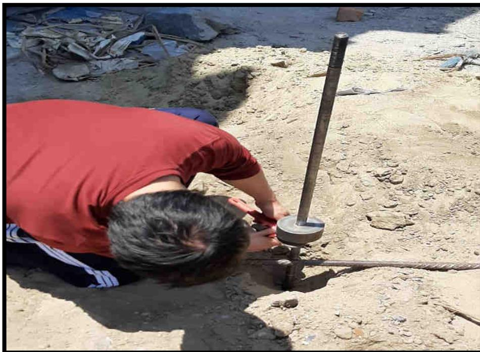
**FIGURA N° 04:** Ensayo de DPL al costado de la calicata C-01 en el mercado la Perla de Chimbote
