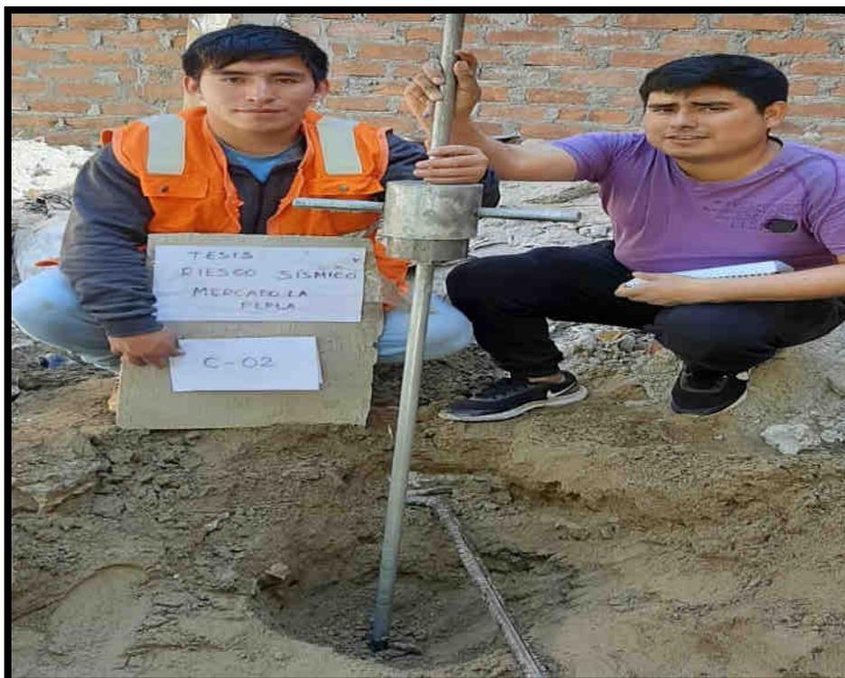
**FIGURA N° 08:** Ensayo de DPL al costado de la calicata C-02 en el mercado la Perla de Chimbote
