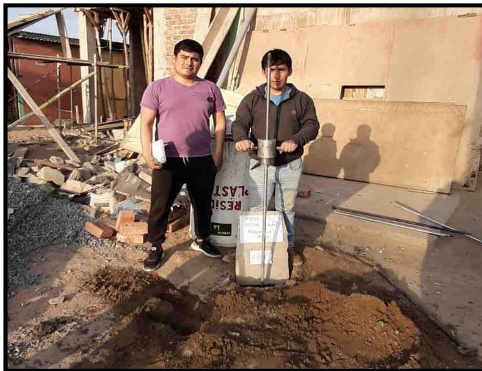
**FIGURA N° 16:** Ensayo de DPL al costado de la calicata C-04 en el mercado la Perla de Chimbote
