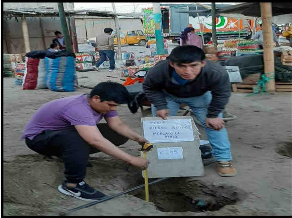
**FIGURA N° 19:** Verificando altura de la calicata C-04 en el mercado la Perla de Chimbote
