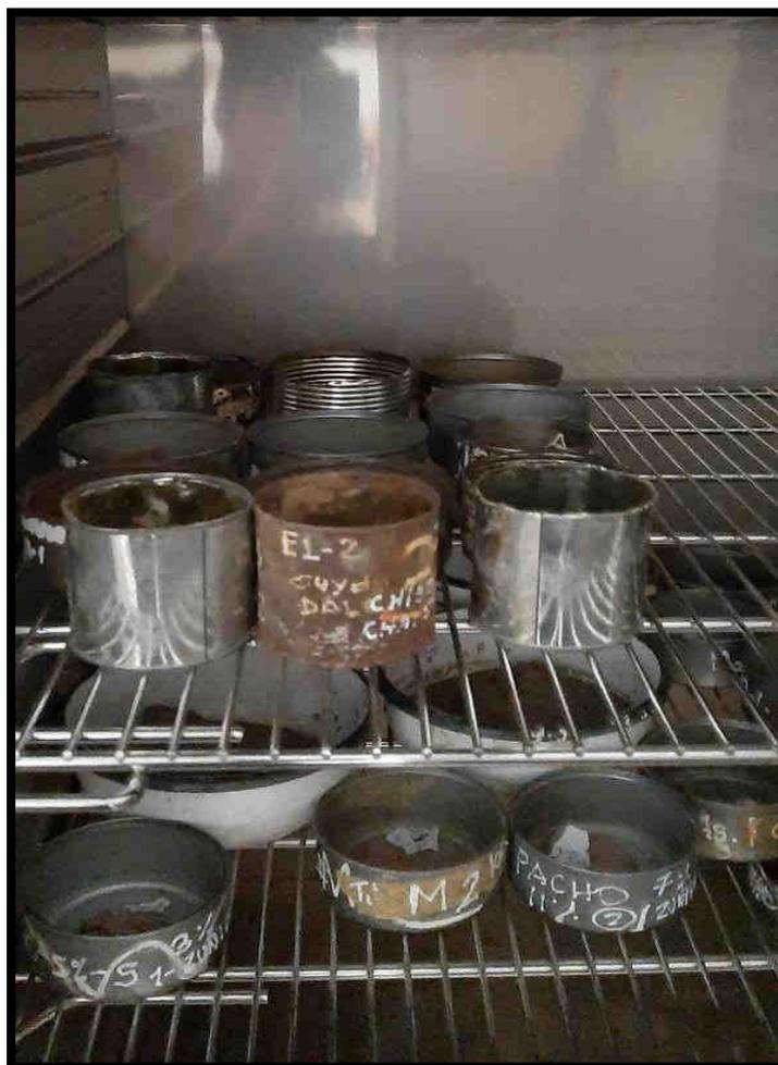
**FIGURA N° 25:** Colocando las taras al horno 24 horas, para obtener el contenido de humedad.
