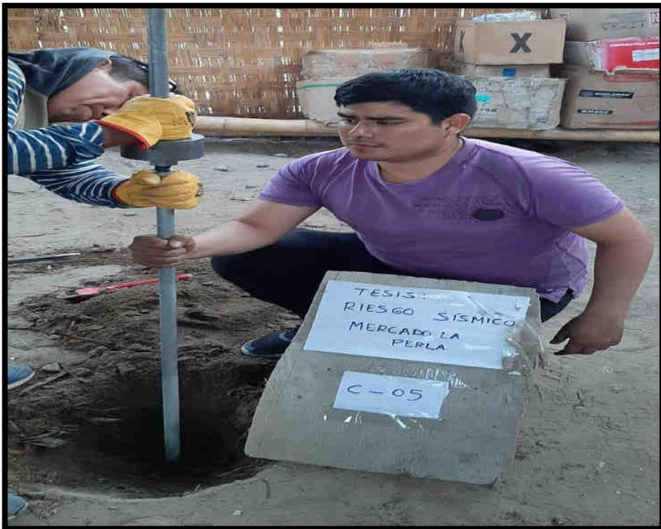
**FIGURA N° 20:** Ensayo de DPL al costado de la calicata C-04 en el mercado la Perla de Chimbote
