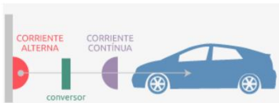
Figura 14. Conexión del vehículo a la red modo 4 Fuente: (Endesa, 2014)
