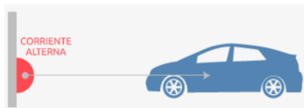
Figura 11. Conexión del vehículo a la red modo 1.
