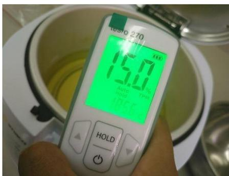
**Figura 7:** Medición del % compuestos polares
