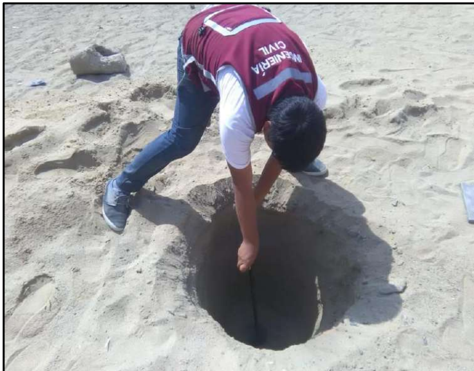
Fotografía N°05 y 06: Se observa el uso del barreno para extraer las muestras de cada calicata.
