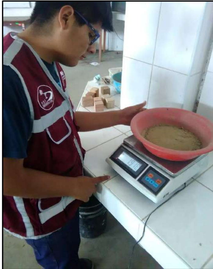
Fotografía N°10: Se registraron el peso del material retenido en cada tamiz, incluido el de la cazoleta del fondo.
