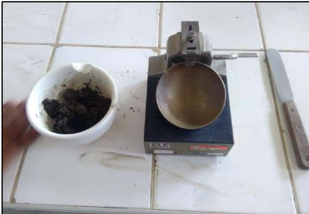
Fotografía N°11: Materiales utilizados en la determinación del Límite Líquido de las muestras extraídas de las calicatas.
