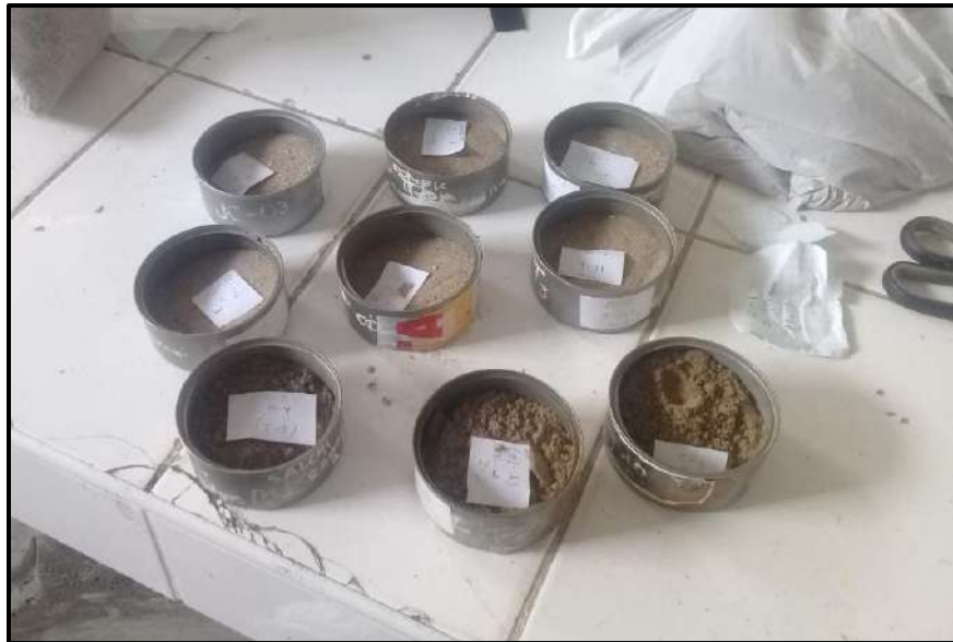
Fotografía N°04: Muestras representativas colocadas sobre taras, los cuales se registraron sus pesos para la determinación del contenido de humedad de las muestras extraídas en las calicatas.
