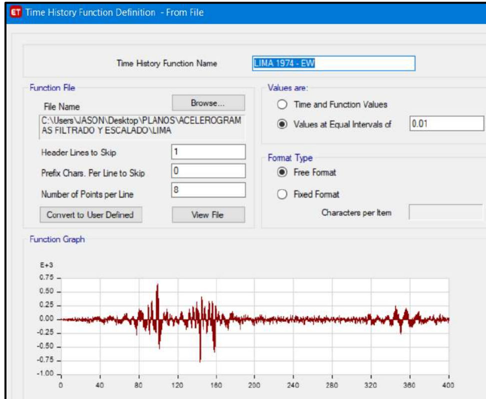
Figura 223: Ingreso en Etabs de acelerograma filtrado y escalado, del Sismo de Lima de 1974 (E-W)
