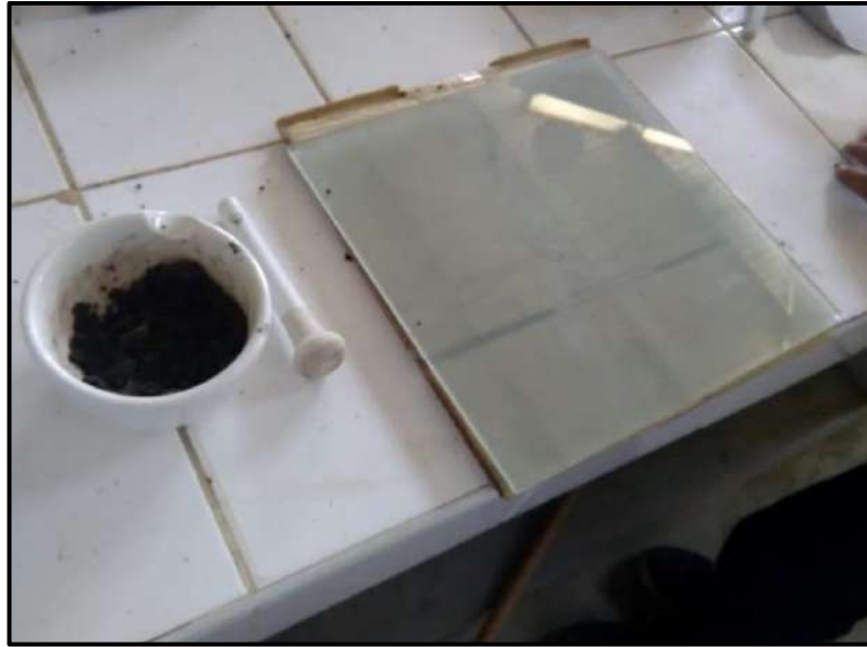
Fotografía N°14: Materiales utilizados en la determinación del Límite Plástico de las muestras extraídas de las calicatas.
