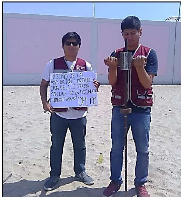
Fotografía N°13 y 14: Se aprecia el Ensayo de Penetración Dinámica Ligera “DPL” ubicados en el plano de DPL (G-01).
