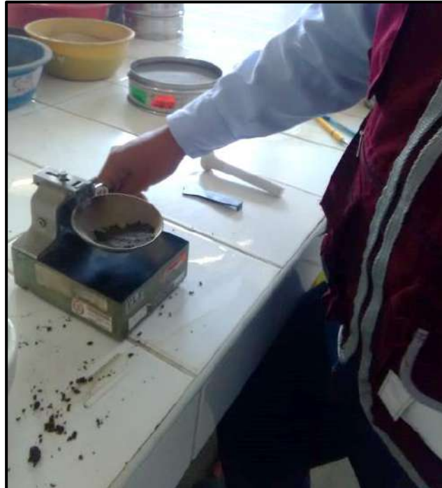
Fotografía N°13: Se procedió a girar la manivela con el material preparado, contando el número de golpes necesarios para obtener una unión de las dos mitades del material, posteriormente se obtuvo el contenido de humedad de cada material preparado con su número de golpes respectivo.
