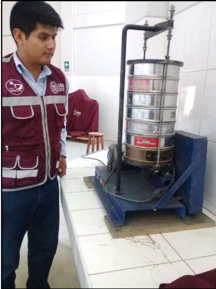
Fotografía N°08: Se colocó en el juego de tamices, la muestra que fue pesada, posteriormente se utilizó la tamizadora mecánica para el zarandeo de tamices.
