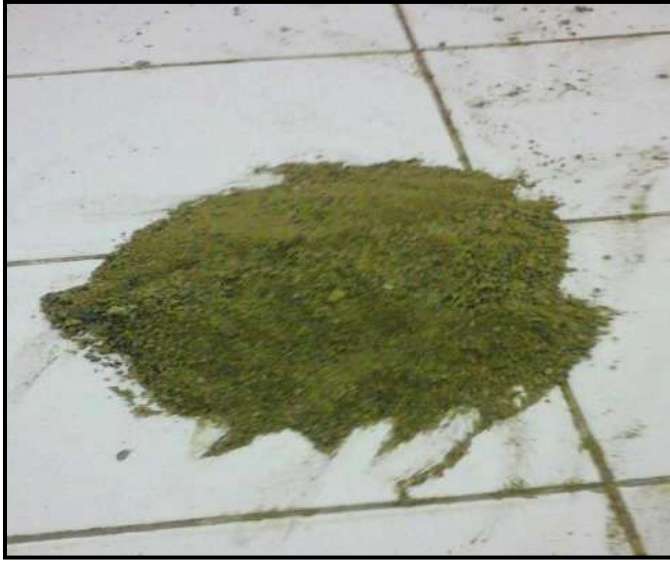
Fotografía N°03: Finalmente se obtuvo las muestras representativas de las 6 calicatas, las cuales se usó en los ensayos de contenido de humedad, granulometría de suelos, límite líquido y límite plástico.
