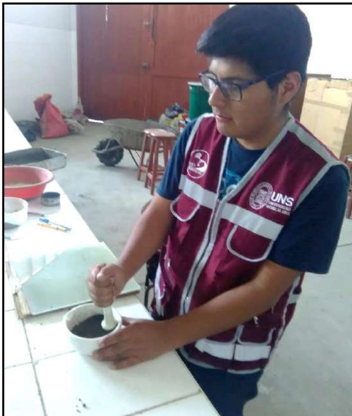
Fotografía N°15: De las muestras extraídas se pasaron por el tamiz N°40 y combinadas con agua destilada se prepararon en un mortero.
