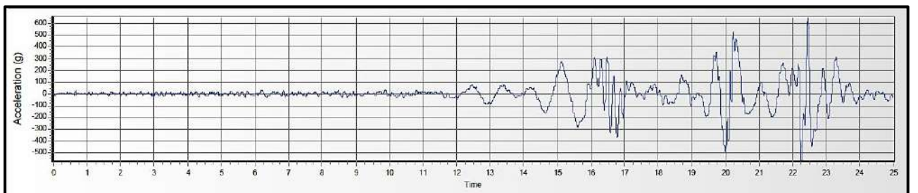
Figura 178: Acelerograma filtrado y escalado del Sismo de Moyobamba del 2005 (N-S) Fuente: Elaboración propia, SEISMO MATCH, 2019
