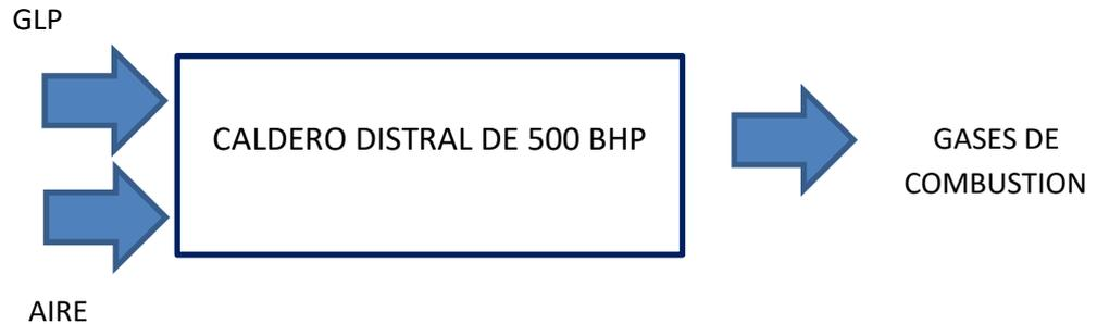
Figura N°18 Balance de masas en caldero distral de 500 BHP
