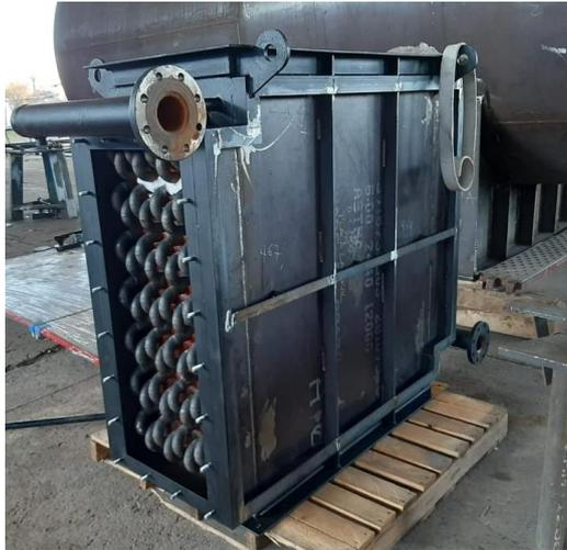
Figura N° 22 Recuperador de calor a instalar en Caldero N° 1
