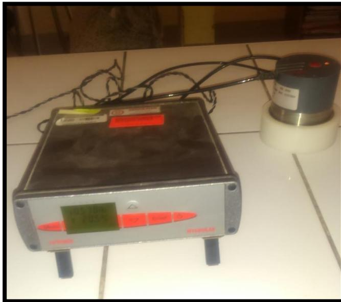
**Ilustración 2.** Equipo analizador de actividad de agua
