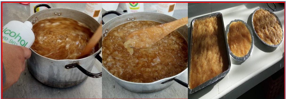
FOTO 6. Precipitación de la pectina de la cascara de maracuyá, pectina después del filtrado.
