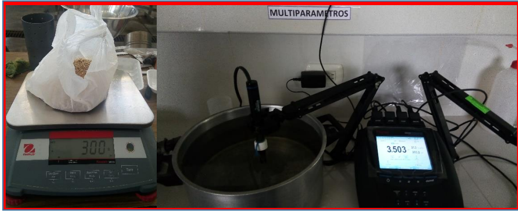
FOTO 4. Preparación de la solución para la hidrólisis. Pesado de la cascara y acidulado del agua.
