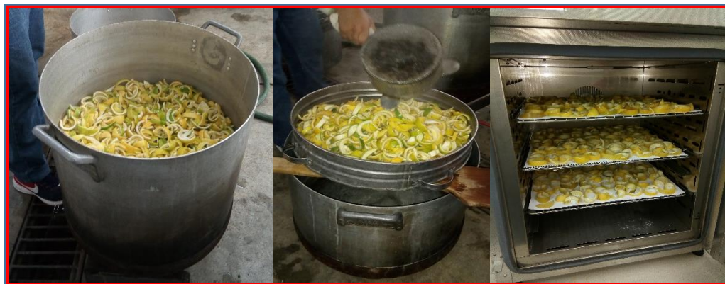
FOTO 2. Escaldado, filtrado y secado de la cascara de maracuyá.
