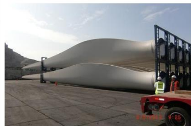
Palas de Torres de 48 m de longitud
