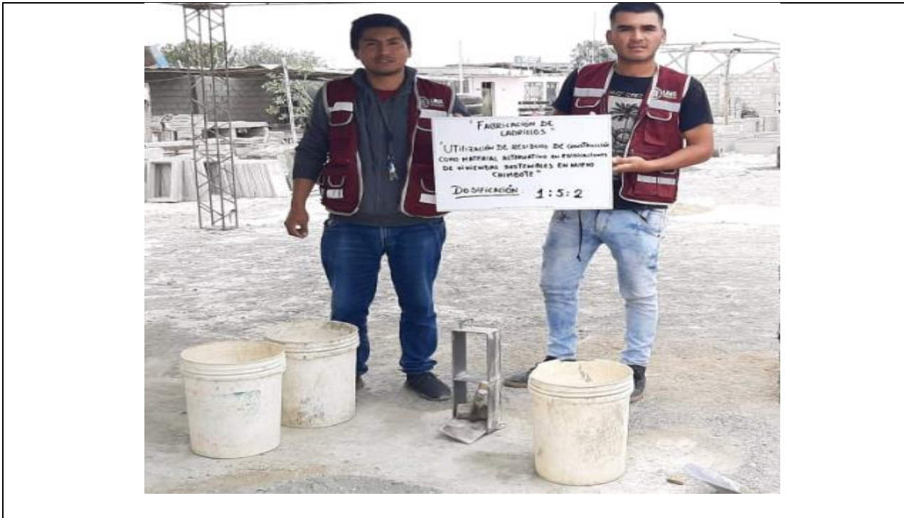
FOTOGRAFÍA N° 16 Elaboración de ladrillos con agregados reciclados - Dosificación 1:5:2
