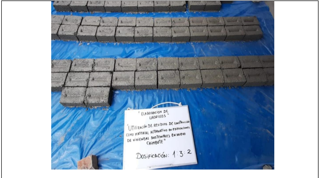
FOTOGRAFÍA N° 17 Elaboración de ladrillos con agregados reciclados - Dosificación 1:3:2
