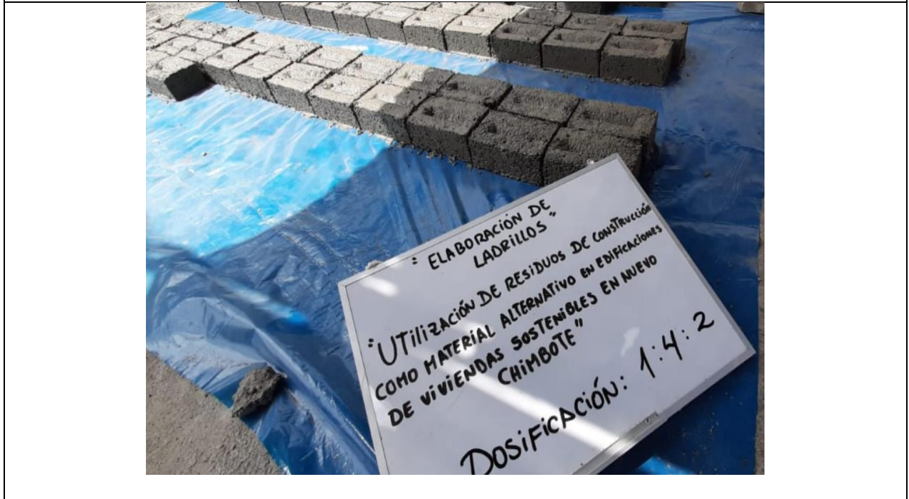
FOTOGRAFÍA N° 18 Elaboración de ladrillos con agregados reciclados - Dosificación 1:4:2
