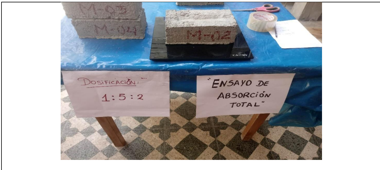
FOTOGRAFÍA N° 22 Ensayo de Absorción de los Ladrillos con material reciclado.
