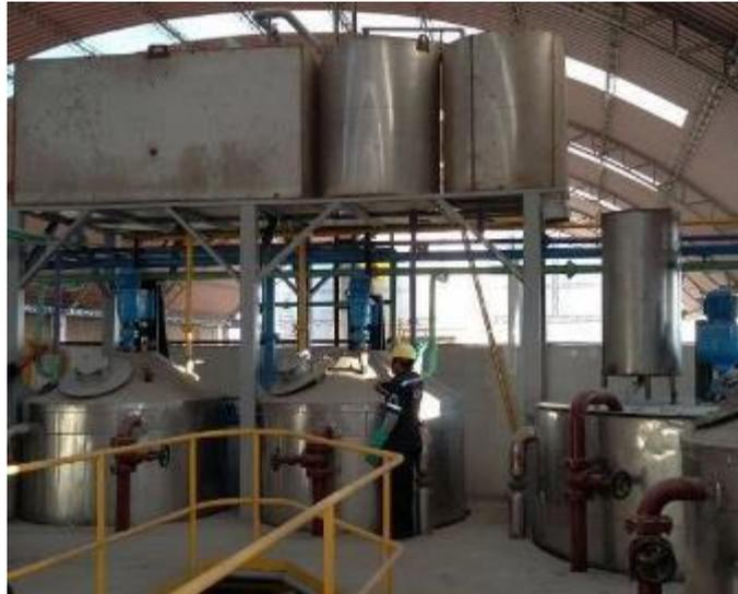
Figura 17: Tanque con motorreductores instalados
