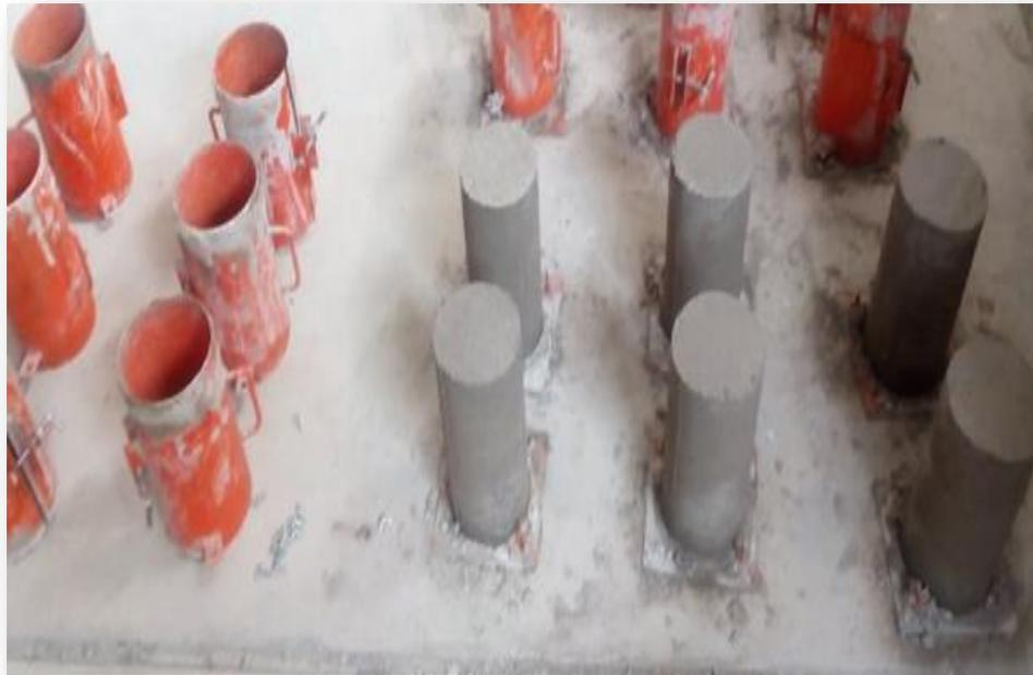
**Figura 13. Desencofrado Del Concreto**
