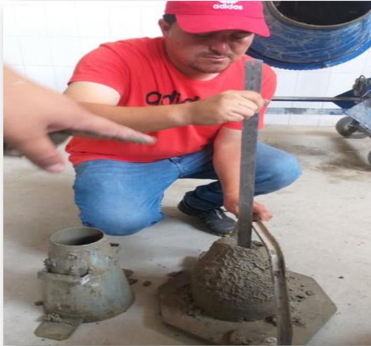
*Figura 9. Slump Del Concreto*
