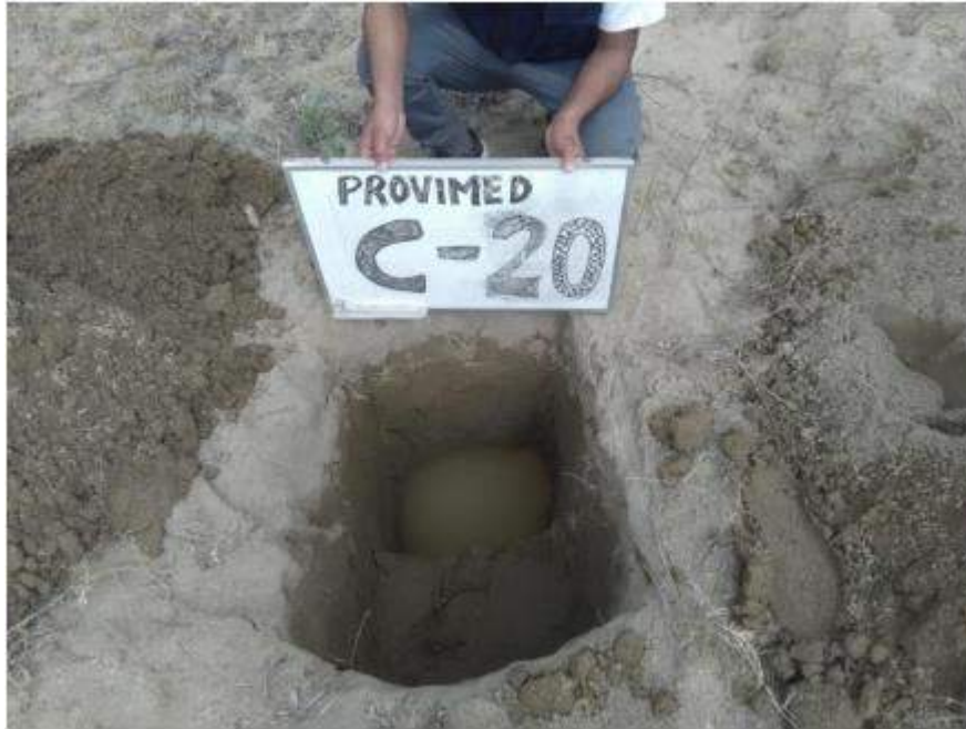
Foto 11.- Excavación de calicata, nivel freático elevado a -1.20m aprox.
