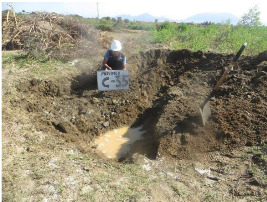
Foto 12.- Vista de la Calicata C-35, se aprecia el suelo arenoso y a partir de la Profundidad de -0.60m se encontró el Afloramiento Rocoso y el nivel freático.
