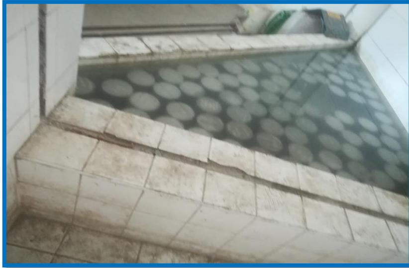
CURADO DE LAS PROBETAS DE CONCRETO EN UNA PATERA CON AGUA, EL CUAL SE RETIRA LUEGO DE CUMPLIR LOS DIAS PARA VERIFICAR SU RESISTENCIA.
