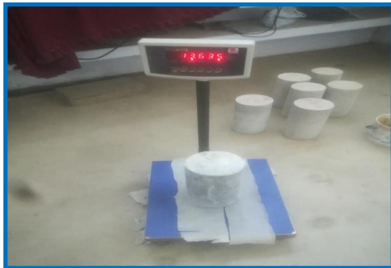
PESADO DE PROBETAS ANTES DE LLEVARLA A LA MAQUINA COMPRESORA DONDE ARROJARA LA RESISTENCIA DE DICHA PROBETA DE CONCRETO.
