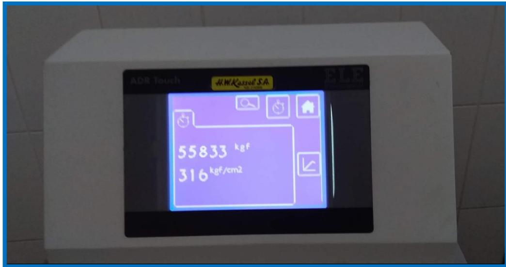
ENSAYO DE RESISTENCIA A LA COMPRESIÓN DE LOS TESTIGOS DE CONCRETO
