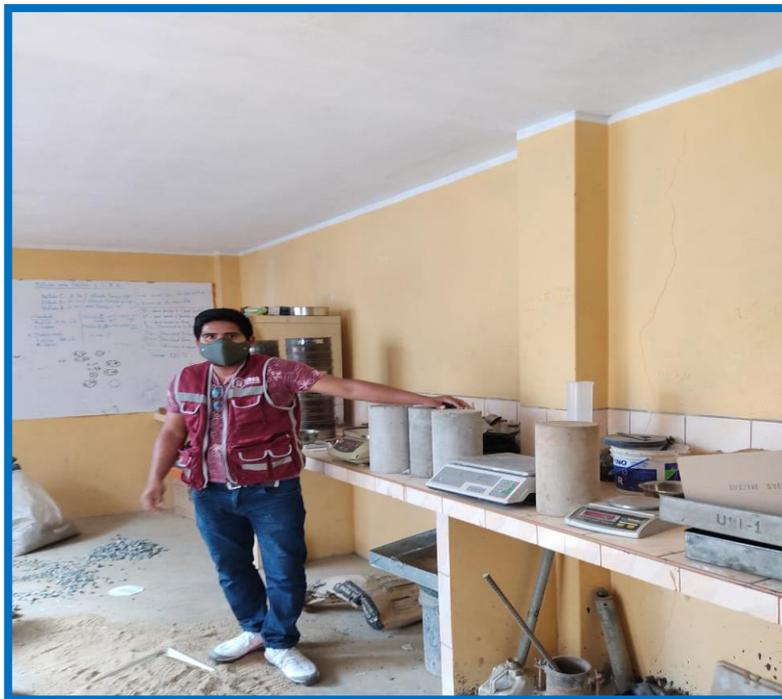
TESTIGOS DE CONCRETO A REALIZAR EL ENSAYO A LA COMPRESIÓN.
