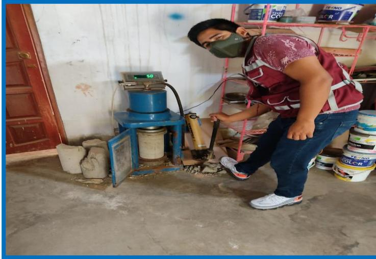
ENSAYO DE RESISTENCIA A LA COMPRESIÓN DE LOS TESTIGOS DE CONCRETO
