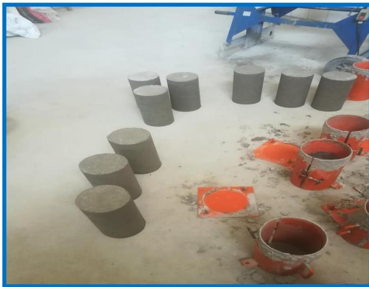
DEENCOFRADO DE LOS TESTIGOS DE CONCRETO PARA POSTERIORMENTE LIMPIAR LAS PROBETAS CILINDRICAS.
