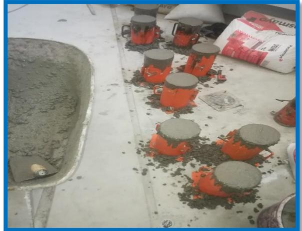
COLOCANDO EL CONCRETO CON CENIZA DE BAGAZO DE CAÑA DE AZUCAR EN LAS PROBETAS CILINDRICAS.
