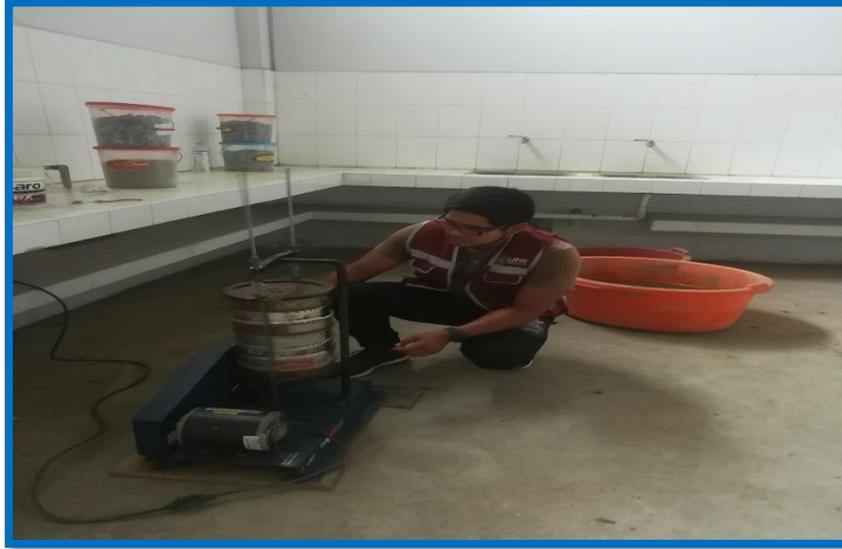
TAMIZANDO LOS AGREGADOS CON AYUDA PARA POSTERIORMENTE CALCULAR LA GRUNULOMETRIA ASI COMO SU MODULO DE FINEZA.
