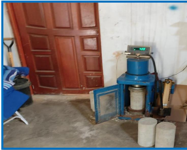
TESTIGOS DE CONCRETO EN LA MAQUINA DE COMPRESIÓN, EN EL LABORATORIO UNIGEO E.I.R.L.
