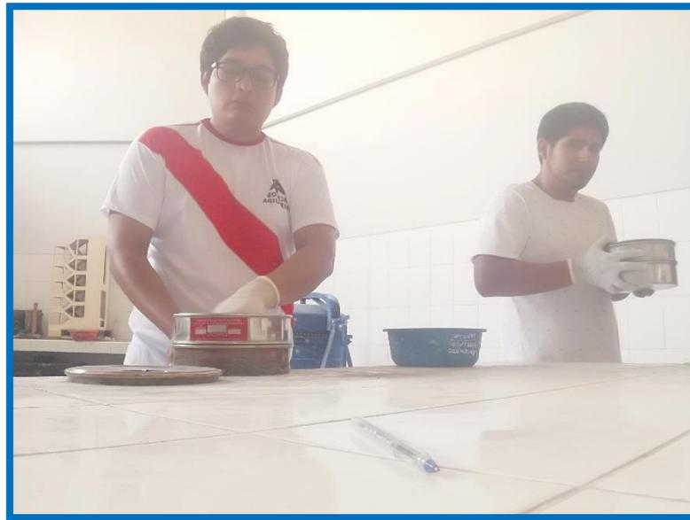
TAMIZADO DE LAS CENIZAS DE BAGAZO DE CAÑA DE AZUCAR MANUALMENTE PARA SUSTITUIR AL CEMENTO.
