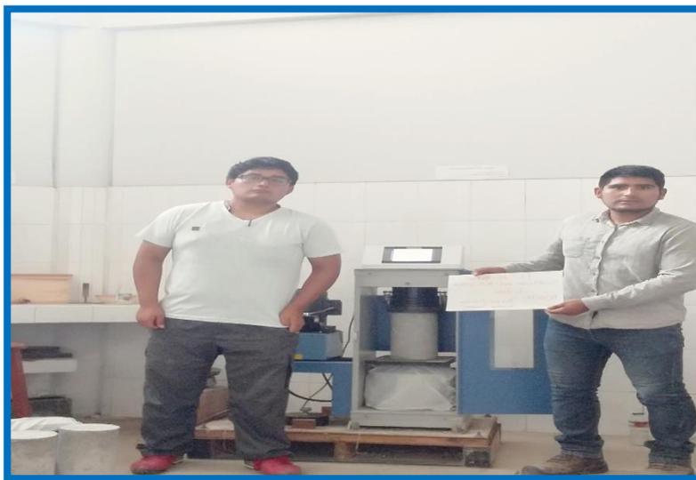
ENSAYO DE RESISTENCIA A LA COMPRESION A LAS PROBETAS DE CONCRETO CON CBCA CUYA RESISTENCIA ES DE 210 kg/cm<sup>2</sup>.
