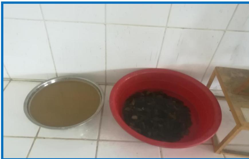
COLOCADO DEL AGREGADO EN DEPOSITOS CON AGUA PARA LUEGO SER EMPLEADO EN EL ENSAYO DE ABORCION.
