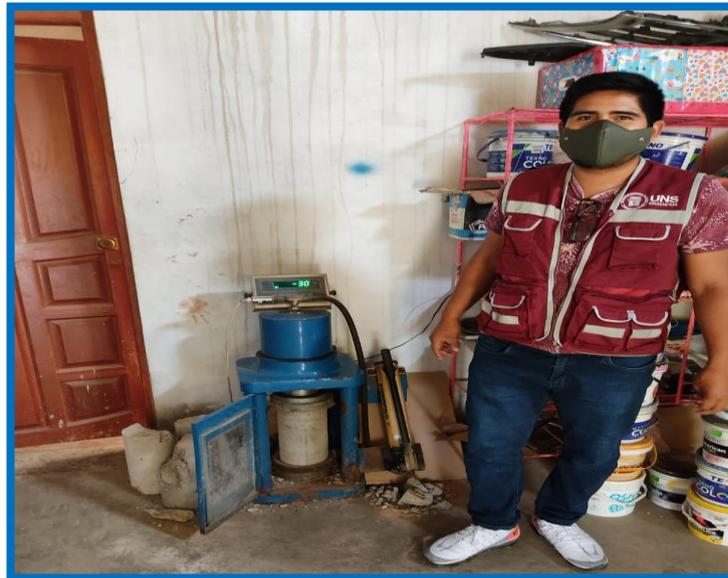
ENSAYO DE RESISTENCIA A LA COMPRESIÓN DE LOS TESTIGOS DE CONCRETO
