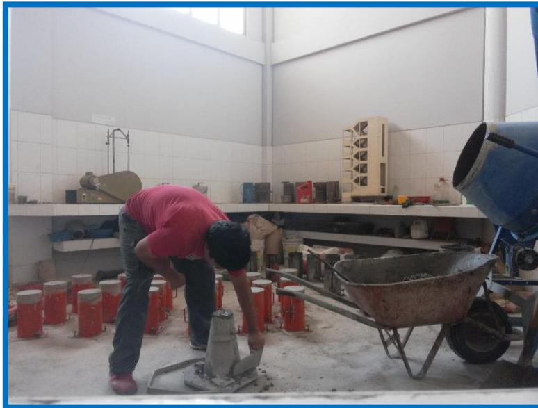
.REALIZANDO EL ENSAYO DEL CONO DE ABRAMS PARA SABER CUANTO SI TIENE BUENA CONSISTENCIA. Y VERIFICAR SU ASENTAMIENTO.
