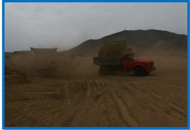
AGREGADO FINO DE LA CANTERA “LA SOPRESA” EL QUE SE UTILIZA PARA LA ELABORACION DE CONCRETO.
