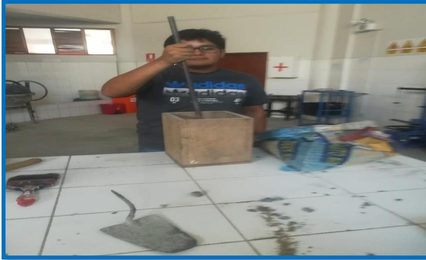
REALIZANDO EL COMPACTADO DEL AGREGADO PARA PODER OBTENER EL PESO UNITARIO.
