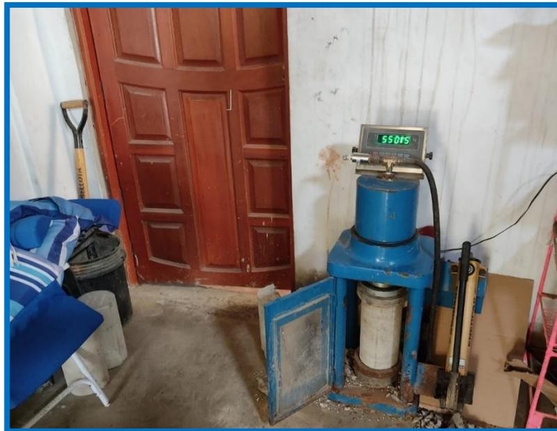
ENSAYO DE RESISTENCIA A LA COMPRESIÓN DE LOS TESTIGOS DE CONCRETO F'C 210 kg/cm<sup>2</sup> – RESISTENCIA OBTENIDA A LOS 28 DIAS PARA EL CONCRETO CON 2 % DE CBCA.
