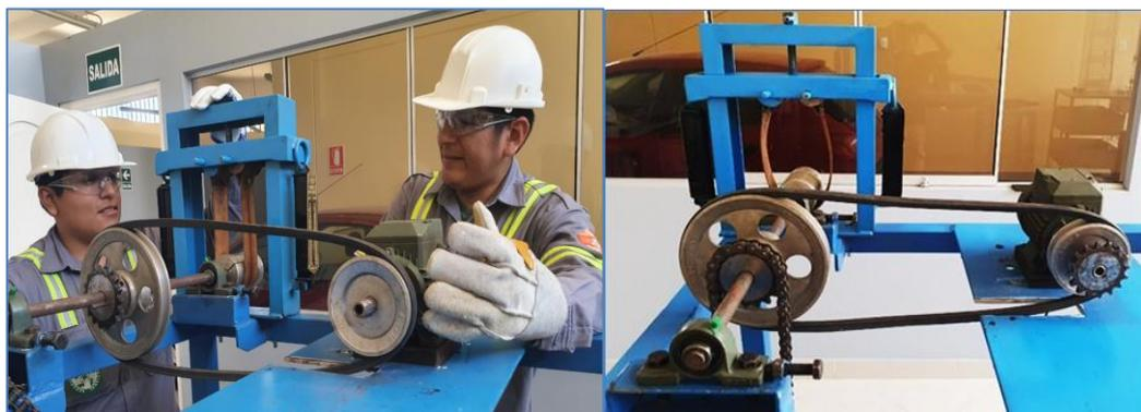
**Figura 37.** Módulo montado con Frenoprony
