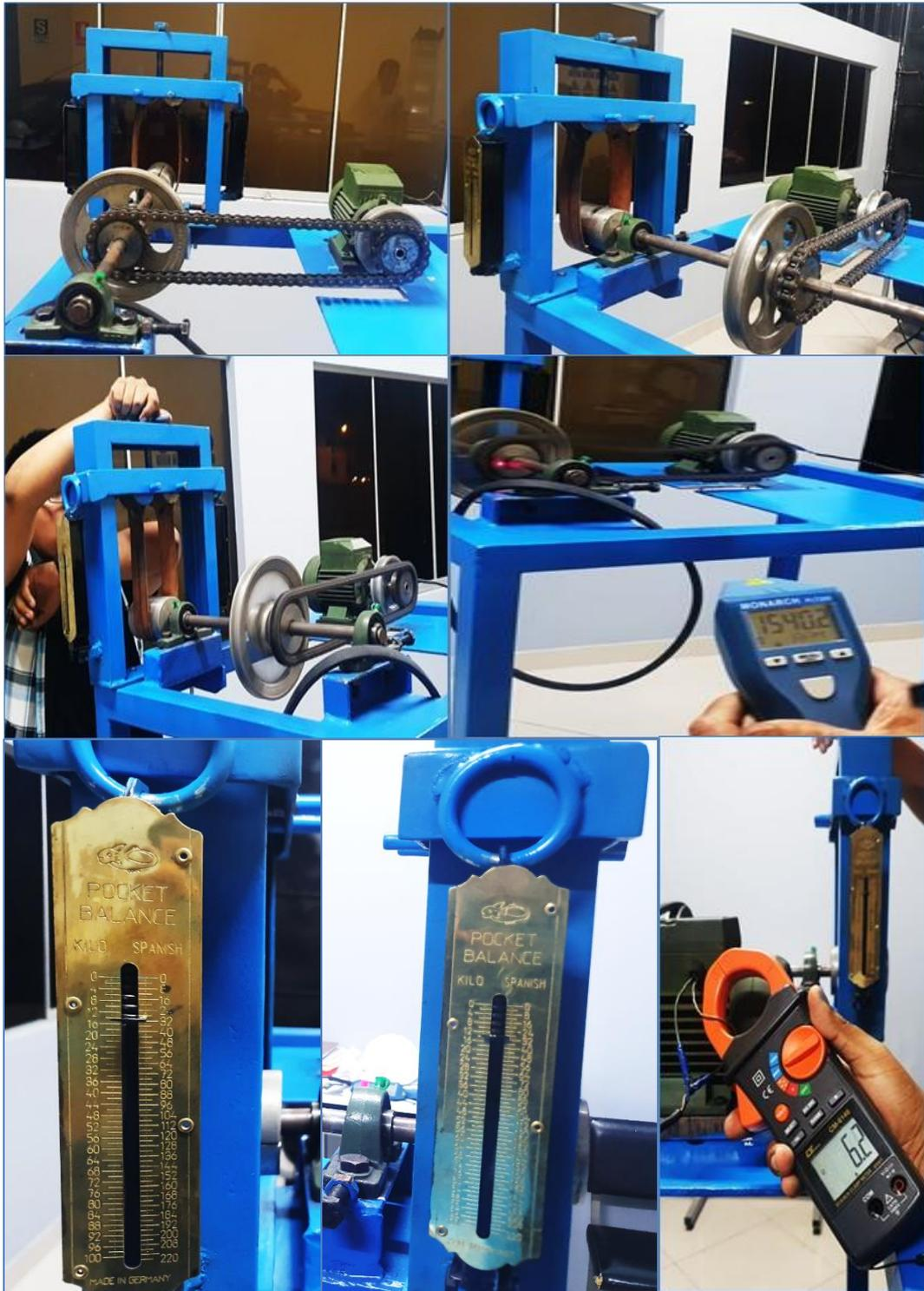
**Figura 39.** Medición de Fuerza, RPM y Amperaje en transmisión por Cadena
