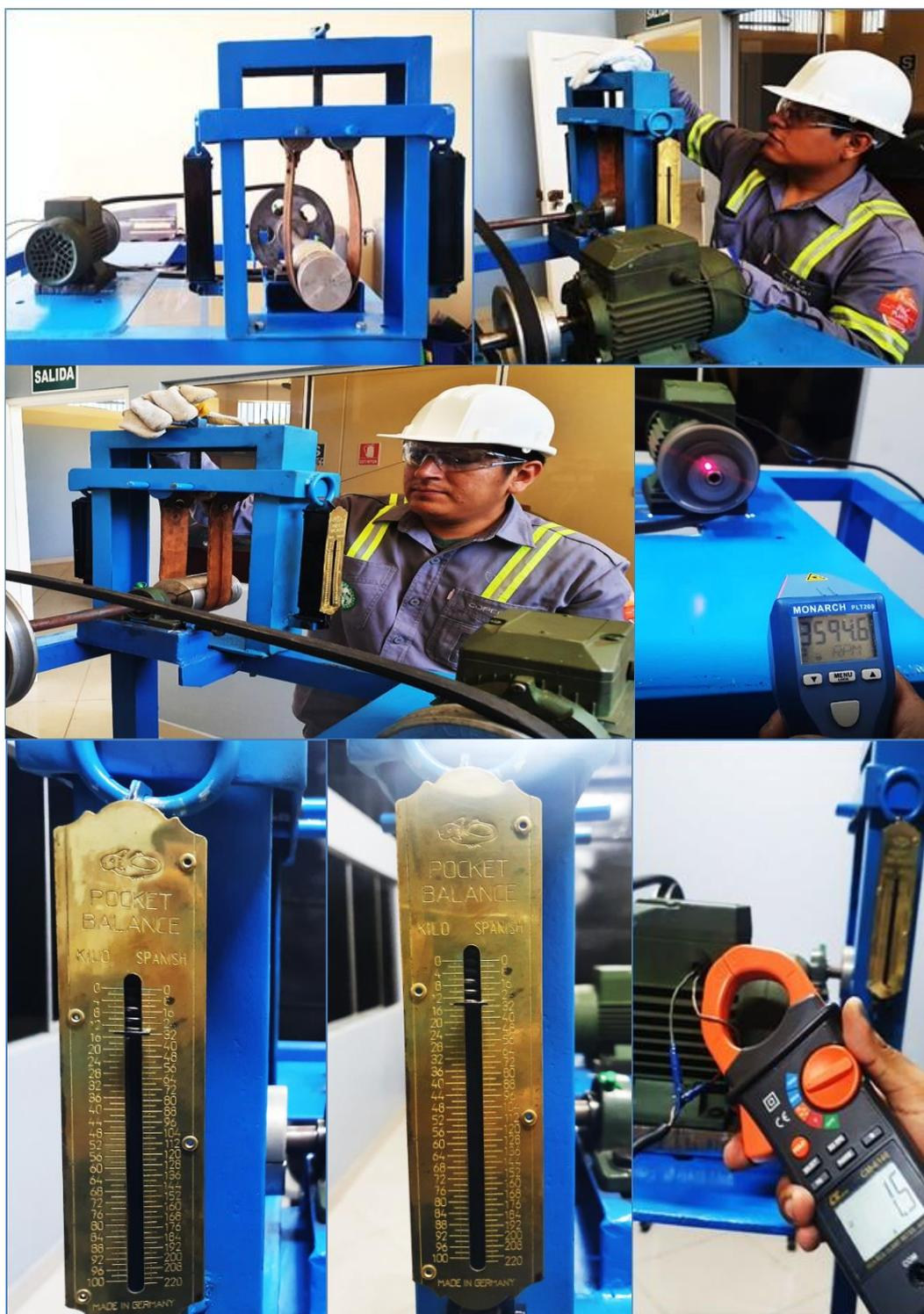
**Figura 38.** Medición de Fuerza, RPM y Amperaje en transmisión por Faja
