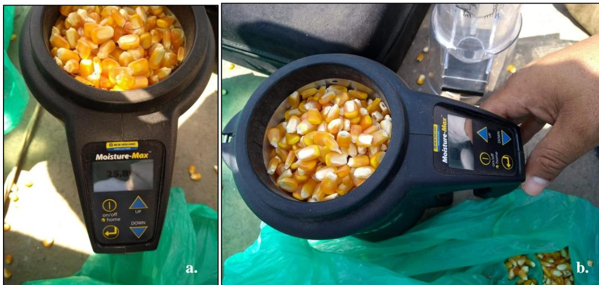
**ANEXO 15:** Determinación de la humedad de grano con humidímetro de grano **a)** al momento de cosecha y **b)** 10 días después del secado para llegar al punto óptimo de 15.5% de humedad para la venta y así poder determinar el rendimiento por tratamiento.
