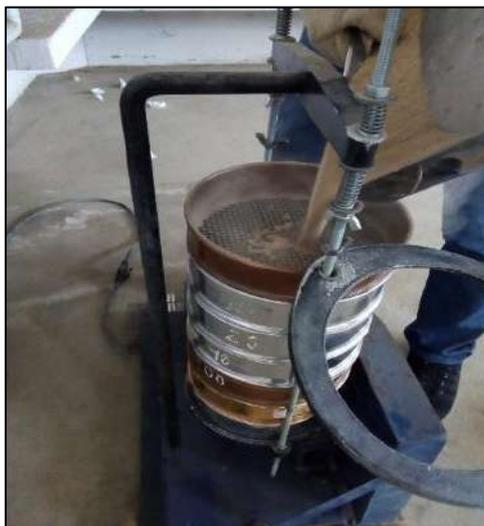
Consiste en hacer pasar una muestra ya sea inalterada o alterada por tamices o mallas por vía seca con diferentes aberturas que van desde la Malla de 3” a la Malla N° 200.
