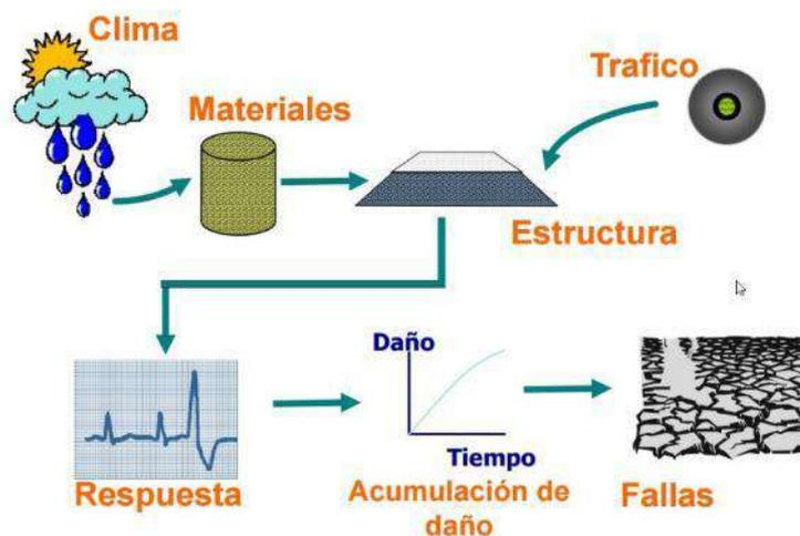
Figura 2.2.2. Esquema funcionamiento método mecánico – empírico
