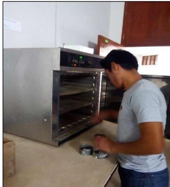
Consiste en pesar la muestra húmeda y luego secar la muestra en el recipiente por medio de la fuente de calor elegida, teniendo cuidado de evitar la pérdida de ninguna partícula, para posteriormente volver a pesar la misma muestra en estado seco.
