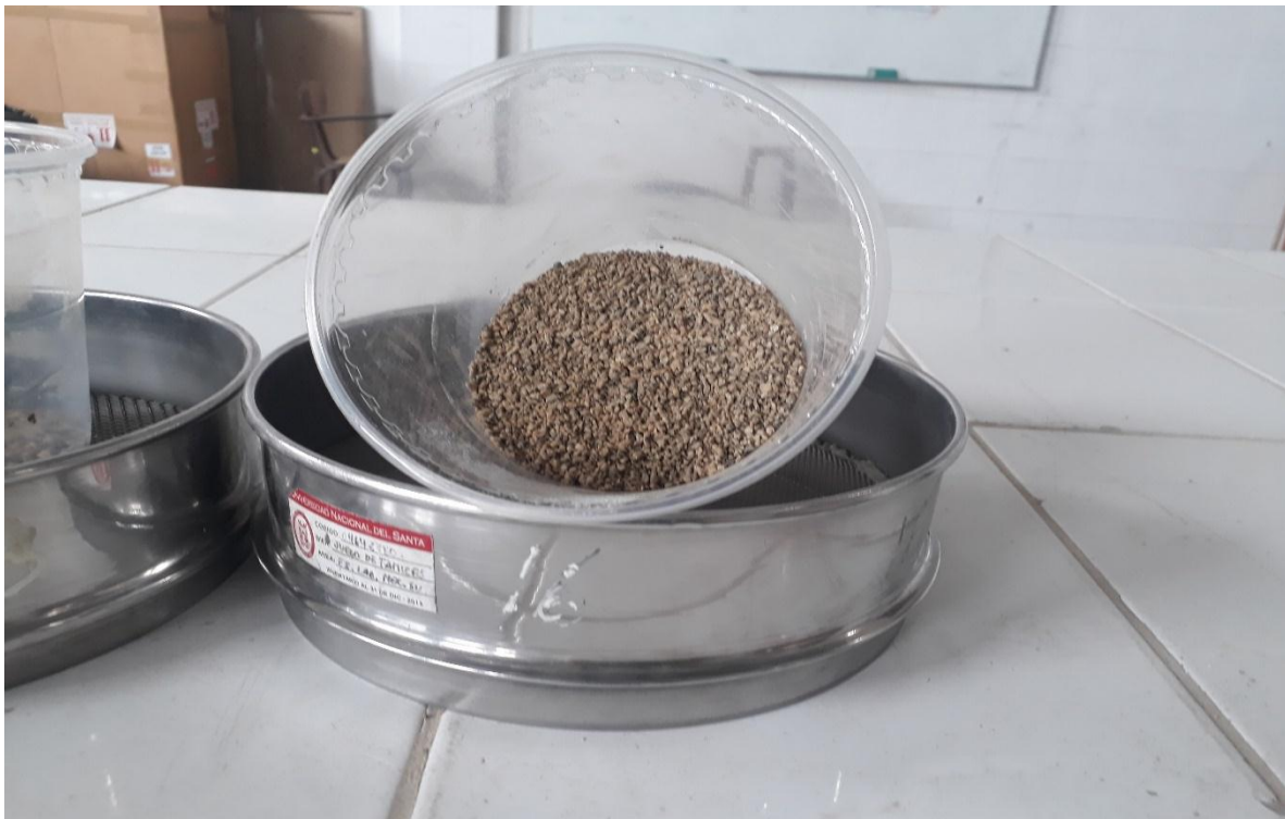
Fotografias N° 02: ANALISIS GRANULOMETRICO DE LOS AGREGADOS
