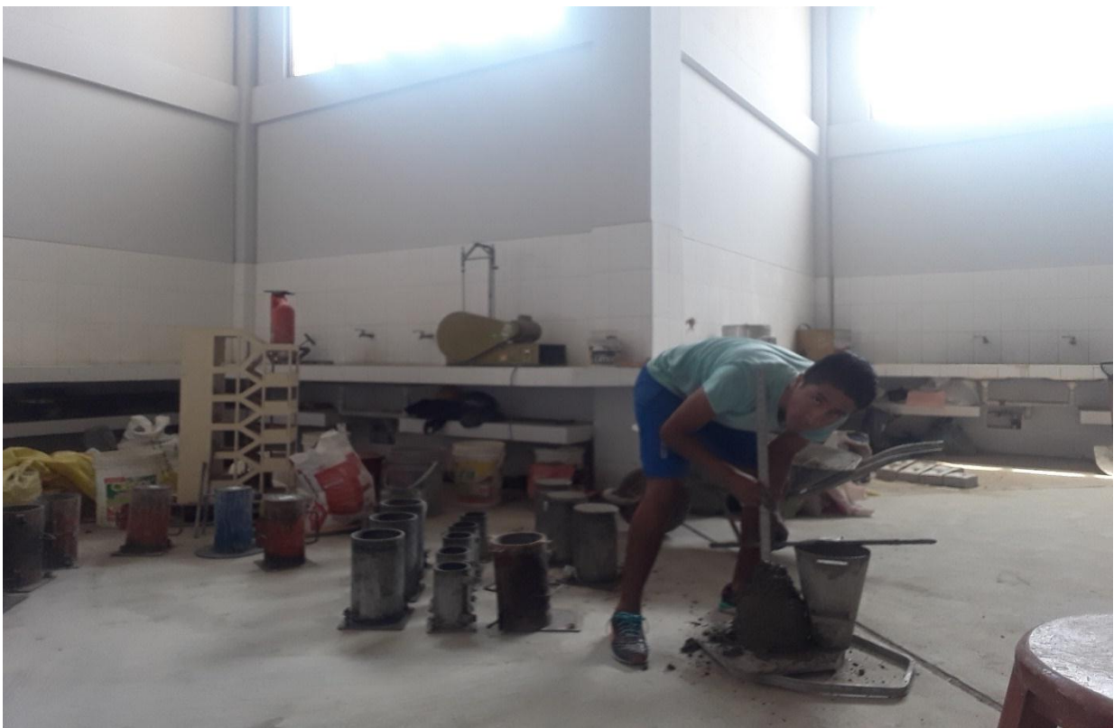
Fotografias N° 09: ENSAYO DE ASENTAMIENTO DEL CONCRETO
