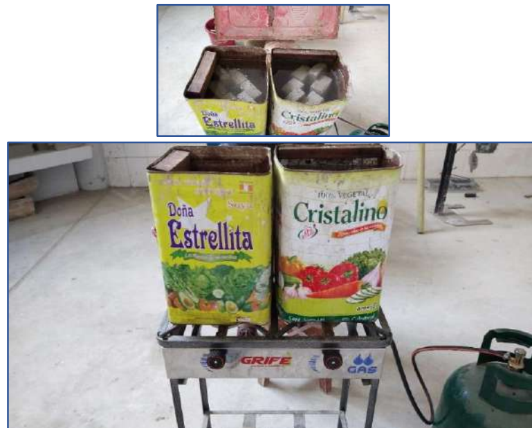
Foto 19: Ensayo de absorción máxima Fuente: Elaboración propia
