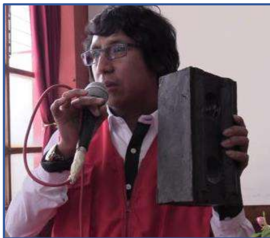
Figura 7: Ladrillo a base residuos sólidos
