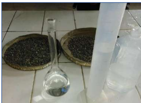
Foto 10: Ensayo de peso específico de confitillo Fuente: Elaboración propia
