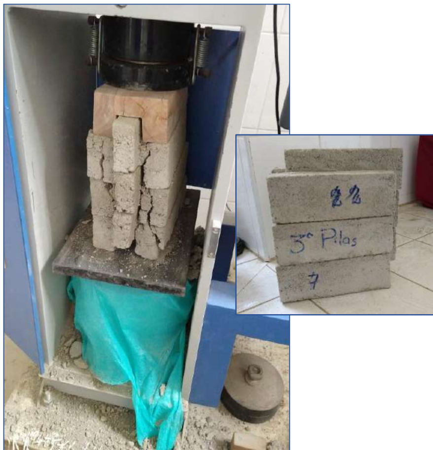
Foto 22: Ensayo de pilas
