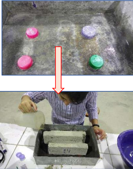
Foto 17: Ensayo de succión con peso natural Fuente: Elaboración propia
