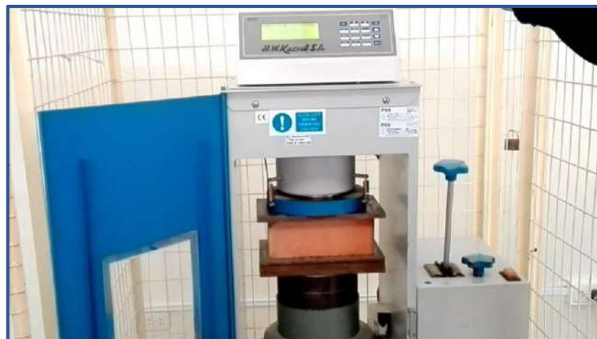
Figura 20: Ensayo para resistencia a la compresión
