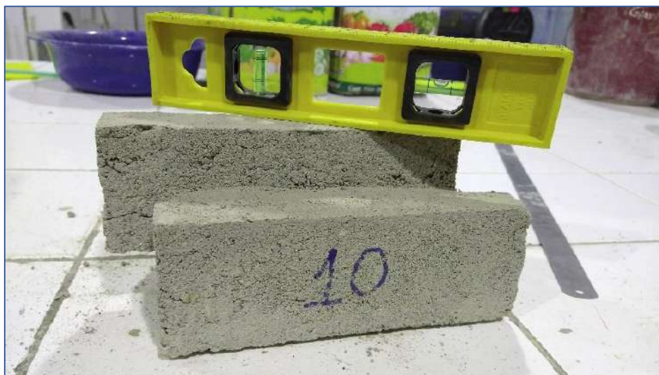
Foto 12: Ensayo de alabeo
