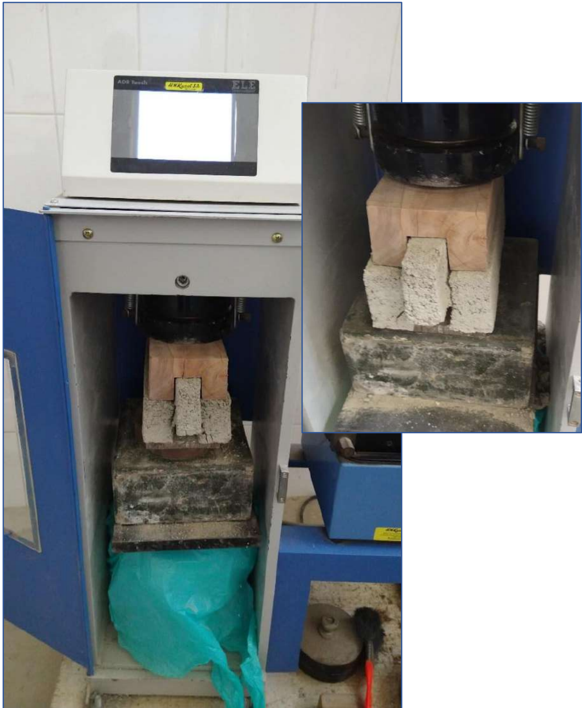
Foto 21: Ensayo de resistencia a la compresión Fuente: Elaboración propia
