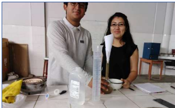
Foto 9: Ensayo de peso específico de arena gruesa Fuente: Elaboración propia
