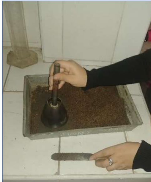
Foto 7: Ensayo de contenido de absorción de arena gruesa Fuente: Elaboración propia
