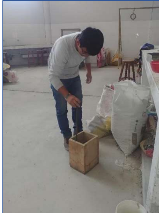
Foto 5: Ensayo de confitillo de peso unitario compacto
