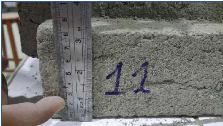
Foto 13: Ensayo de variación dimensional del cuerpo del ladrillo Fuente: Elaboración propia
