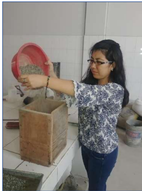
Foto 4: Ensayo de confitillo de peso unitario suelto
