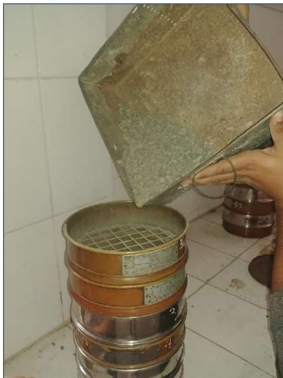
Foto 2: Ensayo de granulometría de confitillo Fuente: Elaboración propia
