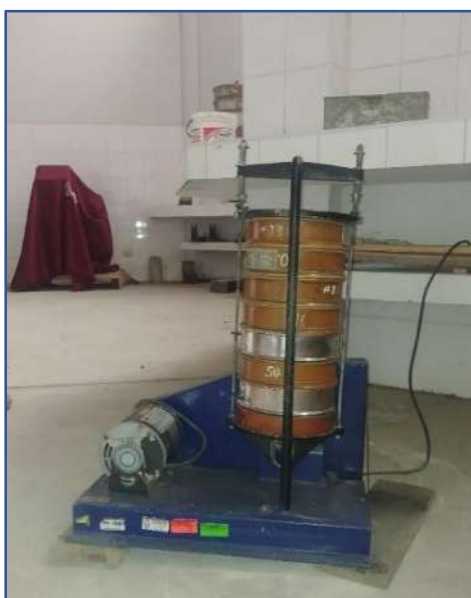
Foto 1: Ensayo de granulometría de arena gruesa Fuente: Elaboración propia
