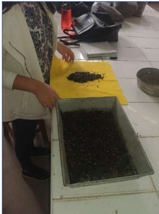
Foto 8: Ensayo de contenido de absorción de confitillo Fuente: Elaboración propia
