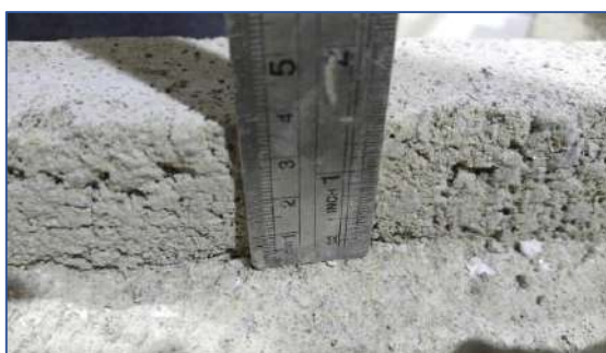
Foto 15: Ensayo de variación dimensional del canal del ladrillo
