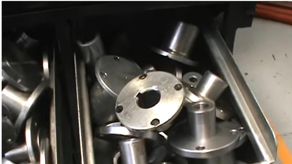
Fig. 01. Bridas para montaje de bombas
