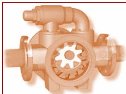
**Figura 2.33.** Bomba de engranajes internos. Viejo y Álvarez, “Bombas, teoría, diseño y aplicaciones”, (2003).
