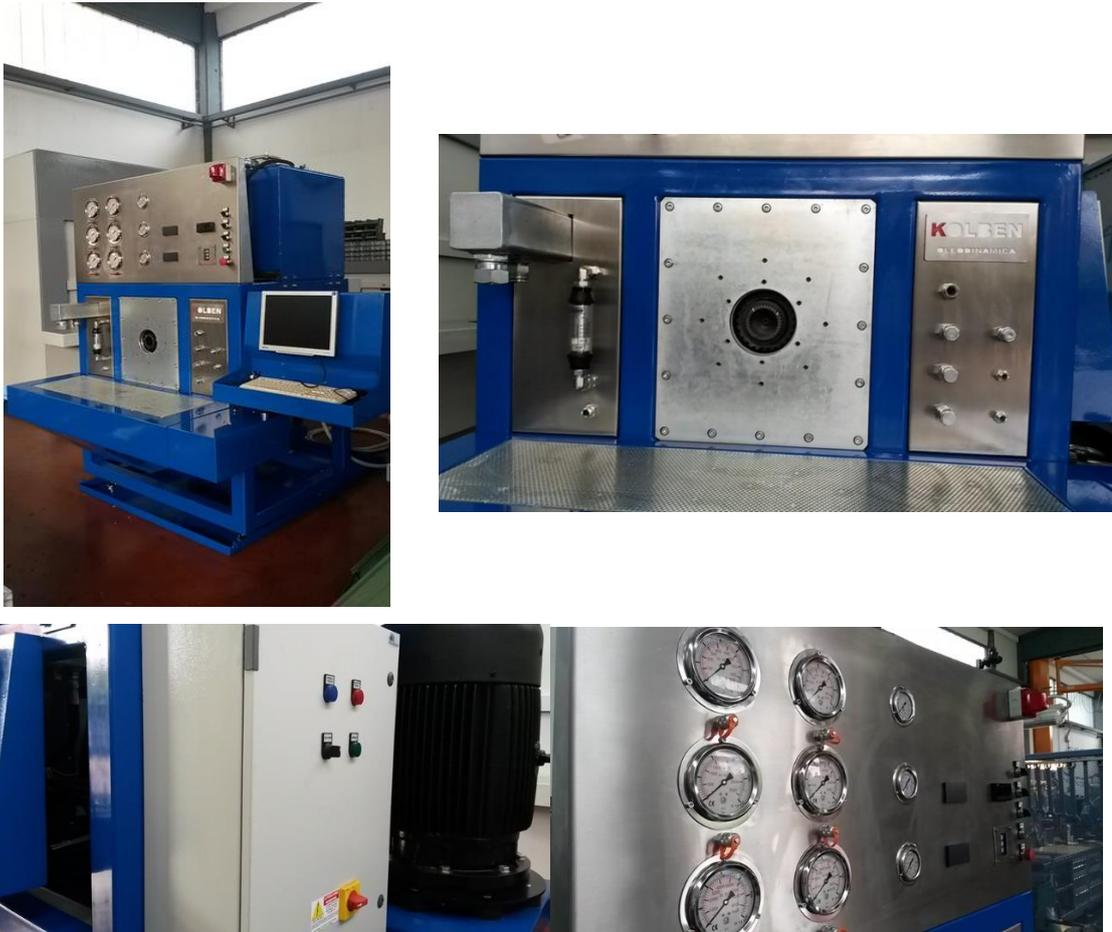
Figura 3.4: Banco hidráulico de 30 HP h30-17/3: elaboración propia
