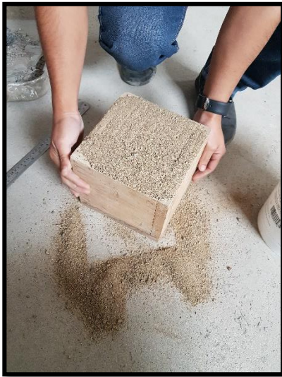
Foto 4: Ensayo para resultado de peso unitario del agregado fino.
