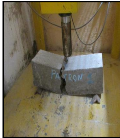
Foto 20: Rotura dentro de los \frac{2}{3} de luz (rotura aceptada), esto es una rotura aceptada.
