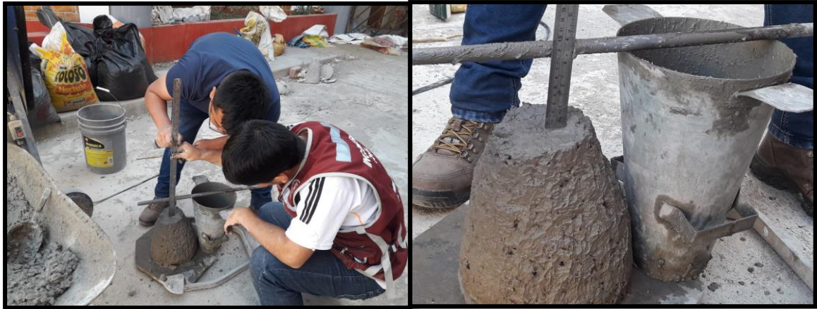
Foto 12 – Foto 13: Ensayo del cono de Abrams para determinar el Slump del Concreto.
