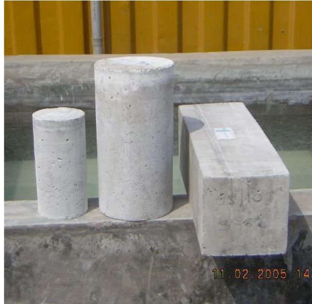
Figura 10. Testigos de concreto para ensayos. Fuente. Tópicos de Pavimentos de Concreto , Becerra Salas, 2012.
