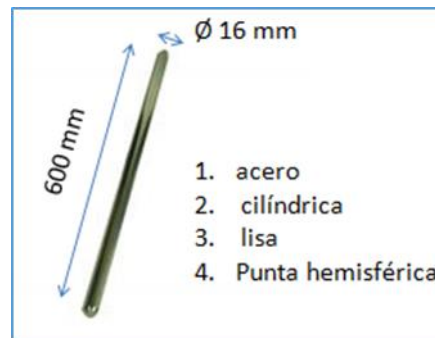
Figura 19. Varilla compactadora Fuente. Manual ensayo de materiales – MTC
