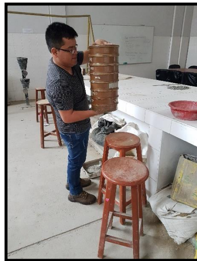
Foto 2: Tamizado con las mallas estándar del agregado fino para hallar su granulometría.
