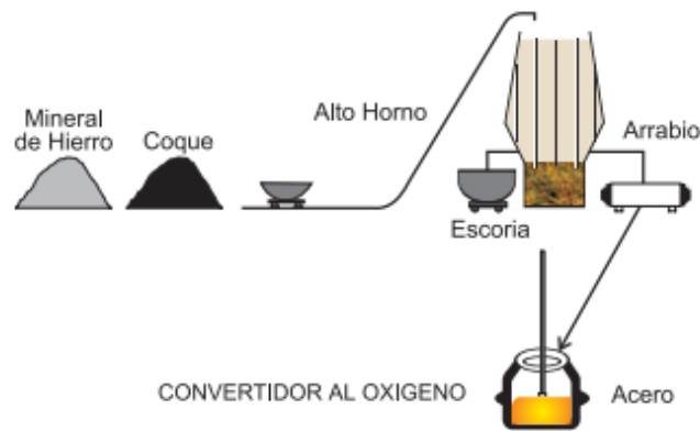
Figura 12. Elaboración Vía Alto horno Fuente. El Acero, Corporación Aceros Arequipa.
