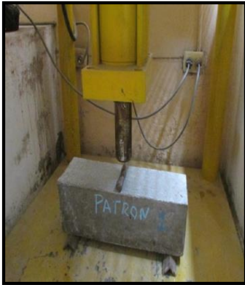
Foto 19: Colocación de viga para la rotura mediante el método de la viga simple cargada en el punto central.
