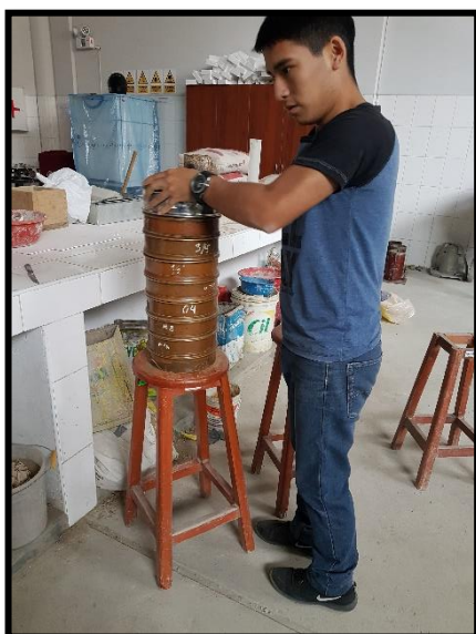
Foto 3: Tamizado con las mallas estándar del agregado grueso para hallar su granulometría.
