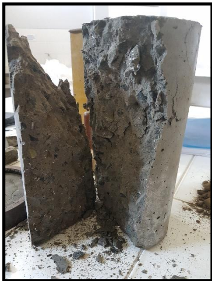
Foto 18: Testigo (probeta) de concreto ensayado se puede notar la presencia de la viruta de acero.
