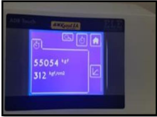
Foto 16: Resultado de resistencia a la compresión de testigo (probeta) de concreto.
