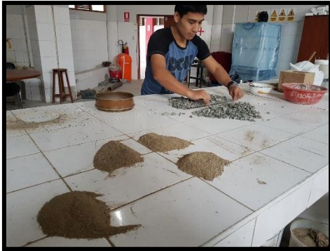
Foto 1: Realización de la práctica estándar de reducción de muestras para los agregados
