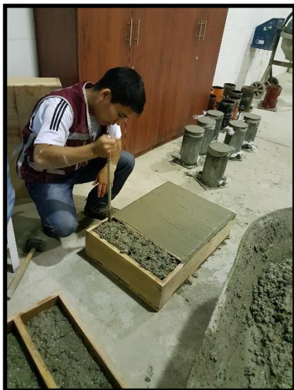
Foto 15: Elaboración de testigos (vigas) de concreto.
