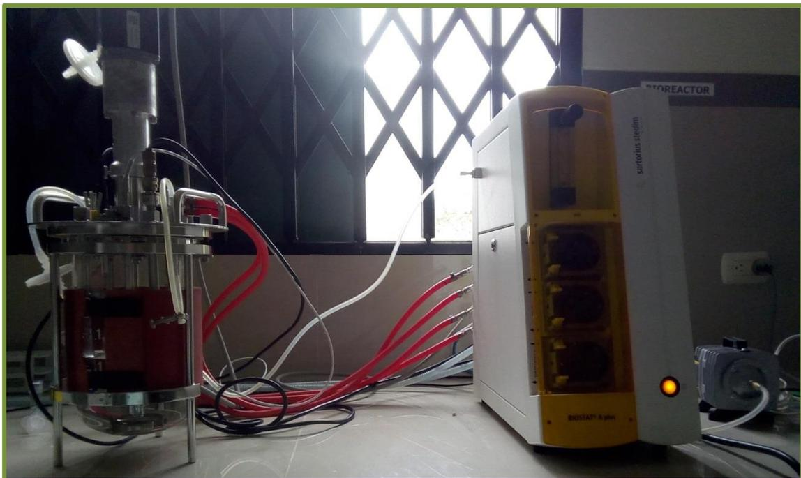
Tratamiento de sanguaza con microorganismos eficaces EM-1 llevándose a cabo en biorreactor “SARTORIUS STEDIM BIOTECH”, equipado con sistema de oxigenación, chaqueta de calefacción, sensor de temperatura, electrodos de oxígeno disuelto y pH
