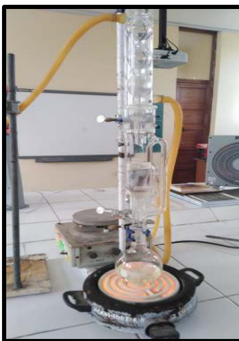
Figura 29: Determinación de grasas. Montaje del equipo Soxhlet
