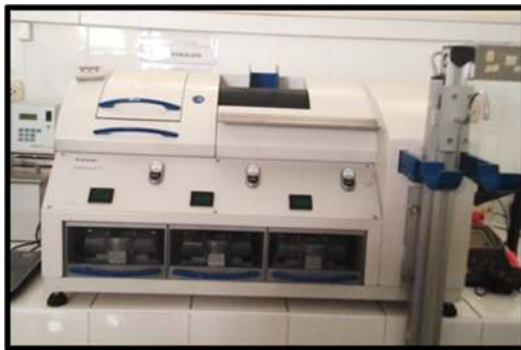
Figura 15: Equipo Extensógrafo – BRABENDER
