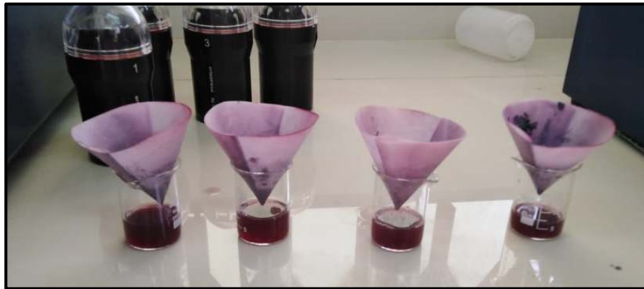
Figura A 8: Preparación de muestra para medir pH en harina de maíz morado
