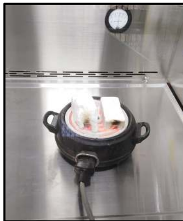
Figura A 2. Análisis de cenizas de las muestras
