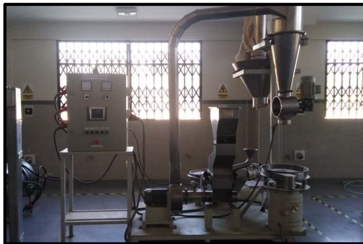
Figura 5: Módulo de molienda y tamizado
