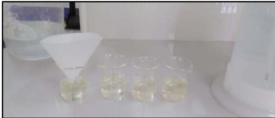
Figura A 9: Preparación de muestra para medir pH en premezcla panetonera
