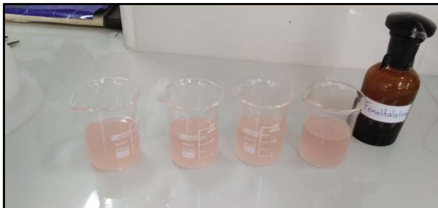
Figura A 10: Medición de acidez de las muestras
