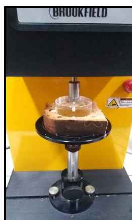
Figura A 12. Medición de textura instrumental, tratamiento óptimo
