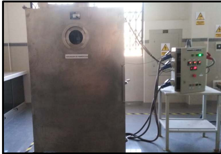
Figura 4: Secador de bandejas
