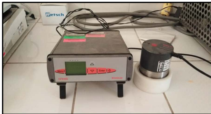
Figura A 7. Medición de A_w de las muestras
