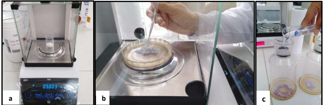
Figura A 4. a. Peso del célite b. Peso de la muestra c. Adición del tampón fosfato
