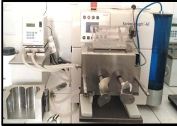
Figura 14: Figura 18: Equipo Farinógrafo – BRABENDER
