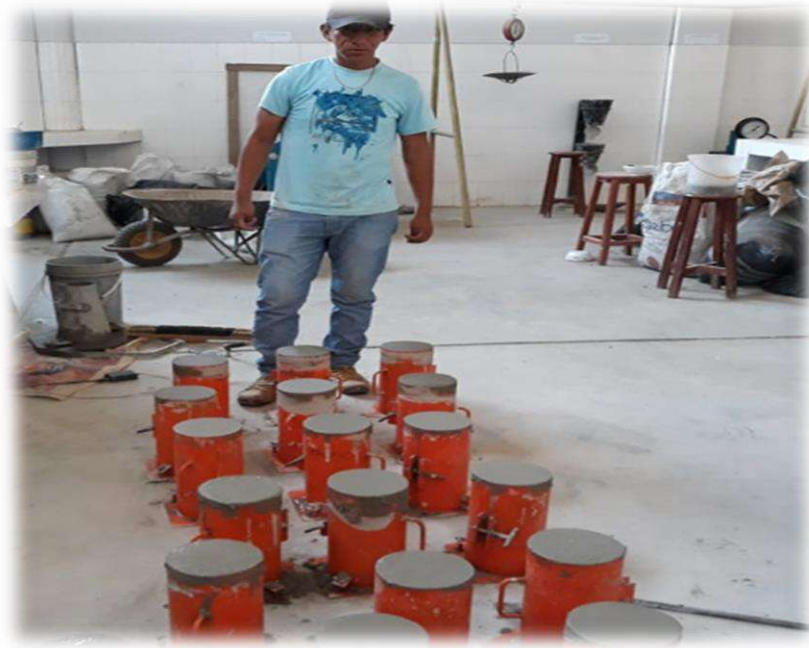
Foto 7. Elaboración de concreto según el diseño de mezcla. Fuente: Elaboración propia, 2019.
