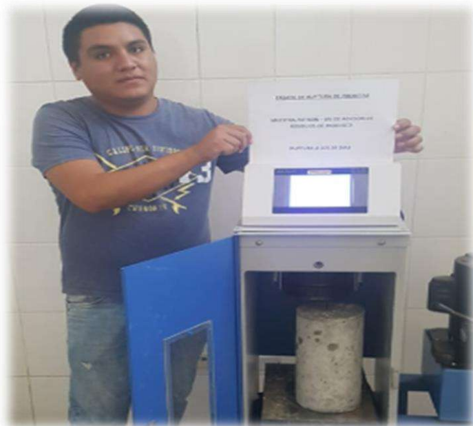
Foto 12. Ensayo a la compresión de los testigos de concreto de f'c : 210 kg/cm 2 Fuente: Elaboración propia, 2019.
