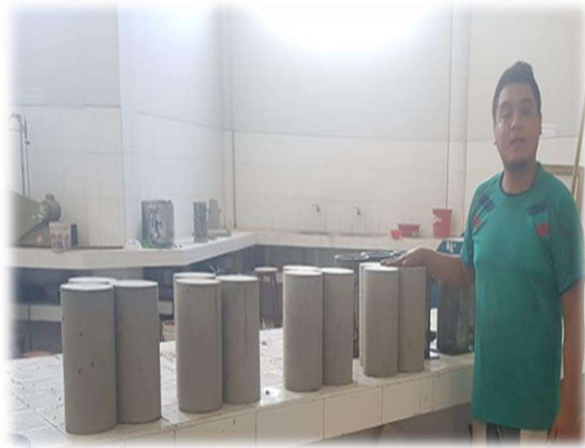
Foto 11: Desencofrado de los testigos de concreto de f'c : 210 kg/cm 2 Fuente: Elaboración propia, 2019.
