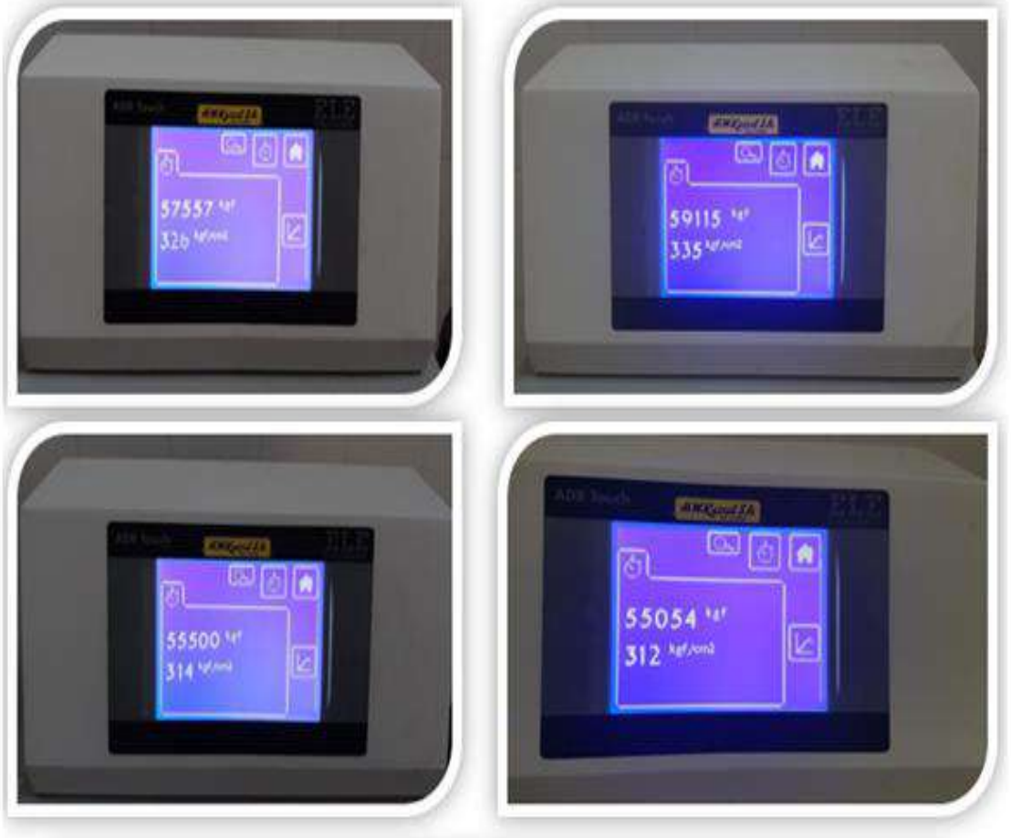
Foto 14. Resistencia la compresión de los testigos de concreto de f'_c : 210 kg/cm 2 con 7 % de adición de residuos de molusco a los 28 días. Fuente: Elaboración propia , 2019.
