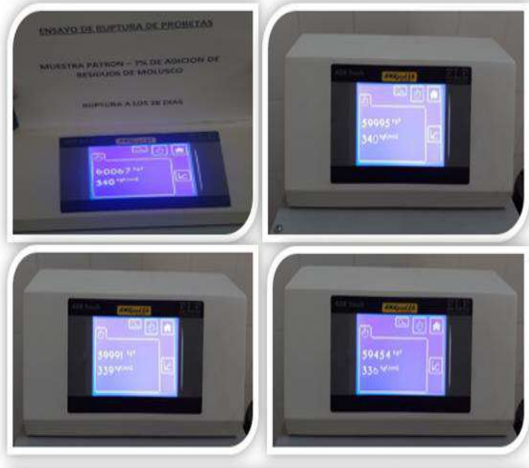
Foto 13. Resistencia la compresión de los testigos de concreto de f'c : 210 kg/cm 2 con 7 % de adición de residuos de molusco a los 28 días.
