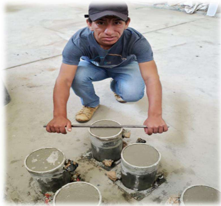
Foto 10. Acabado de los testigos de concreto de f'c : 210 kg/cm 2 Fuente: Elaboración propia, 2019.
