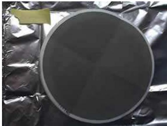
Filtro sobre el que se ha muestreado material particulado atmosférico.
