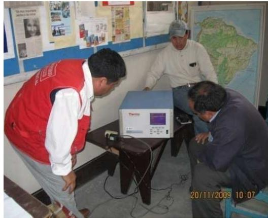
Equipo analizador automático de gases:  $\text{SO}_2$  /  $\text{H}_2\text{S}$ / $\text{NO}_2$ / $\text{CO}$ .
