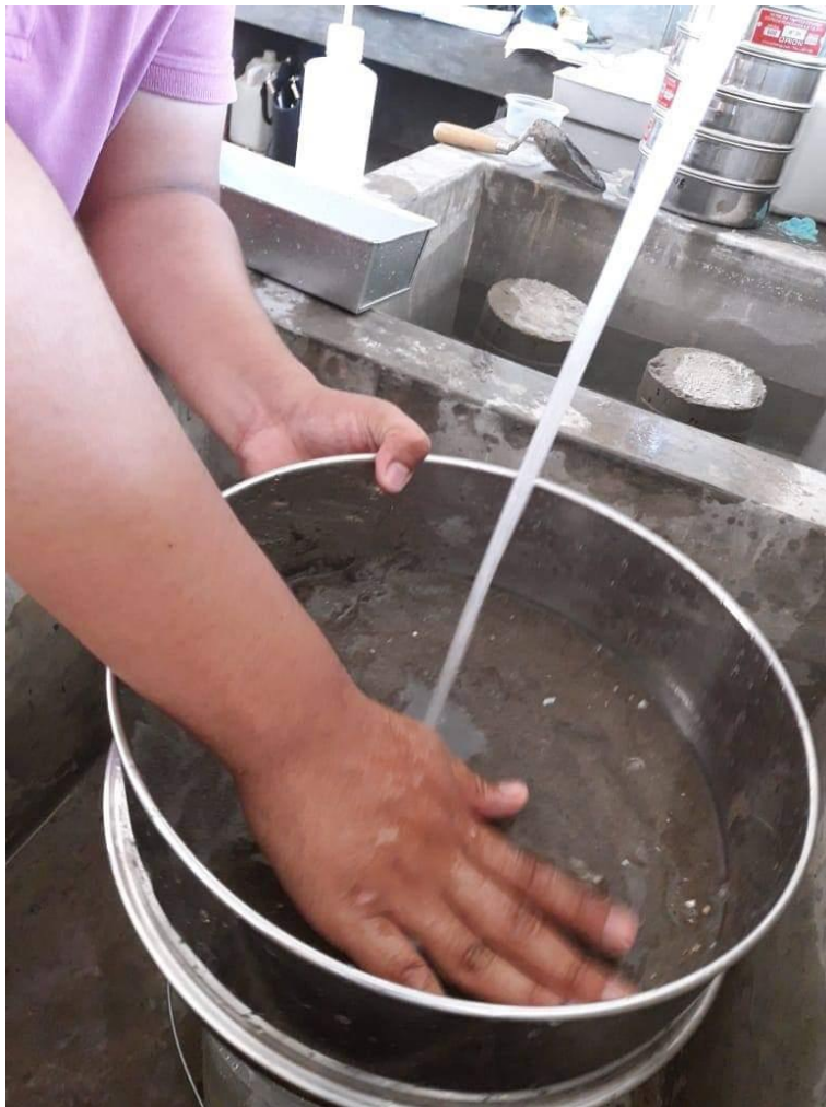
Gráfico 95. Eliminación de finos por el método del lavado
