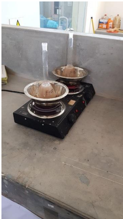
Gráfico 103. Colocación de las fiolas con agua y muestra
