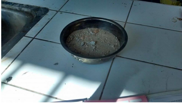
Gráfico 94. Colocación de la arena en tara para granulometría.
