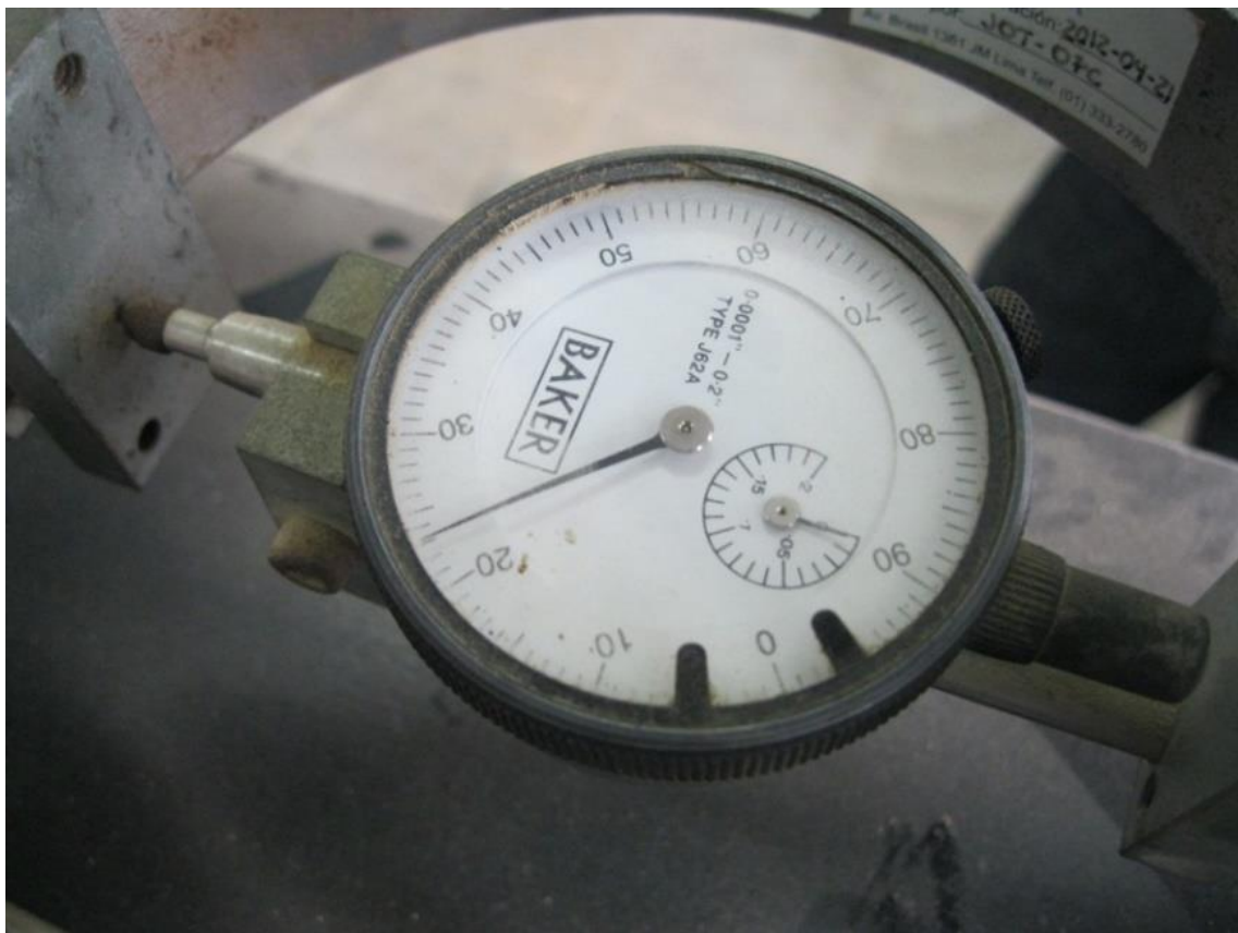
Gráfico 99. Toma de datos con las válvulas en la máquina para corte directo.
