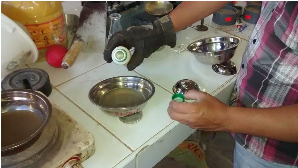
Gráfico 105. Colocación del ácido nítrico a la muestra
