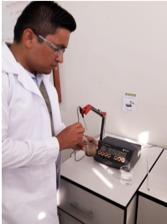
Gráfico 106. Medición del pH por el método electrométrico
