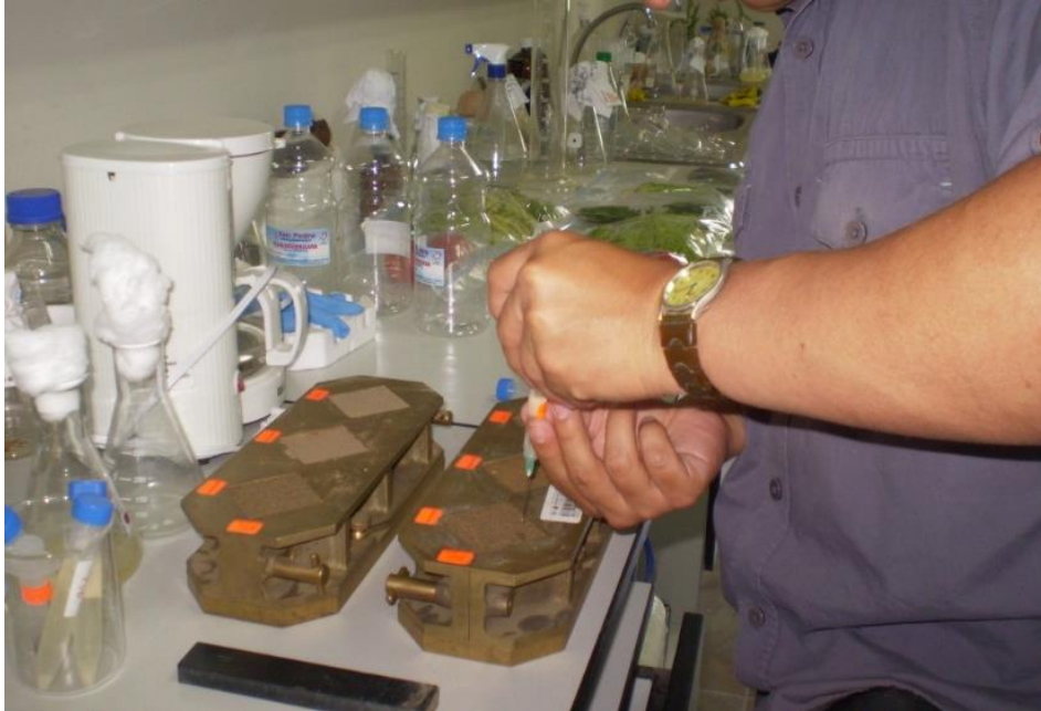
Gráfico 11. Inyección de medio nutritivo para enriquecer la matriz del suelo con bacterias y sustrato B1.
