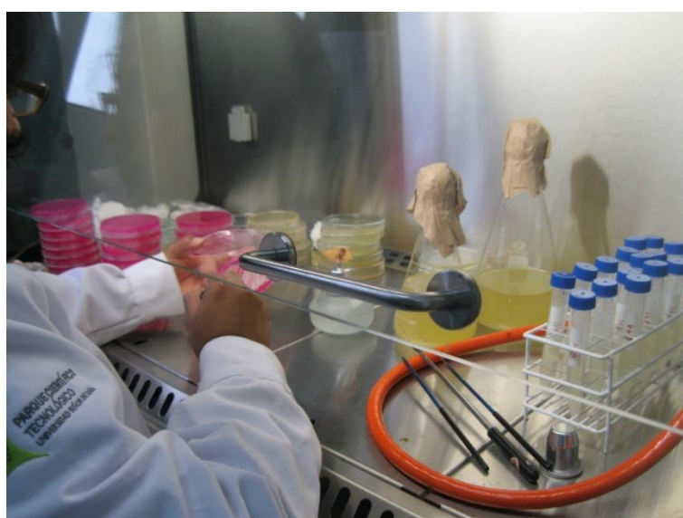
Gráfico 90. Elaboración de sustrato B1 en cámara de bioseguridad.
