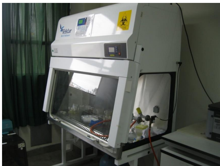
Gráfico 89. Cámara de bioseguridad para la elaboración de Sustrato B1.
