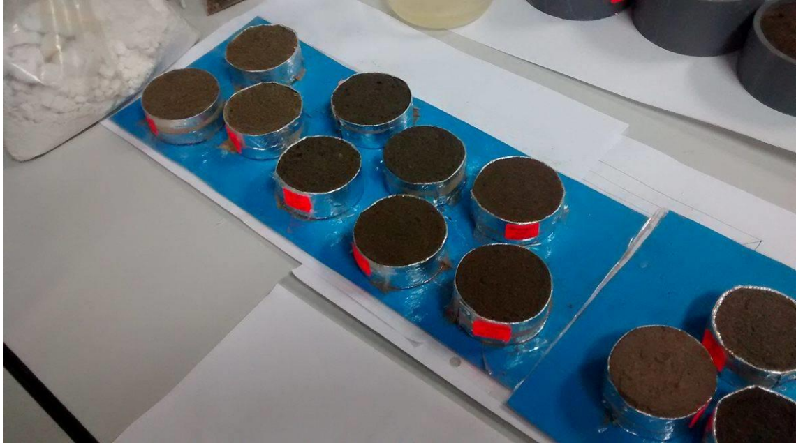
Gráfico 101. Colocación de la muestra en los talladores, para el ensayo de corte directo.
