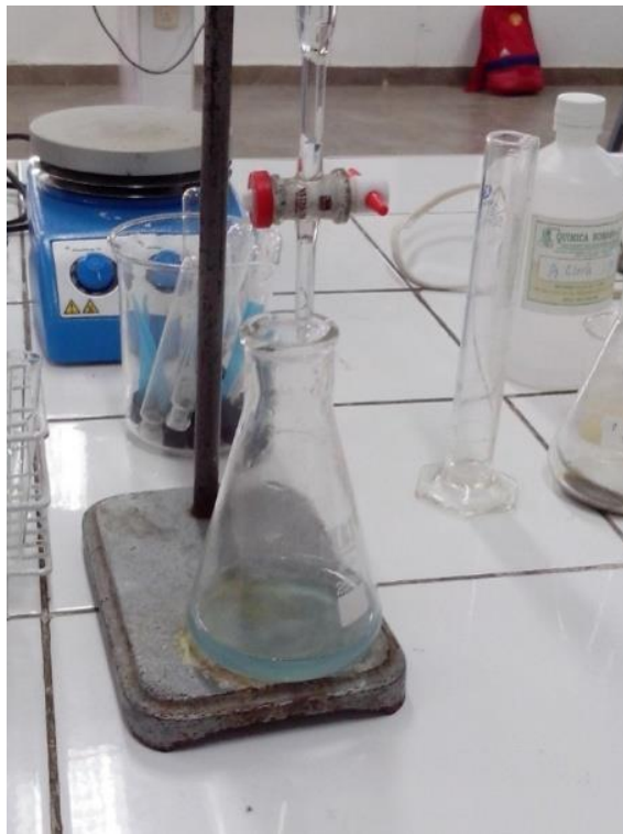
Gráfico 107. Determinación del porcentaje de \text{CaCO}_3 .
