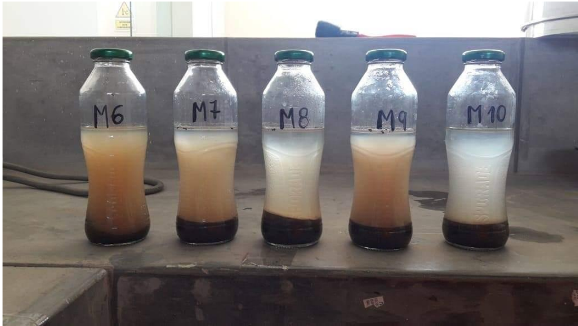
Gráfico 104: Colocación de la muestra tratada en frascos de vidrio proporción 1:3.
