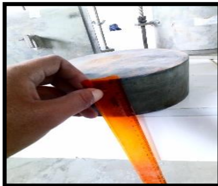
Figura N°103, 104 y 105: Toma de las medidas de los moldes y del disco espaciador para el ensayo CBR.
