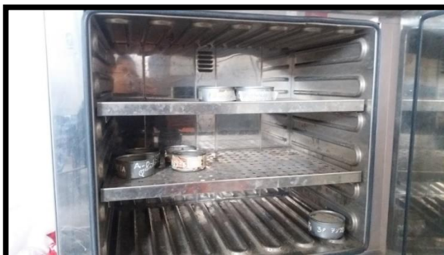
Figura N°133, 134 y 135: Pesaje de las muestras húmedas después del ensayo CBR y colocación en el horno para determinar su peso seco.
