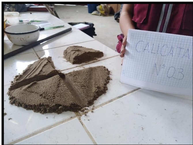
Figura N°43, 44 y 45: Obtención en laboratorio de muestra representativa de cada calicata mediante el cuarteo (MTC E 105).
