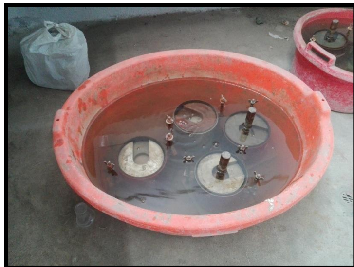
Figura N°121: Muestras CBR sumergidas en el agua por un periodo de 96 horas, después de la compactación.
