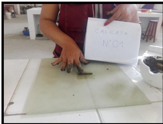
Figura N°64 y 65: Realización del ensayo de límite plástico de la calicata N° 01 de la muestra obtenida del lugar de estudio.
