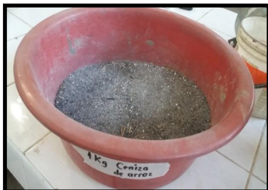
Figura N°81, 82 y 83: Preparación de las mezclas de suelo del lugar de estudio con la adición de cenizas de cáscara de arroz y cal, hasta lograr una mezcla uniforme.
