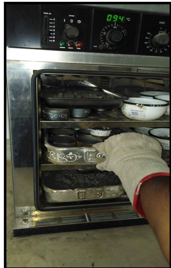
Figura N°90 y 91: Pesaje de las taras con las muestras húmedas del ensayo Proctor y colocación al horno eléctrico para obtener su peso seco.
