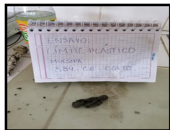
Figura N°66 y 67: No presenta límite plástico las combinaciones del suelo natural más 6%C+10%CCA y 4%C+20%CCA, debido a que carecen de plasticidad.
