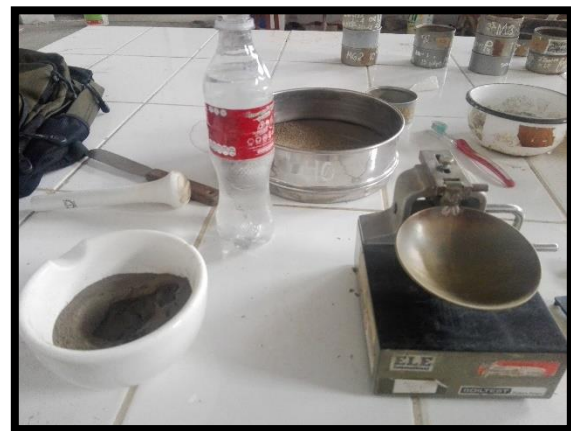
Figura N°59: Equipos y materiales necesarios para la determinación del límite líquido. (MTC E 110).
