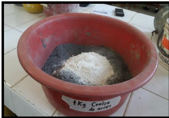
Figura N°78, 79 Y 80: Pesaje de los materiales utilizados para la realización del ensayo Proctor: suelo del lugar de estudio, cenizas de cáscara de arroz y cal.
