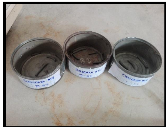
Figura N°64 y 65: Realización del ensayo de límite plástico de la calicata N° 01 de la muestra obtenida del lugar de estudio.
