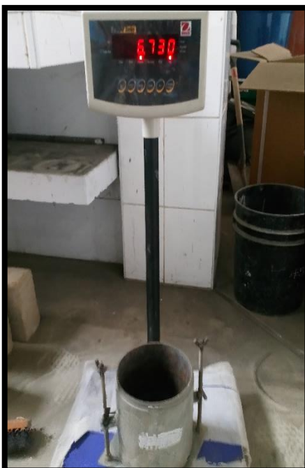
Figura N°106 y 107: Pesaje de los moldes de CBR y su placa base, antes de realizar el ensayo.
