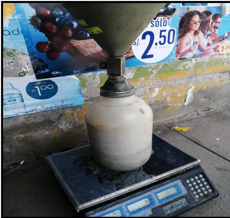
Figura N°27: Pesaje del cono de densidad antes y después del ensayo.
