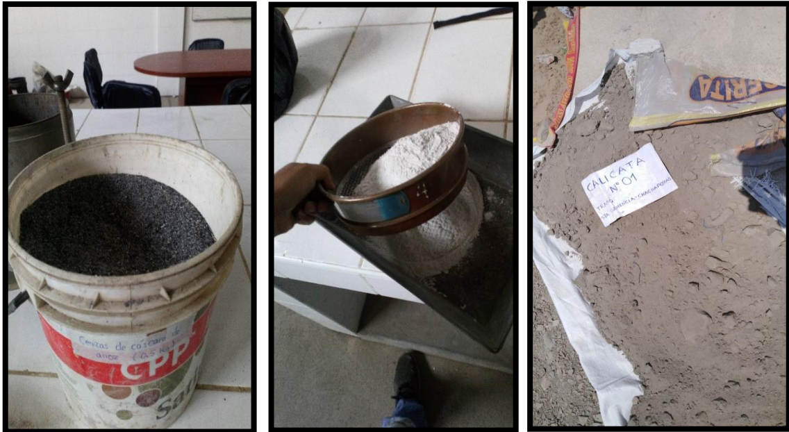
Figura N°92, 93 y 94: Materiales empleados para la realización del CBR: suelo del lugar de estudio, cenizas de cáscara de arroz y cal.
