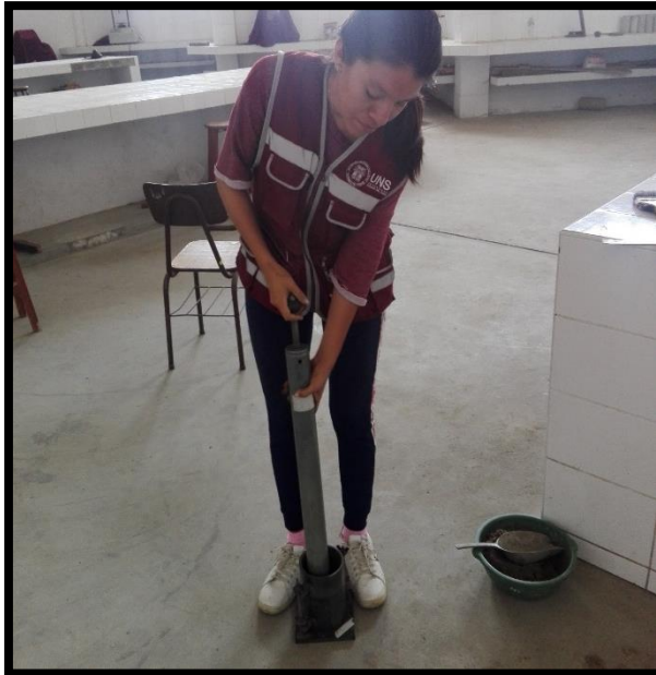
Figura N°8: Compactación de la mezcla de suelo en tres capas de 25 golpes con pisón manual en caída libre
