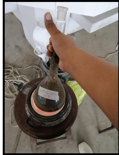
Figura N° 73, 74 y 75: Realización del ensayo para la determinación de la gravedad específica de sólidos de suelo mediante picnómetro de agua (MTC E 113).
