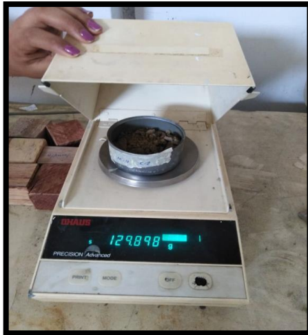
Figura N°50 y 51: Muestras de suelo colocadas en el horno eléctrico y posterior pesaje de las mismas para determinar el contenido de humedad de cada calicata.
