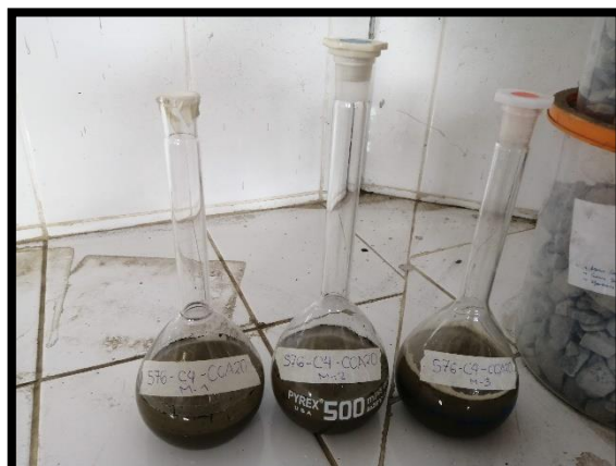
Figura N°70, 71 y 72: Vertido de la muestra de suelo y combinaciones de suelo + C+CCA con el embudo al picnómetro.
