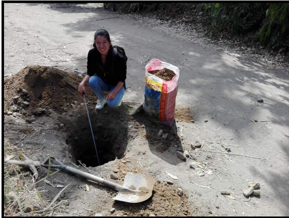
Figura N°07: Excavación y toma de muestra de suelo de la calicata C-07 en la vía Santa Clemencia – Chachapoyas.
