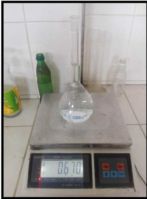
Figura N°68 y 69: Llenado del picnómetro con agua destilada hasta la marca de calibración y pesaje del mismo.
