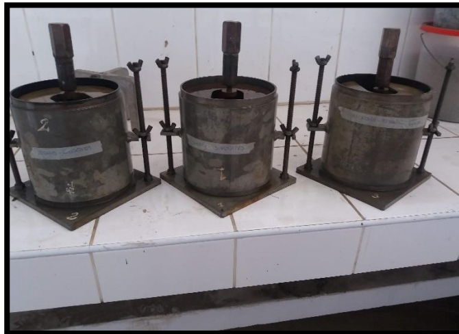
Figura N°118, 119 y 120: Colocación de las sobrecargas anular y saturada y de la placa con vástago en los tres moldes de CBR.
