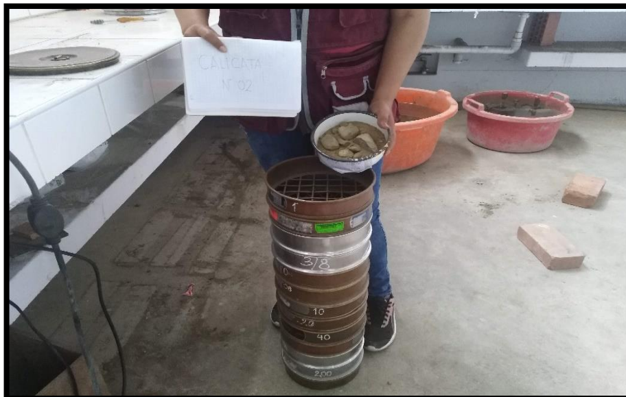
Figura N°52: Vertido de las muestras de suelo por cada calicata al juego de tamices empleados.
