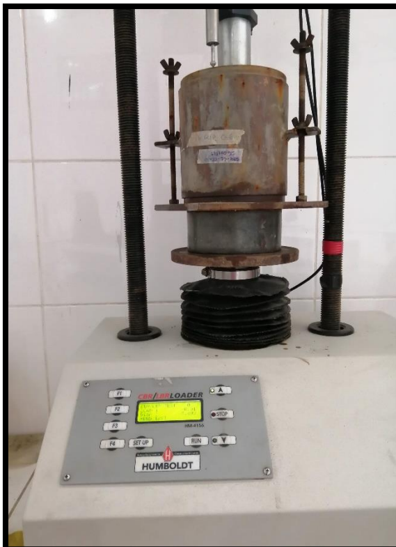
Figura N°127, 128 y 129: Realización del ensayo de penetración de las muestras de suelo natural y las mezclas con ceniza de cáscara de arroz y cal, empleándose las prensas hidráulicas. Toma de datos durante el ensayo.
