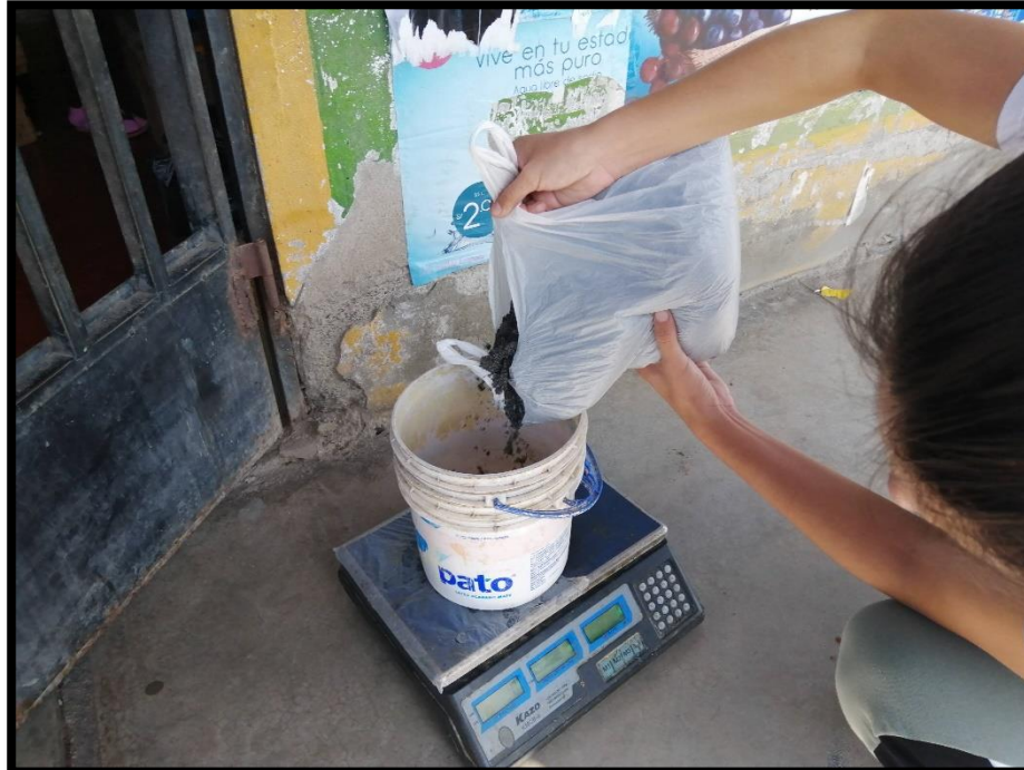
Figura N°12: Preparación y pesado de la mezcla estabilizadora de cenizas de cáscara de arroz más cal.
