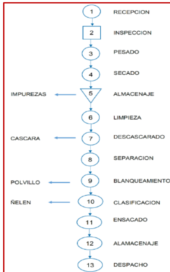
Figura 17. Flujograma del Proceso de Arroz.
