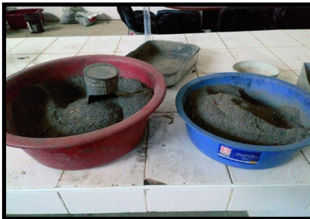
Figura N°99, 100, 101 y 102: Se le añade agua de acuerdo al óptimo contenido de humedad obtenido en el ensayo de Proctor Modificado para cada mezcla. Mezclado de los materiales hasta obtener una muestra homogénea.
