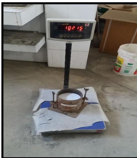
Figura N°113, 114, 115, 116 y 117: Enrasado y limpieza del molde ya con la mezcla compactada. Retirado del disco espaciador. Pesaje de los moldes más mezcla de suelo con ceniza de cáscara de arroz y cal compactados a 12, 26 y 55 golpes.
