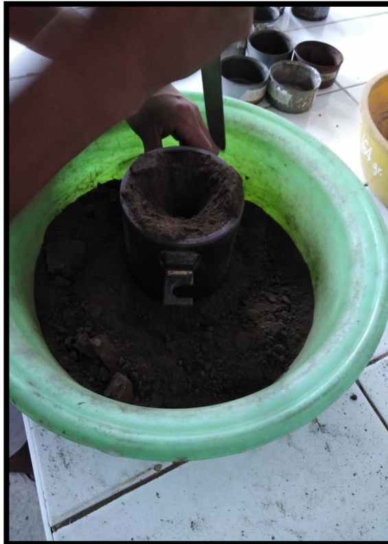
Figura N°88 y 89: Toma de tres muestras de la mezcla compactada para obtener mediante el promedio el óptimo contenido de humedad de cada proctor.
