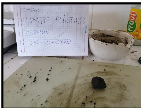
Figura N°66 y 67: No presenta límite plástico las combinaciones del suelo natural más 6%C+10%CCA y 4%C+20%CCA, debido a que carecen de plasticidad.
