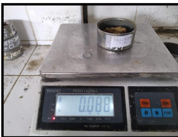
Figura N°46, 47, 48 y 49: Pesaje de las taras y taras más muestra representativa para determinar el contenido de humedad.
