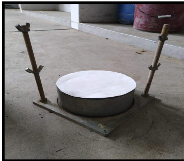
Figura N°108, 109 y 110: Colocación del disco espaciador y el papel filtro antes de realizar la compactación. Además de la colocación de collarín de extensión.
