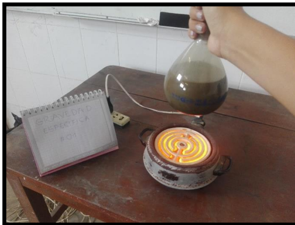
Figura N° 73, 74 y 75: Realización del ensayo para la determinación de la gravedad específica de sólidos de suelo mediante picnómetro de agua (MTC E 113).
