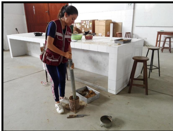
Figura N°111 y 112: Realizando el ensayo de CBR. Compactación del suelo en cinco capas a razón de 12, 26 y 55 golpes con el martillo.
