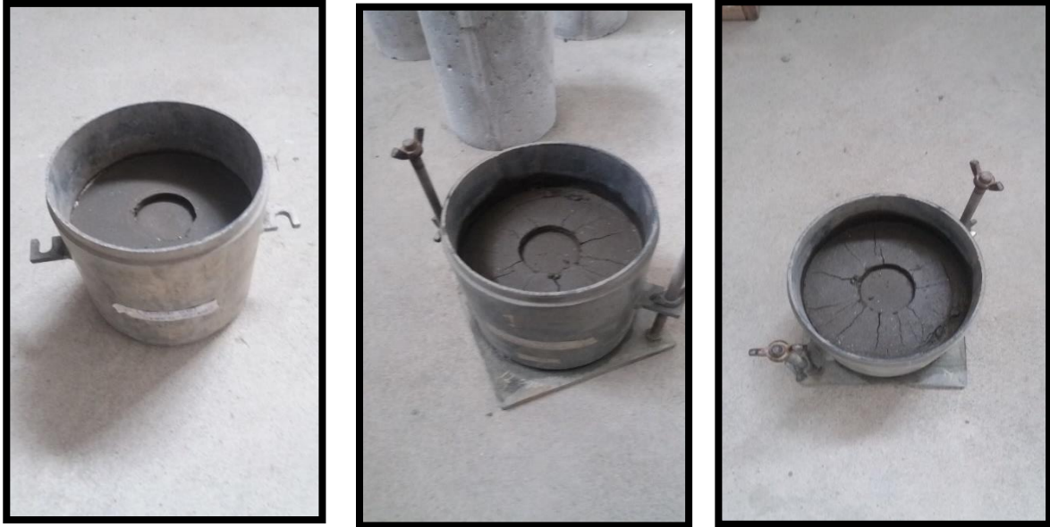
Figura N°130, 131 y 132: Muestras después de la carga de penetración tras el ensayo CBR a 12, 26 y 55 golpes.
