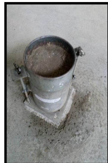
Figura N°111 y 112: Realizando el ensayo de CBR. Compactación del suelo en cinco capas a razón de 12, 26 y 55 golpes con el martillo.
