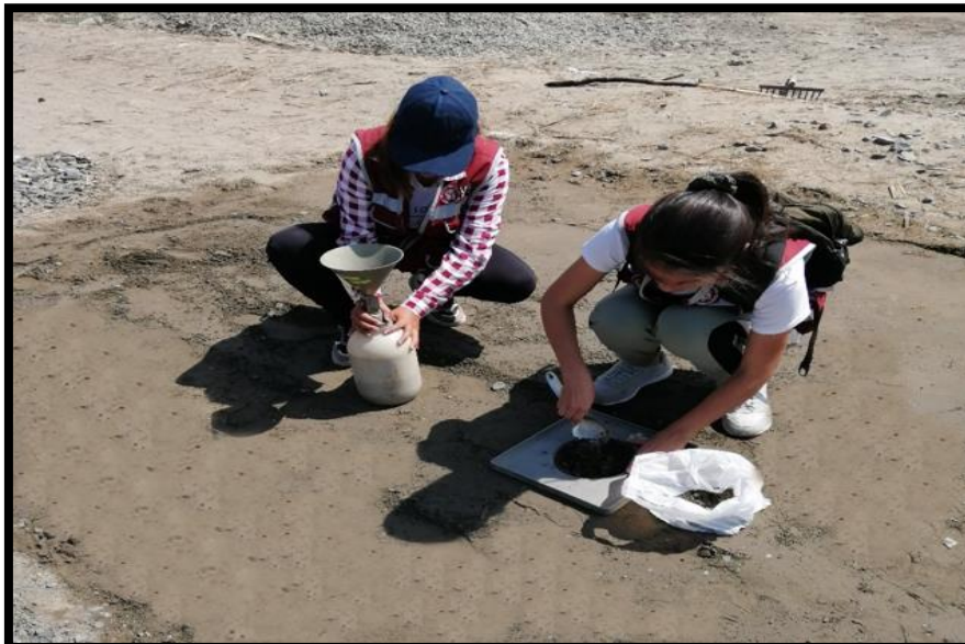
Figura N°28: Realización del ensayo de densidad de campo in situ, en la vía Santa Clemencia – Chachapoyas (MTC E 117).
