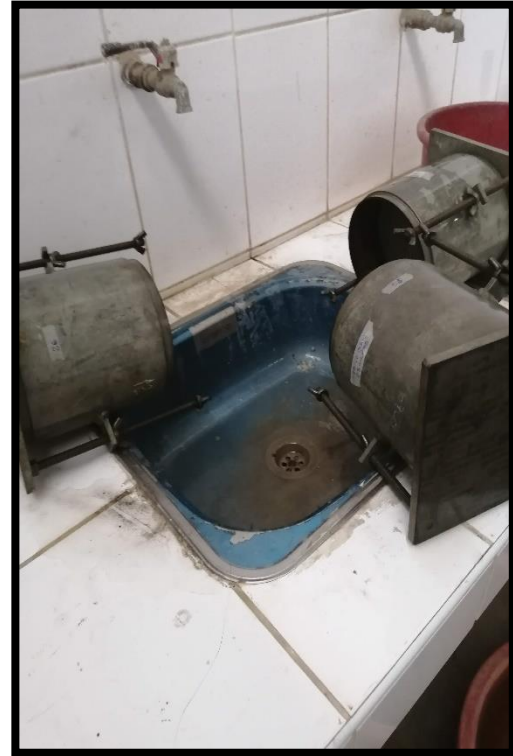
Figura N°122 y 123: Muestras colocadas en forma horizontal, escurriendo por un tiempo de 15 minutos antes de realizar el ensayo de penetración.
