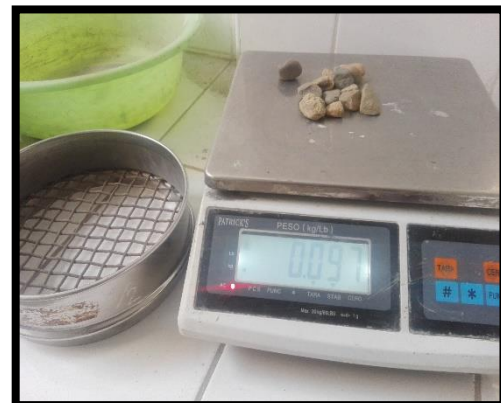
Figura N°53 y 54: Realización del tamizaje empleando 01 tamizadora eléctrica para obtener la curva granulométrica. (MTC E 107).
