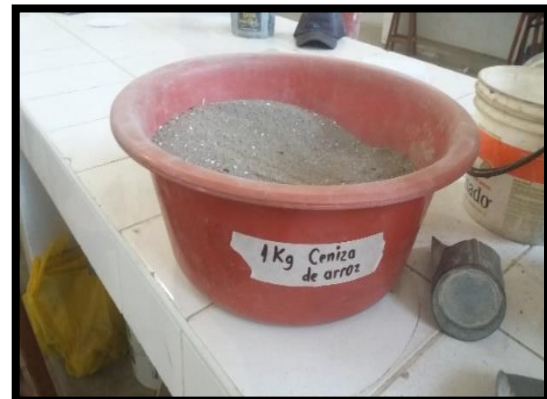
Figura N°78, 79 Y 80: Pesaje de los materiales utilizados para la realización del ensayo Proctor: suelo del lugar de estudio, cenizas de cáscara de arroz y cal.
