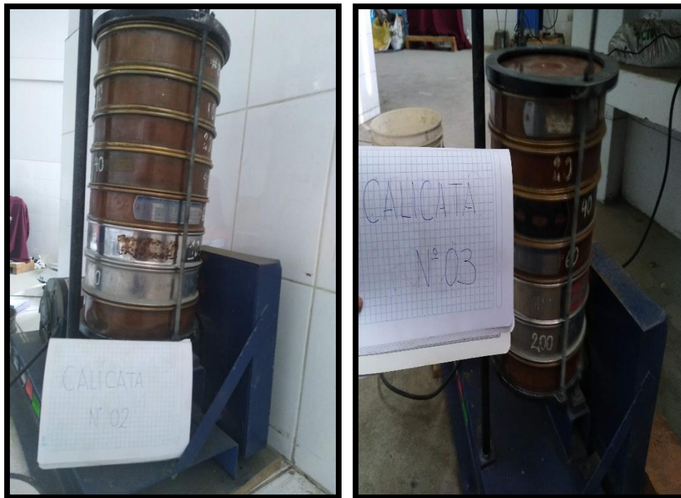
Figura N°53 y 54: Realización del tamizaje empleando 01 tamizadora eléctrica para obtener la curva granulométrica. (MTC E 107).
