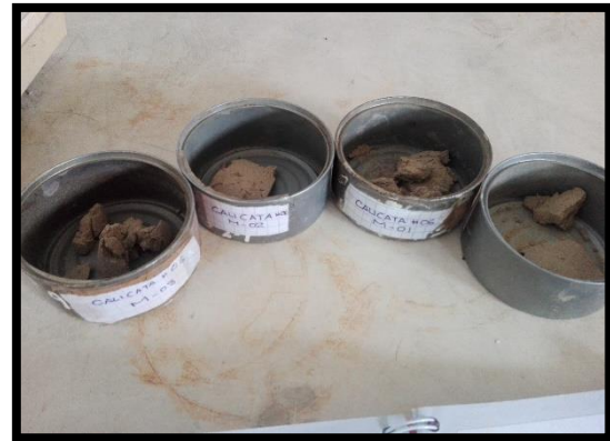
Figura N°63: Muestras obtenidas del límite líquido para determinar su contenido de humedad.
