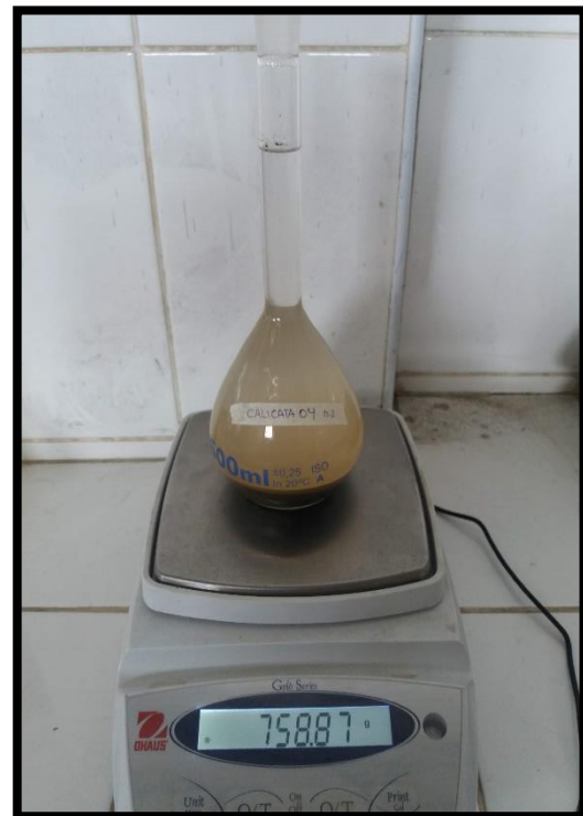
Figura N°76 y 77: Enrasado de los picnómetros con agua destilada posterior al proceso de ebullición y pesaje del mismo.
