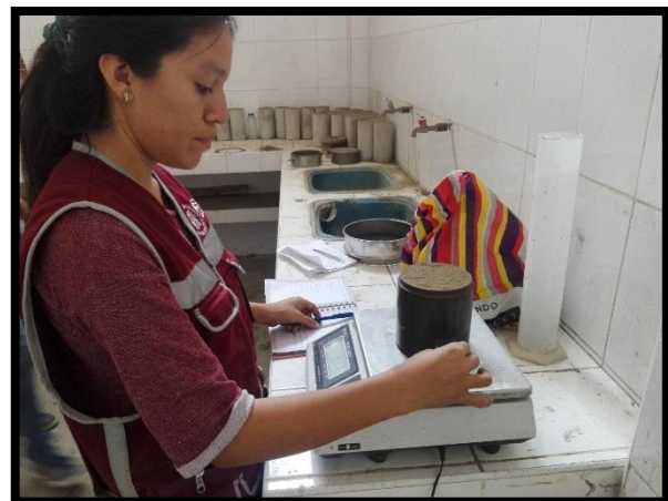
Figura N°85, 86 y 87: Enrasado y limpieza del molde ya con la mezcla compactada. Pesaje del molde más mezcla de suelo con ceniza de cáscara de arroz y cal a diferentes contenidos de humedad.
