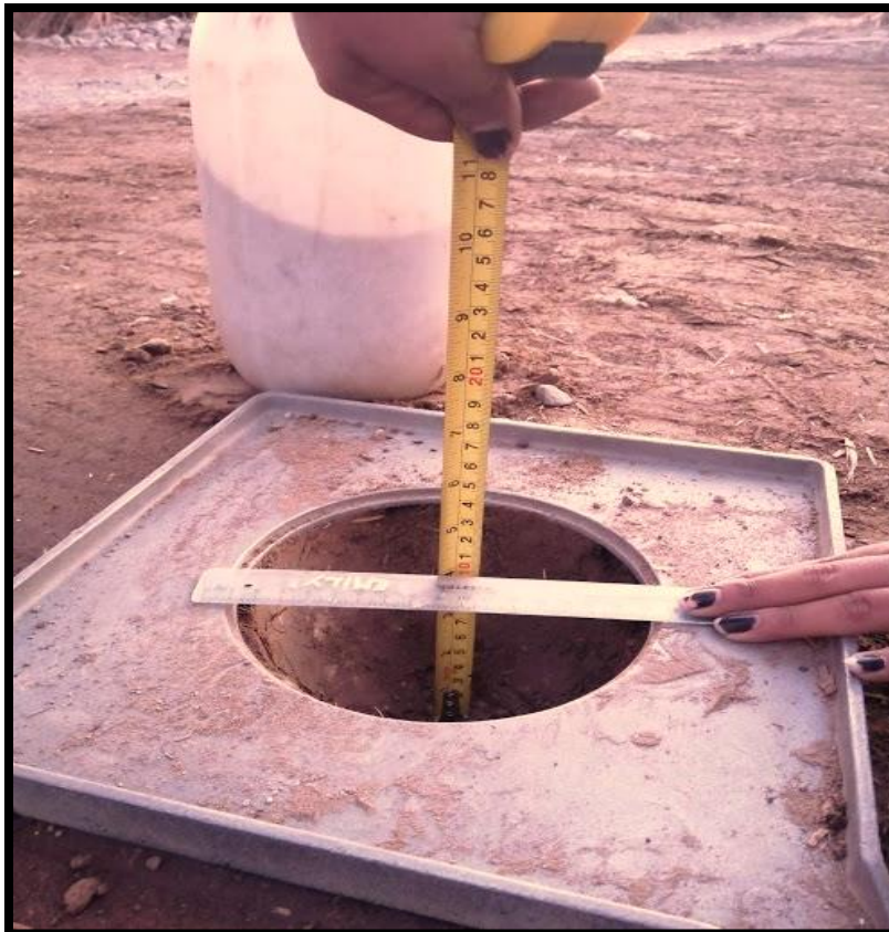
Figura N°31 y 32: Colocación de la placa y perforación del suelo compactado a una profundidad de 15 cm. El material obtenido se coloca en una bolsa plástica para mantener su humedad. Se lleva la muestra al laboratorio y se determina su contenido de humedad.
