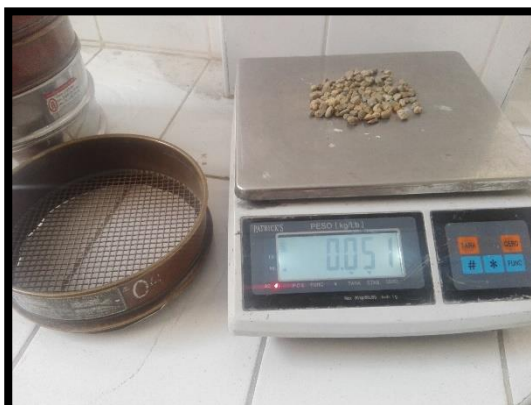
Figura N°55, 56 y 57: Pesaje de la muestra de suelo retenido en los diferentes tamices después del tamizado.
