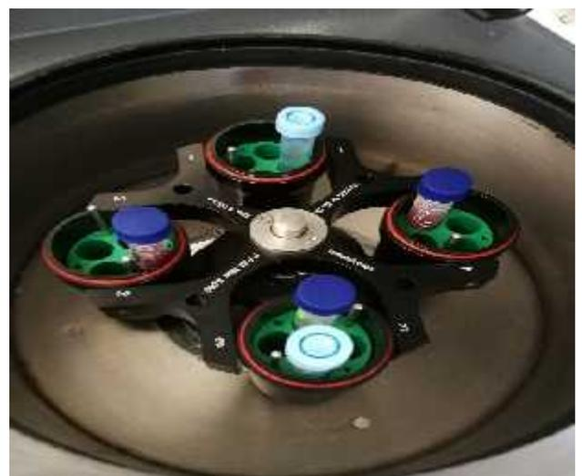
**Figura 22.** Centrifugado a 5000RPM por 10 minutos
