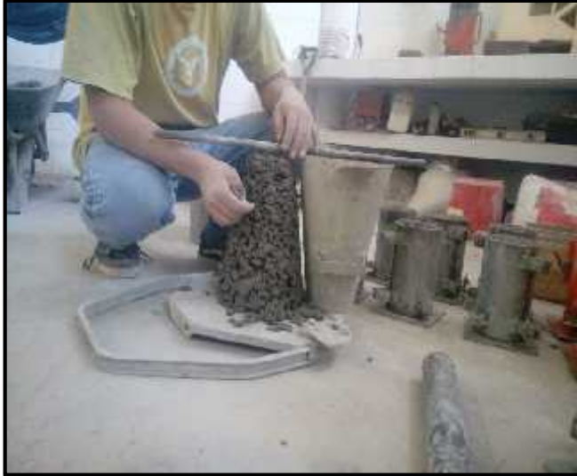
Foto N°20 y N°21: Se realizó la prueba de revenimiento con el cono de abrams (slump) a los diferentes concretos preparados para probar su trabajabilidad y cohesión.
