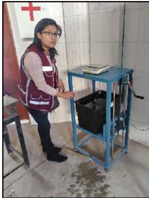
Foto N°10: Elaboración del ensayo de peso específico y absorción del agregado grueso.
