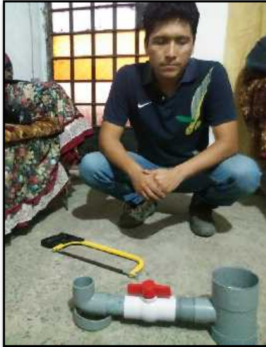
Foto N°48: Se construyó el permeámetro de carga variable para poder medir el coeficiente de permeabilidad.
