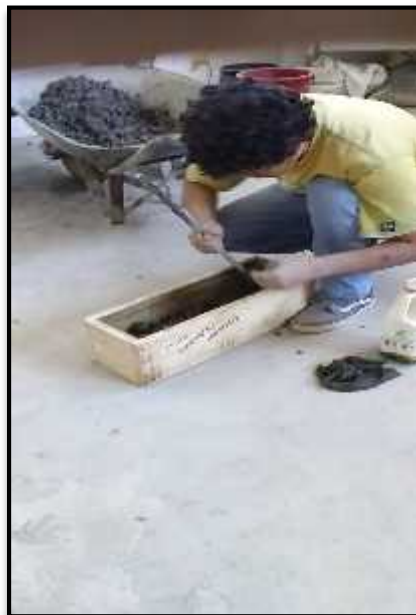
Foto N°42 y N°43: Elaboración de vigas para ensayo de resistencia a la flexión de los diversos concretos permeables.
