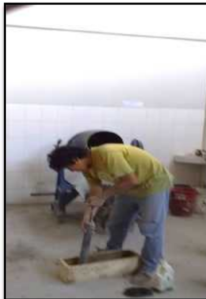
Foto N°42 y N°43: Elaboración de vigas para ensayo de resistencia a la flexión de los diversos concretos permeables.
