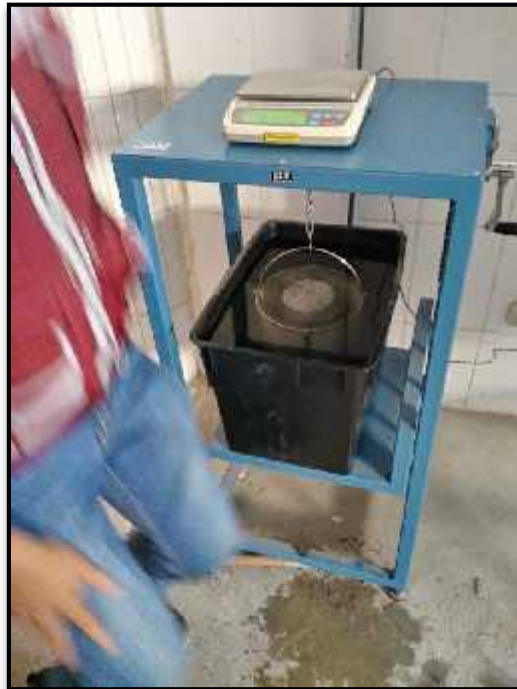
Foto N°40: Para hallar el porcentaje de vacíos del concreto permeable en estado endurecido, se sumergió en agua durante 30 minutos.
