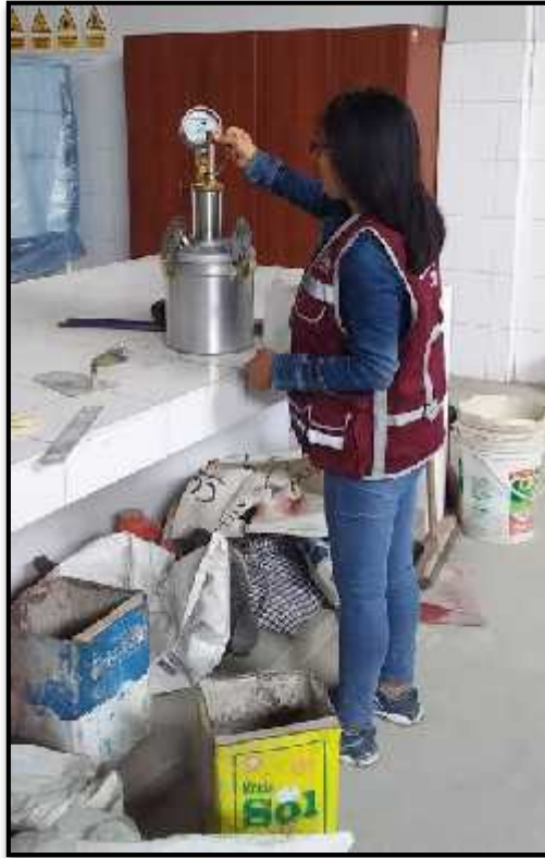
Foto N°25: Se realizó el ensayo para conocer el porcentaje de vacíos de la mezcla en estado fresco con la ayuda de la olla de Washington.
