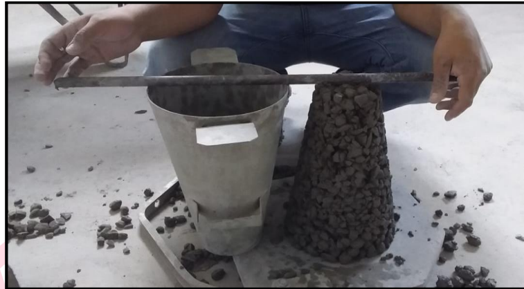
Figura 15. Medida del asentamiento del concreto permeable.
