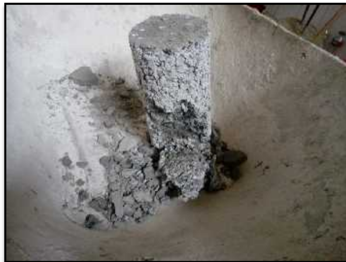
Foto N°33: Rotura de las probetas para conocer la resistencia a la compresión del concreto permeable elaborado con los diversos diseños de mezclas.
