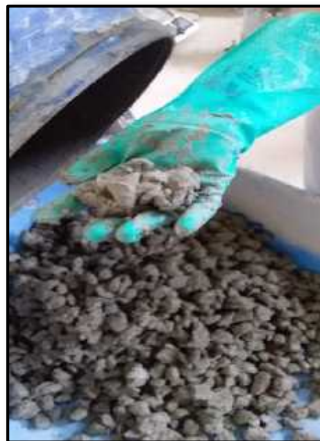
Foto N°18 y N°19: Se realizó la denominada prueba del puño a los diferentes concretos preparados para probar su trabajabilidad y cohesión.
