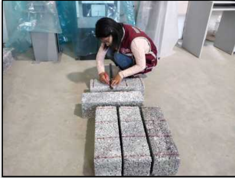
Foto N°44: Para el ensayo de resistencia a la flexión, primero se marcó las vigas de acuerdo a lo establecido en la norma ASTM C78
