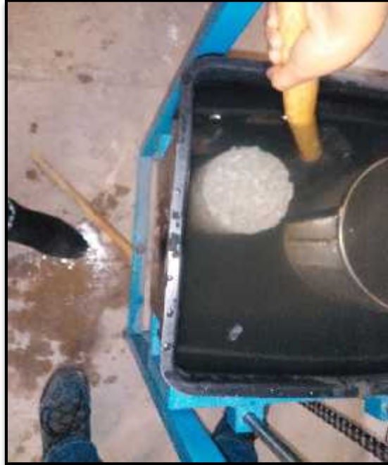
Foto N°41: Para hallar el porcentaje de vacíos del concreto permeable en estado endurecido, se le fue golpeando con el martillo para eliminar el aire atrapado en su interior, para posteriormente pesarse.
