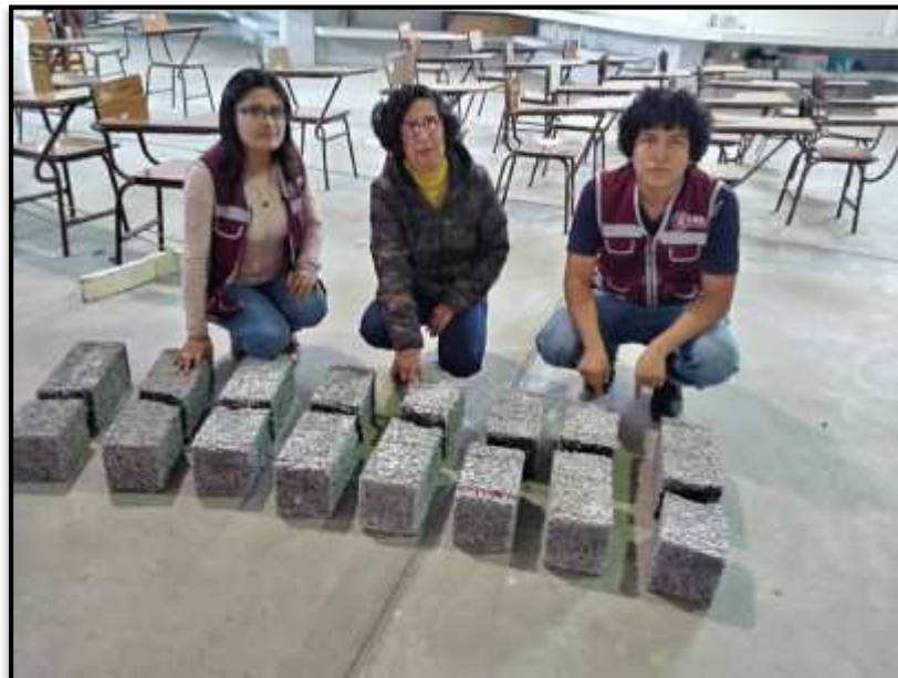
Foto N°47: Vigas después de realizado el ensayo, se tiene que observar si la rotura se presentó dentro del tercio medio de la luz o fuera de este.
