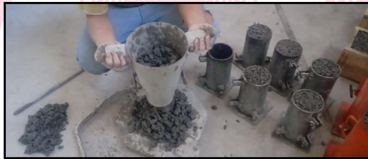
Figura 16. Prueba del cono invertido.
