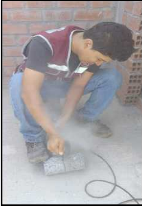
Foto N°34: Para el ensayo de resistencia al desgaste por abrasión las probetas de 10 x 20 cm se cortaron en dos mitades de 10 x 10 cm.
