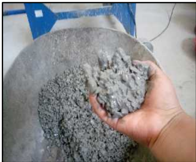
Foto N°18 y N°19: Se realizó la denominada prueba del puño a los diferentes concretos preparados para probar su trabajabilidad y cohesión.
