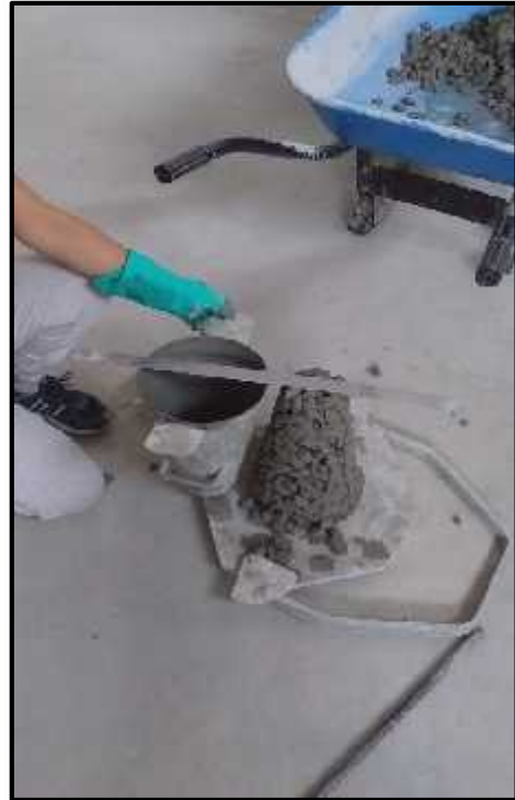
Foto N°20 y N°21: Se realizó la prueba de revenimiento con el cono de abrams (slump) a los diferentes concretos preparados para probar su trabajabilidad y cohesión.
