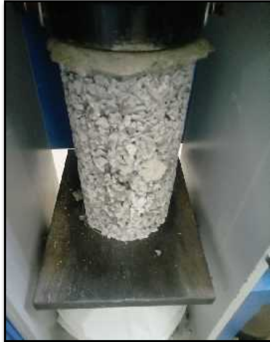
Foto N°31 y N°32: Rotura de las probetas para conocer la resistencia a la compresión del concreto permeable elaborado con los diversos diseños de mezclas.
