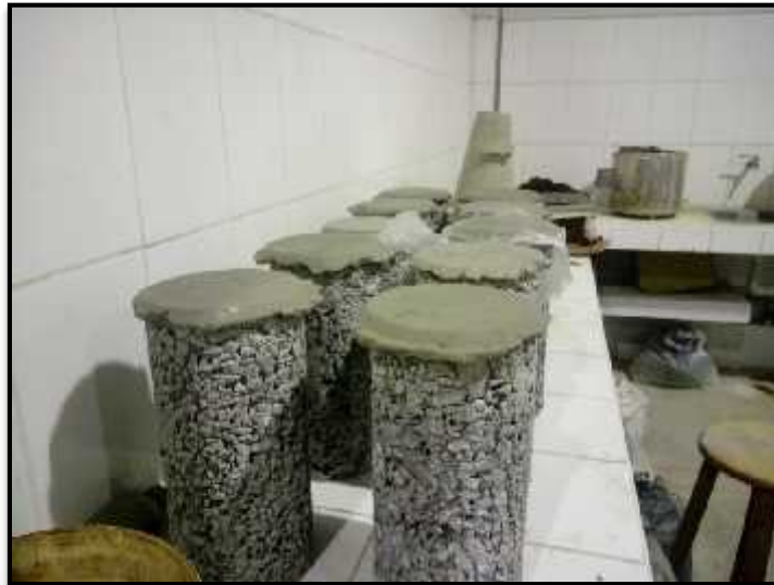
Foto N°30: Elaboración de refrentado (capping) previo a realizar el ensayo de resistencia a la compresión.
