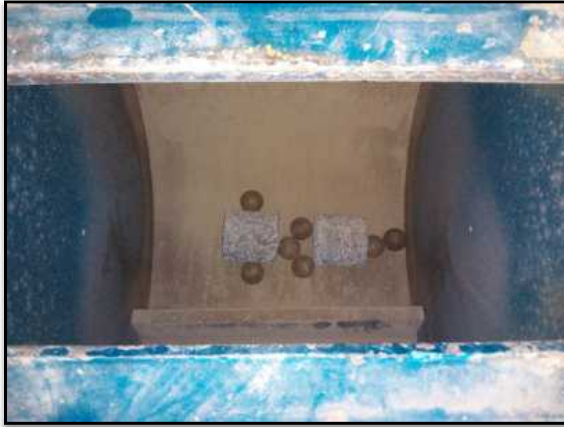
Foto N°36: Se colocaron las dos mitades de la probeta cortada más las bolas de acero que representaron a la carga abrasiva dentro de la máquina de abrasión de los ángeles.
