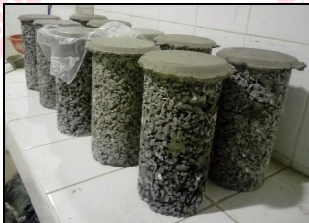
Figura 18. Capping de probetas cilíndricas para ensayo a compresión.
