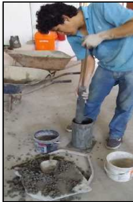
Foto N°28: Elaboración de probetas para ensayo de resistencia a la compresión de los diversos concretos permeables.
