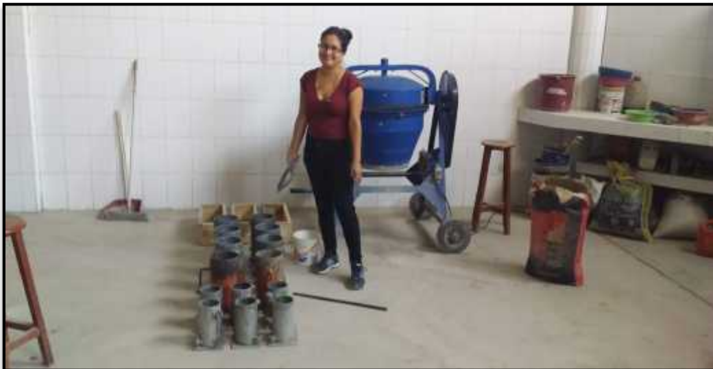
Foto N°26: Se preparó los moldes para el vaciado del concreto permeable y poder realizar los ensayos al concreto en estado endurecido.
