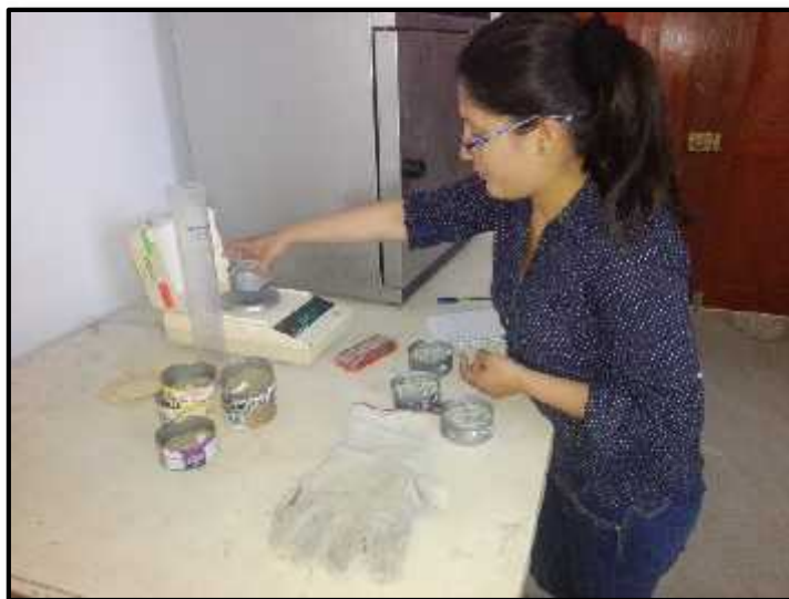
Foto N°13: Elaboración del ensayo de contenido de humedad de los agregados.
