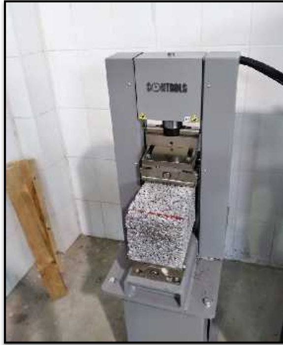
Foto N°46: Una vez colocada la viga de manera correcta según las marcas realizadas, se procedió a aplicar la carga y romper la viga para conocer la carga máxima aplicada y con esta la resistencia a la flexión.
