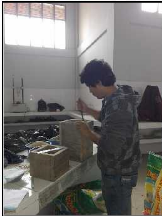
Foto N°12: Elaboración del ensayo de peso unitario suelto y compactado de los agregados utilizados en la elaboración de concreto permeable.
