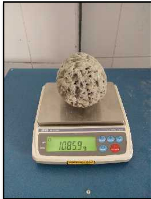
Foto N°37 y N°38: Se puede apreciar en la imagen el elemento de prueba antes y después de ser sometida a la carga abrasiva dentro de la máquina de los ángeles.
