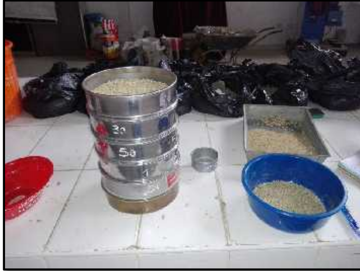
Foto N°09: Elaboración de la granulometría de los agregados utilizados en la elaboración de concreto permeable.
