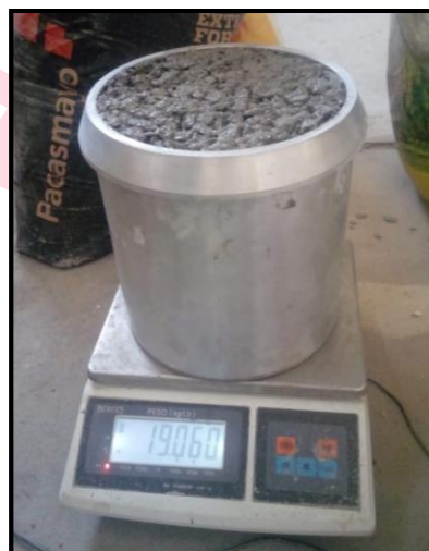
Figura 17. Olla de Washington compactada listo para su pesaje.
