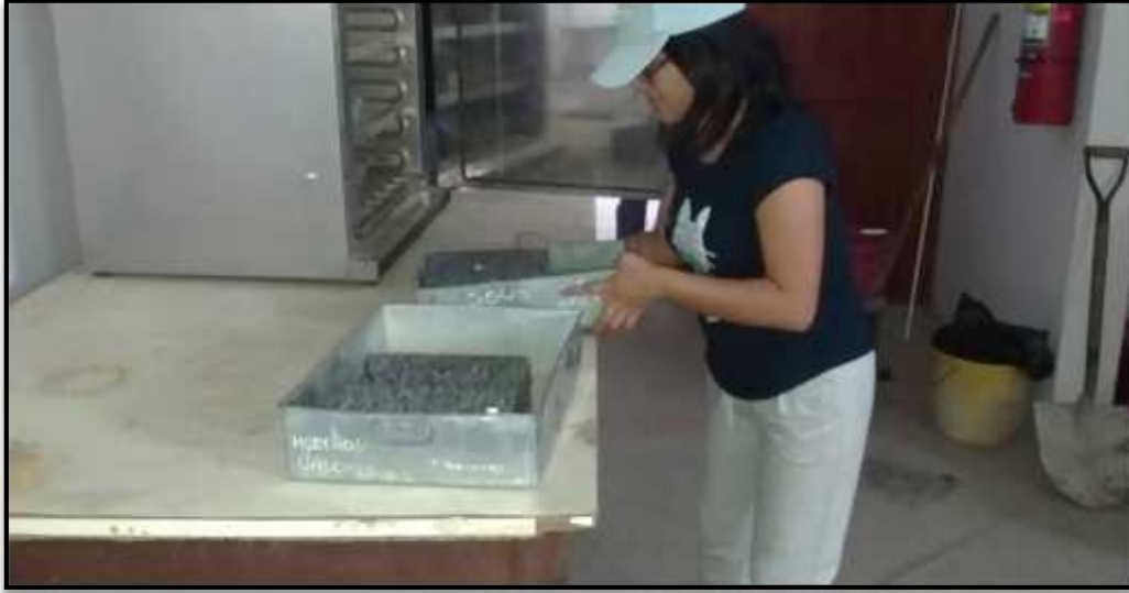
Foto N°39: Para hallar la densidad del concreto permeable en estado endurecido, primero se colocó las probetas dentro del horno, para posteriormente pesarlas estando secas.
