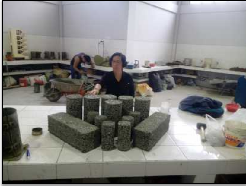
Foto N°27: Se preparó probetas de 15 x 30 cm, probetas de 10 x 20 cm y vigas de 15 x 15 x 50 cm, para cada diseño de mezclas para poder realizar los ensayos en estado endurecido.
