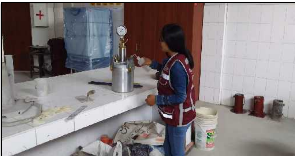
Foto N°24: Se realizó el ensayo para conocer el porcentaje de vacíos de la mezcla en estado fresco con la ayuda de la olla de Washington.
