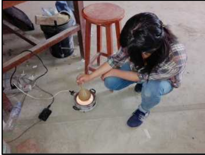
Foto N°11: Elaboración del ensayo de peso específico y absorción del agregado fino.
