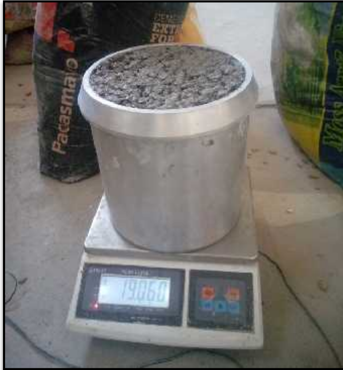
Foto N°23: Se realizó el ensayo para conocer el peso unitario del concreto permeable en estado fresco con la ayuda de la olla de Washington.
