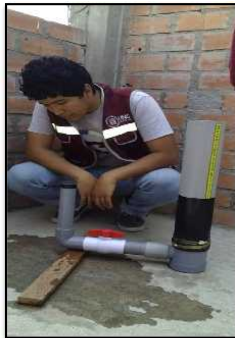
Foto N°51: Para hallar el coeficiente de permeabilidad se controló el tiempo que tarda el agua en salir por el otro tubo del permeámetro, este ensayo se realizó para el concreto permeable elaborado con todos los diseños de mezclas.
