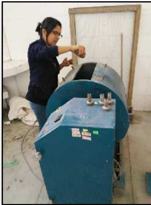
Foto N°35: Se colocaron las dos mitades de la probeta cortada más las bolas de acero que representaron a la carga abrasiva dentro de la máquina de abrasión de los ángeles.
