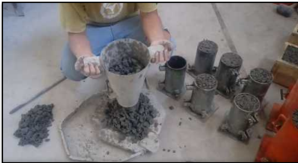
Foto N°22: Se realizó la prueba del cono invertido a los diferentes concretos preparados para probar su trabajabilidad y si existe o no segregación.
