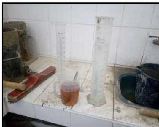
Foto N°14 y N°15: Se pesó los materiales a utilizarse, agregado grueso, agregado fino, cemento, agua y aditivo, de acuerdo a los resultados obtenidos en los diseños de mezcla.
