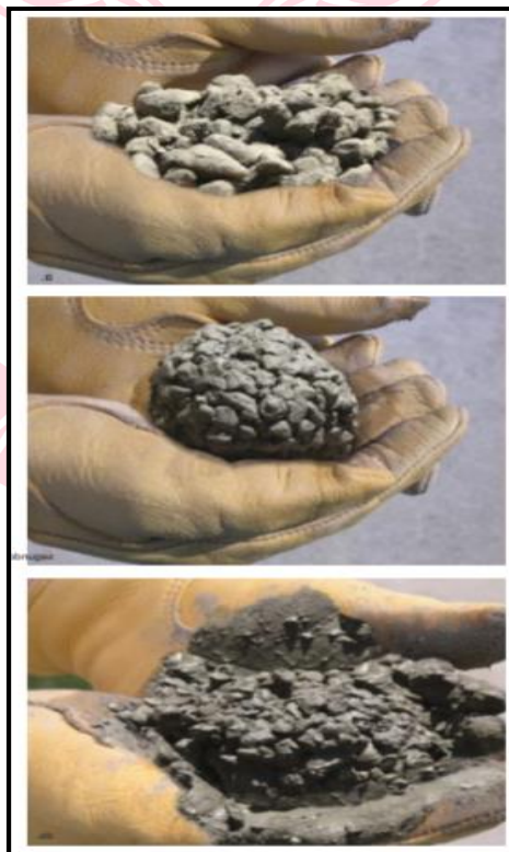
Figura 14. Diferentes contenidos de agua, a) poca agua, b) cantidad apropiada de agua, c) demasiada agua
