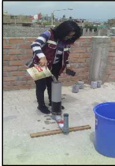
Foto N°50: Se colocó la probeta dentro del permeámetro, se ajustó al tubo con abrazaderas y jebes para evitar fugas, y se procedió a echar agua.
