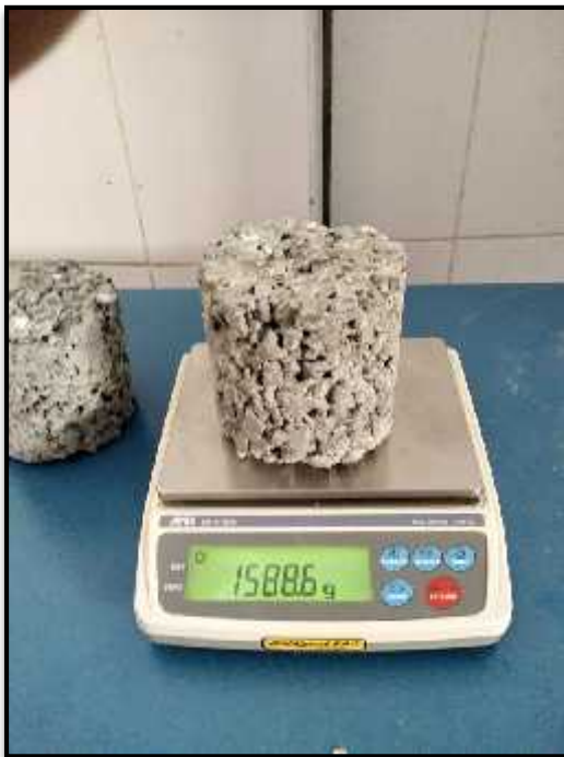
Foto N°37 y N°38: Se puede apreciar en la imagen el elemento de prueba antes y después de ser sometida a la carga abrasiva dentro de la máquina de los ángeles.
