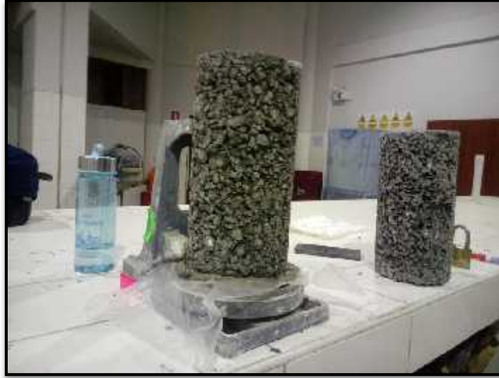
Foto N°29: Elaboración de refrentado (capping) previo a realizar el ensayo de resistencia a la compresión.
