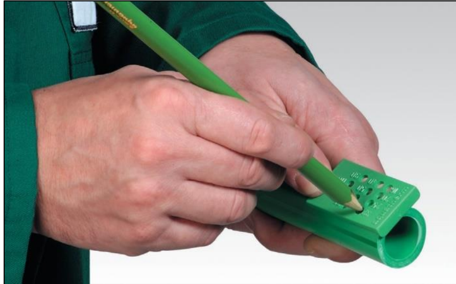
Figura 5: Marcado de la profundidad de soldadura. Fuente: (Manual Aquatherm Green Pipe, 2017)
