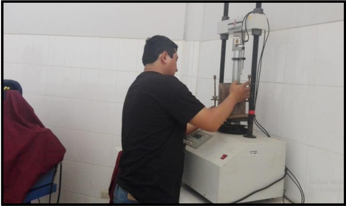
Fotografía 29. Ubicación del molde en la prensa para la obtención de la carga de la muestra seca
