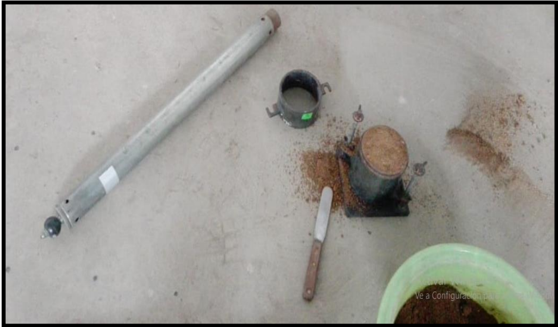
Fotografía 13. Equipos utilizados para desarrollar la caracterización mecánica del suelo extraído (Ensayo Proctor Modificado)
