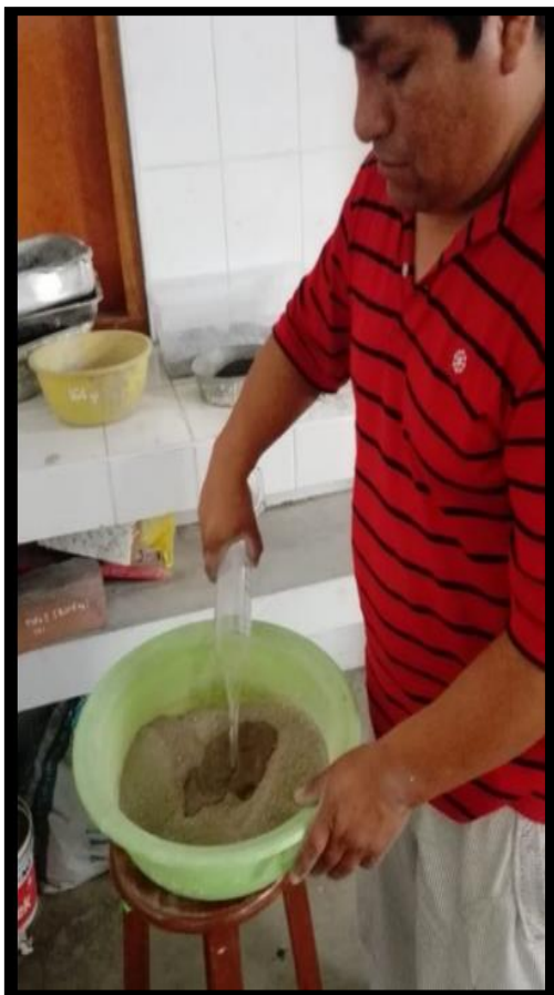
Fotografía 15. Adición de agua para la humidificación de la mezcla de acuerdo a la necesidad de la mezcla
