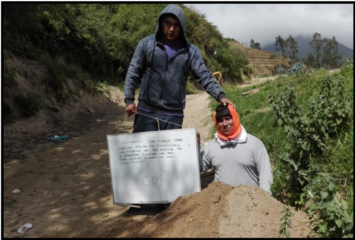
Fotografía 5. Excavación para la toma de muestra de suelo de la calicata 04
