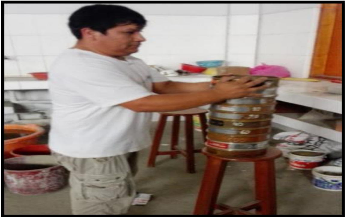
Fotografía 9. Desarrollo del análisis granulométrico de la muestra extraída mediante el juego de tamices (MTC 107)
