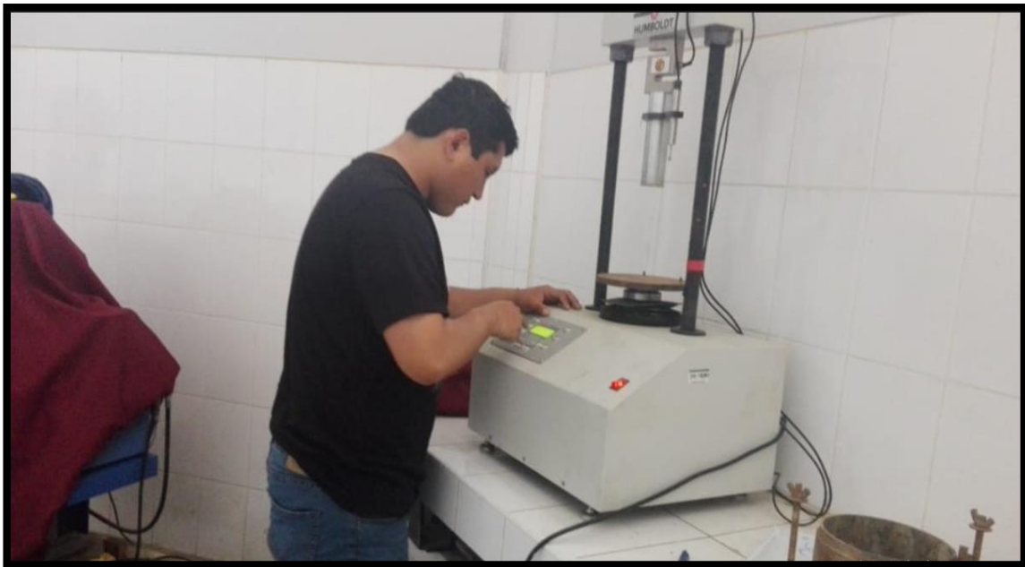
Fotografía 30. Relación de soporte de california para la mezcla de suelo natural y la dosificación de 2.5% de cal
