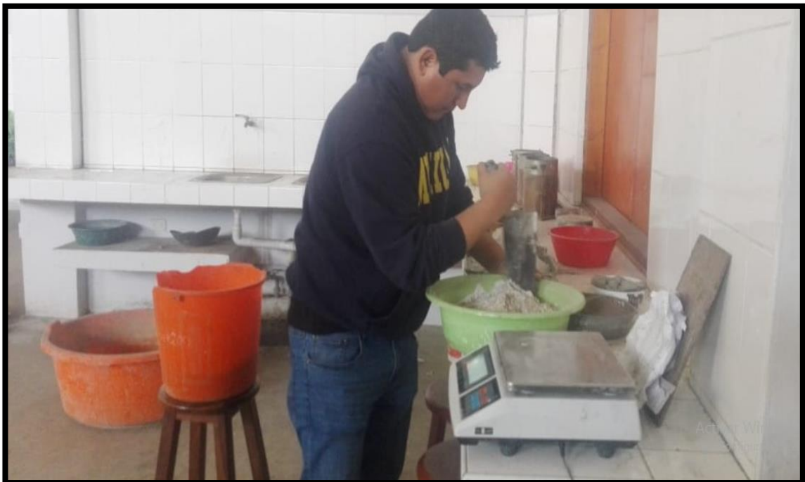
Fotografía 24. Preparación de la mezcla para su respectiva compactación de las capas
