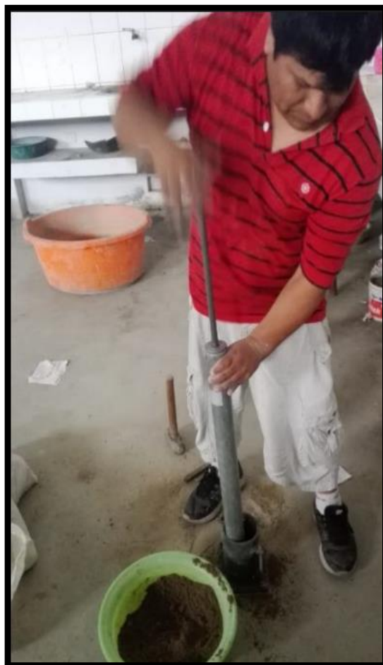
Fotografía 16. Ensayo de compactación para la mezcla en 3 capas de 25 golpes a través del pisón manual
