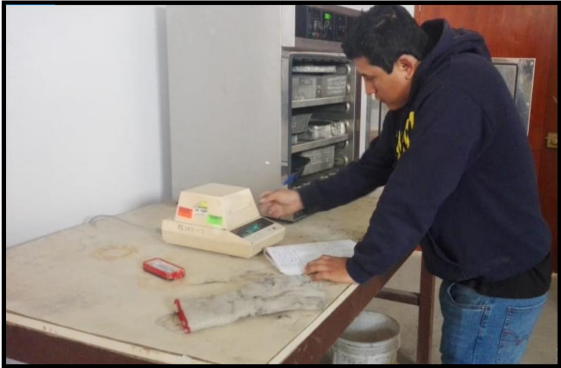
Fotografía 27. Pesaje de las taras con la muestra húmeda para su posterior introducción al horno
