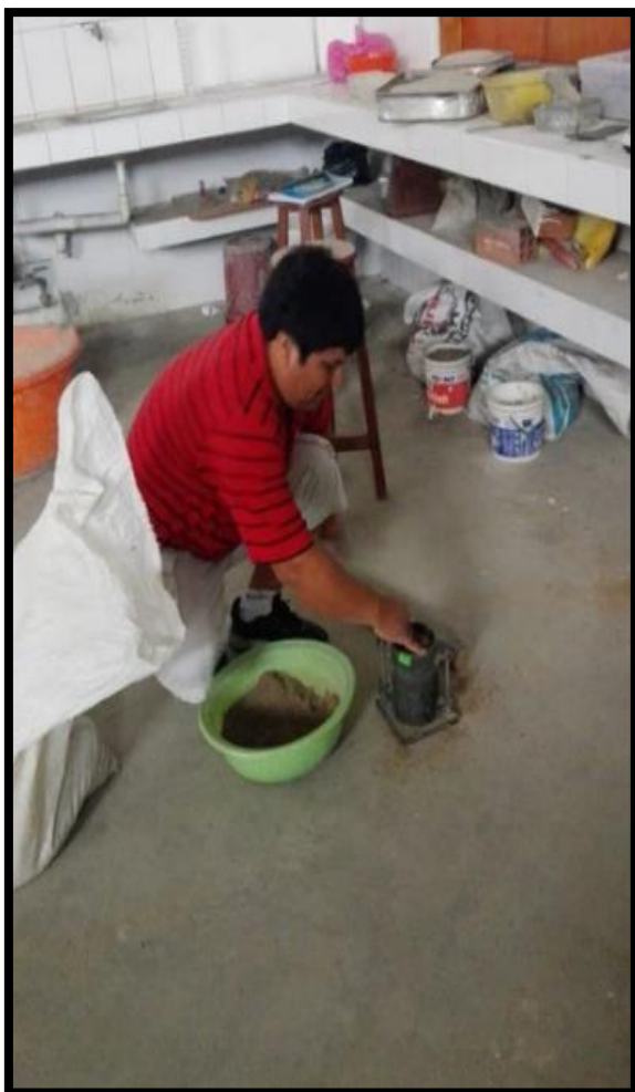
Fotografía 17. Enrasado del molde con mezcla de suelo y cenizas volátiles de cascarilla de arroz para su posterior pesado
