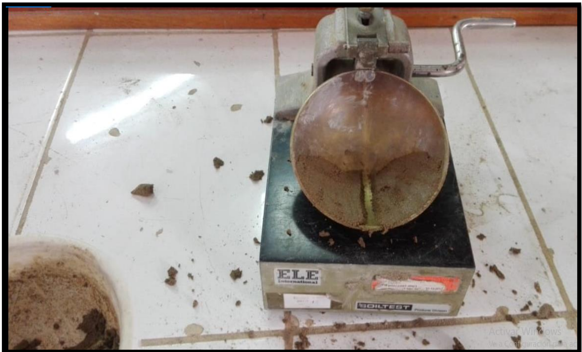
Fotografía 12. Determinación del límite líquido y límite plástico del suelo extraído de la carretera en estudio
