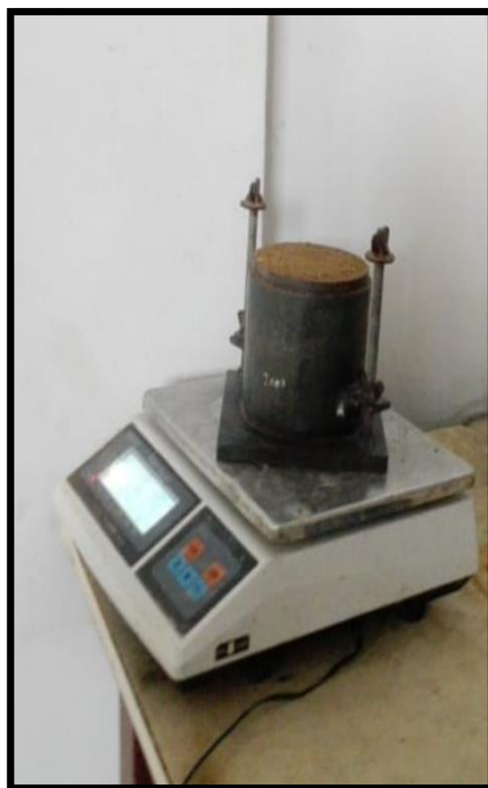
Fotografía 18. Pesado de la mezcla compactada de suelo y cenizas volátiles de cascarilla de arroz
