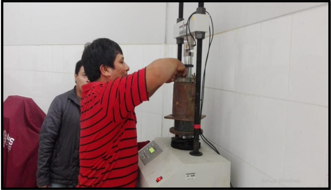
Fotografía 19. Ubicación del molde con la mezcla de suelo y cenizas volátiles de cascarilla de arroz en el equipo
