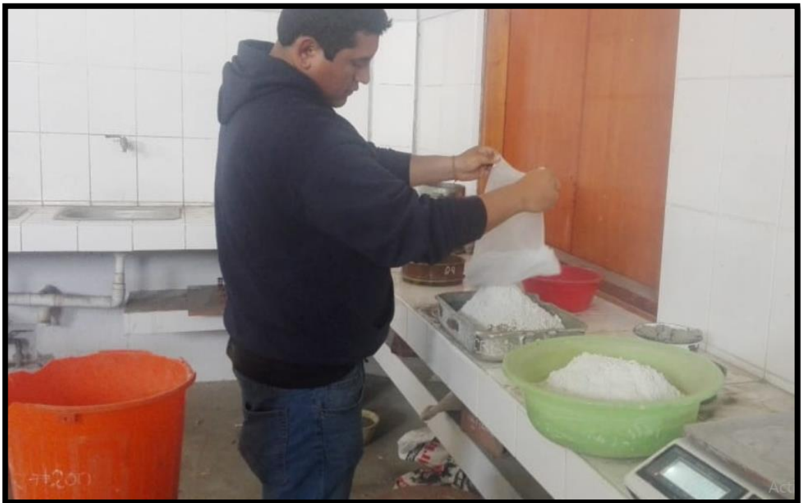
Fotografía 26. Adición de cal al 2.5% de proporción con respecto al suelo natural
