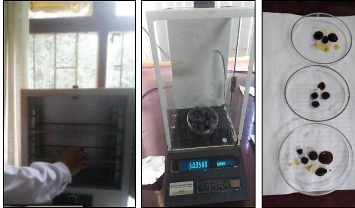
*Figura 19:* Determinación de Humedad de las materias primas
