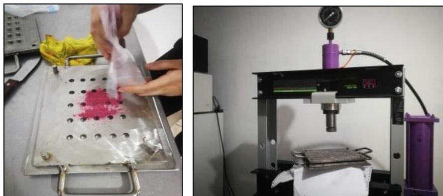
**Figura 15:** Compresión de los tratamientos liofilizados mediante una prensa hidráulica.
