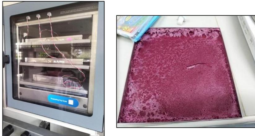
**Figura 13:** Secado de los tratamientos elaborados por liofilización.
