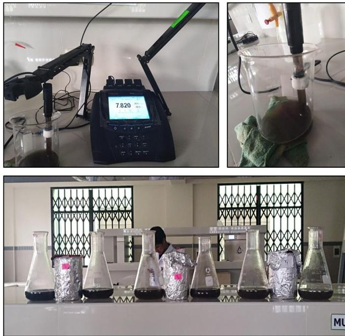
**Figura 22:** Determinación de Acidez Titulable de las materias primas
