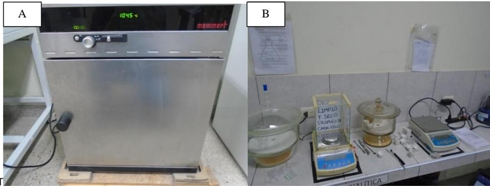
**Figura 48.** (a) Estufa utilizada para secar la biomasa colocada en los crisoles. (b) Pesado de los crisoles con la biomasa seca.
