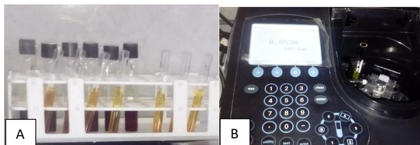
**Figura 40.** A) Muestras analizadas para azúcares reductores por el método de DNS. B) Espectrofotómetro UV-Vis empleado en la lectura de absorbancia.
