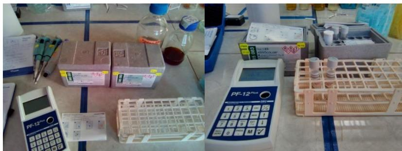
**Figura 44.** Implementos y kit para realizar el test de nitrógeno total.
