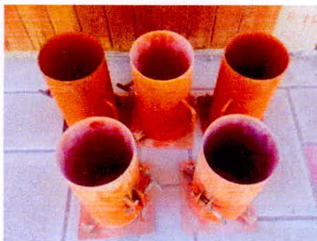
Figura 19: Instrumentos de laboratorio para hallar la resistencia del concreto
