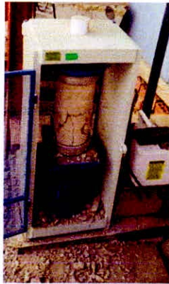
Figura 7: Probeta de concreto reciclado ensayada a los 28 días de curado
