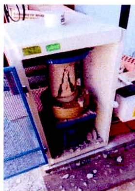
Figura 6: Probetas de concreto reciclado ensayadas a los 14 días de curado
