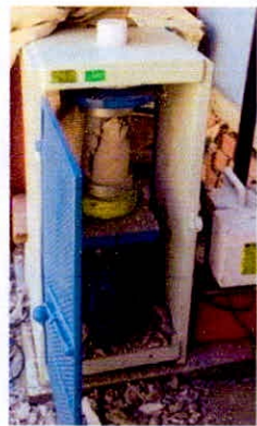
Figura 11: Probeta de concreto natural ensayada a los 14 días de curado
