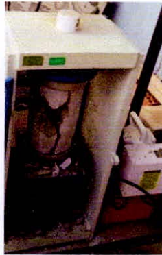
Figura 10: Probeta de concreto natural ensayada a los 7 días de curado
