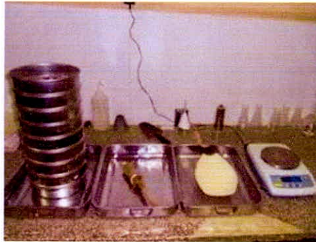
Figura 15: Instrumentos de laboratorio para hallar el peso específico
