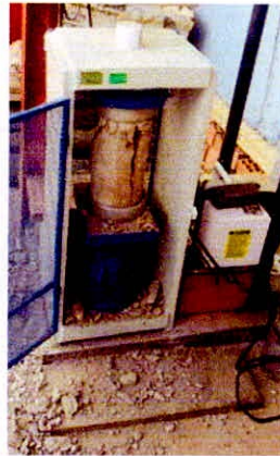
Figura 4: Probetas de concreto reciclado ensayada a los 7 días de curado
