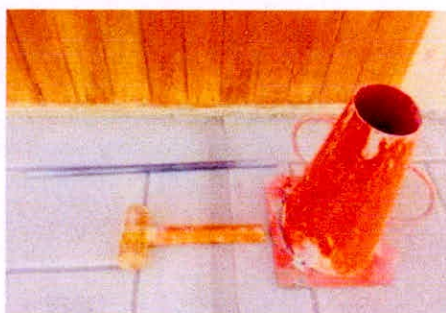
Figura 18: Instrumentos de laboratorio para hallar el asentamiento
