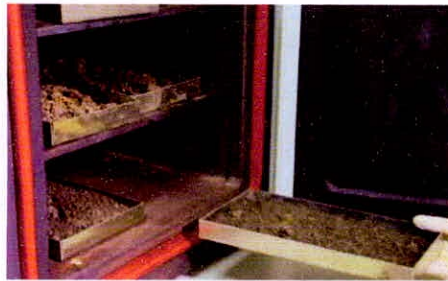
Figura 16: Instrumento de laboratorio para hallar el contenido de humedad
