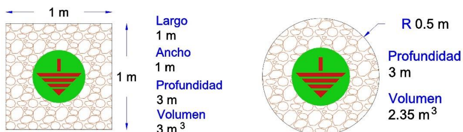
Figura 29.- Vista superior del pozo a tierra vertical clásico (lado izquierdo) y vista superior de un pozo a tierra de radio 0.5 m (lado derecho)
