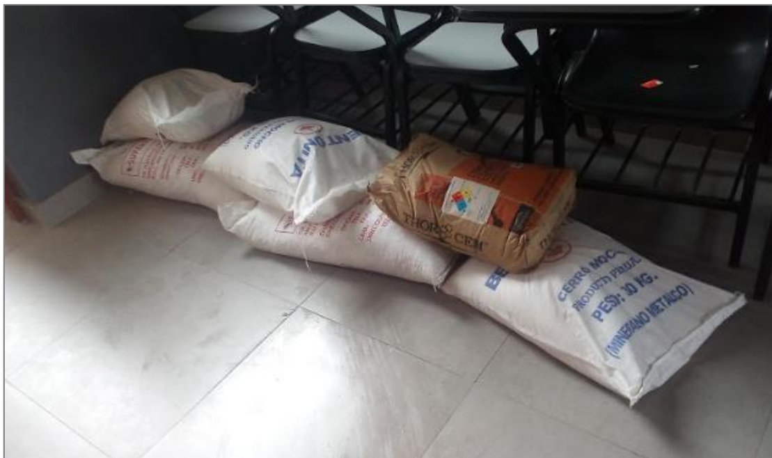
Figura N°6.- Almacenamiento de los materiales a usar en el experimento en campo: 01 bolsa de cemento conductor Thor Cem de 25kg , 03 bolsas de bentonita de 30 kg y 02 bolsas de sal industrial de 50 kg.
