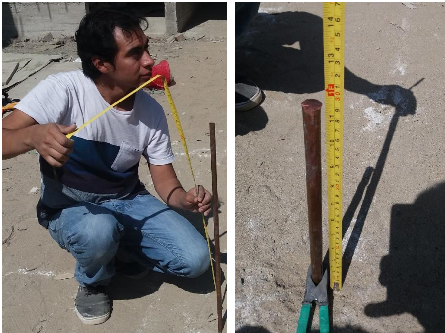
Figura N°10.- Variación de la resistencia cuando varía la longitud enterrada del electrodo
