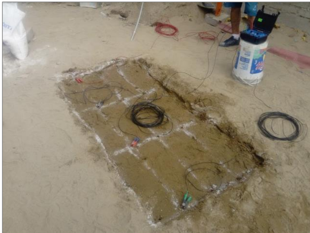
Figura N o 14.- Medición de resistividad con el Teluometro Megabras para la prueba de bentonita.
