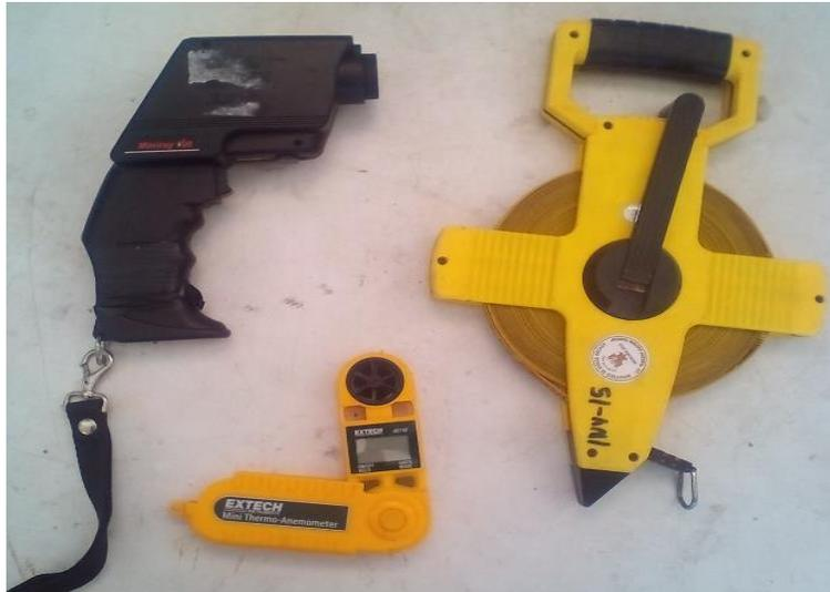
*Figura N° 4:* Instrumentación utilizada para la toma de datos. Arriba izq: Pirometro center 350. Derecha: Flexometro. Inf: Anemometro EXTECH.
