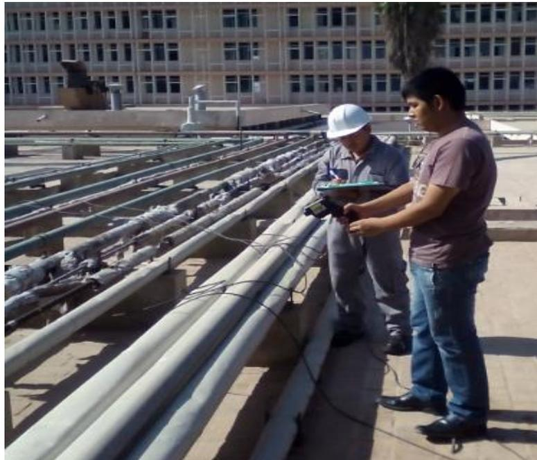
*Figura N° 5:* Toma de temperaturas en la red de vapor usando el pirómetro center 350.
