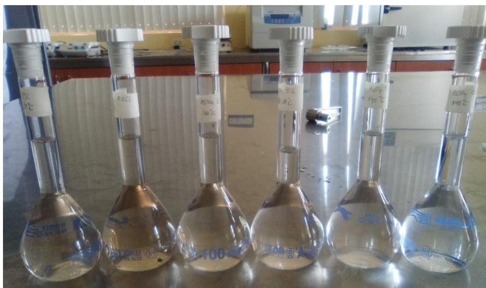
**Figura 12.** Preparación de ácido sulfúrico diluido a diferentes concentraciones.
