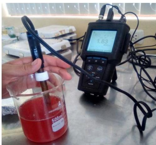
**Figura 16.** Ajuste de pH del medio hidrolizado del raquis.
