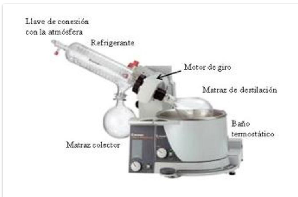
**Figura 6.** Equipo de destilación al vacío. Fuente: Barroso, 2010.
