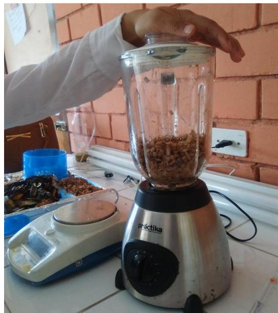
**Figura 11.** Tratamiento mecánico (trituración) de las muestras de raquis.
