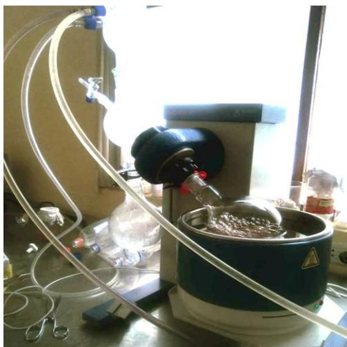
**Figura 17.** Destilación del medio fermentado mediante un rotavapor.
