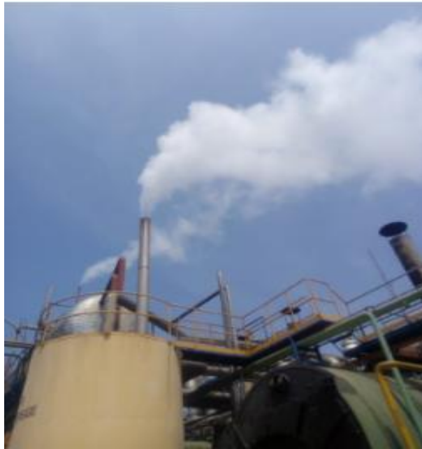
Figura 1: Venteo de vapor flash en el tanque de condensados en la planta Copeinca Chancay
