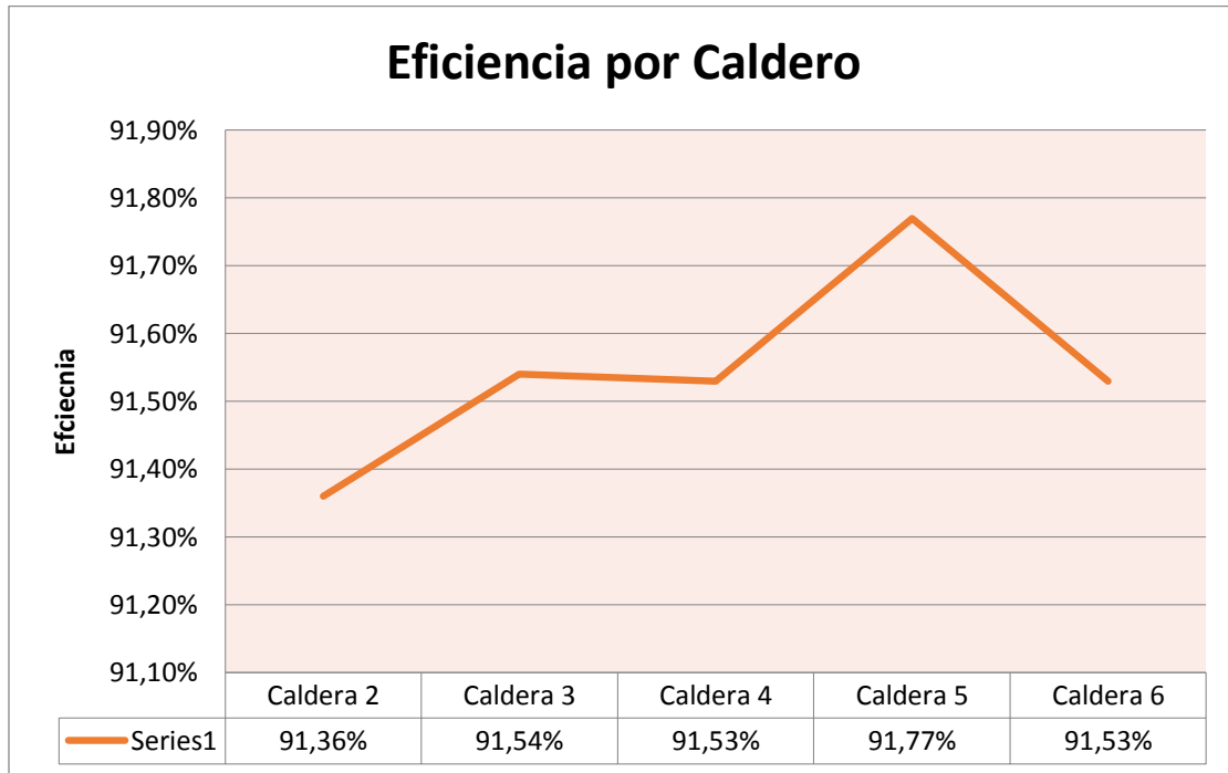
Figura 24: Eficiencias máxima y mínima de las cinco calderas pirotubulares de la planta de vapor.
