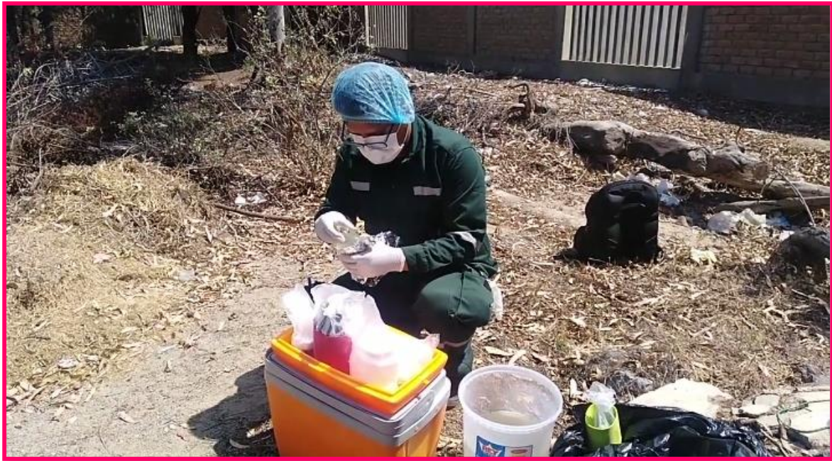
Figura N° 35: Recolección y recubrimiento de las muestras de las aguas residuales para su posterior traslado a los laboratorios de COLECBI.
