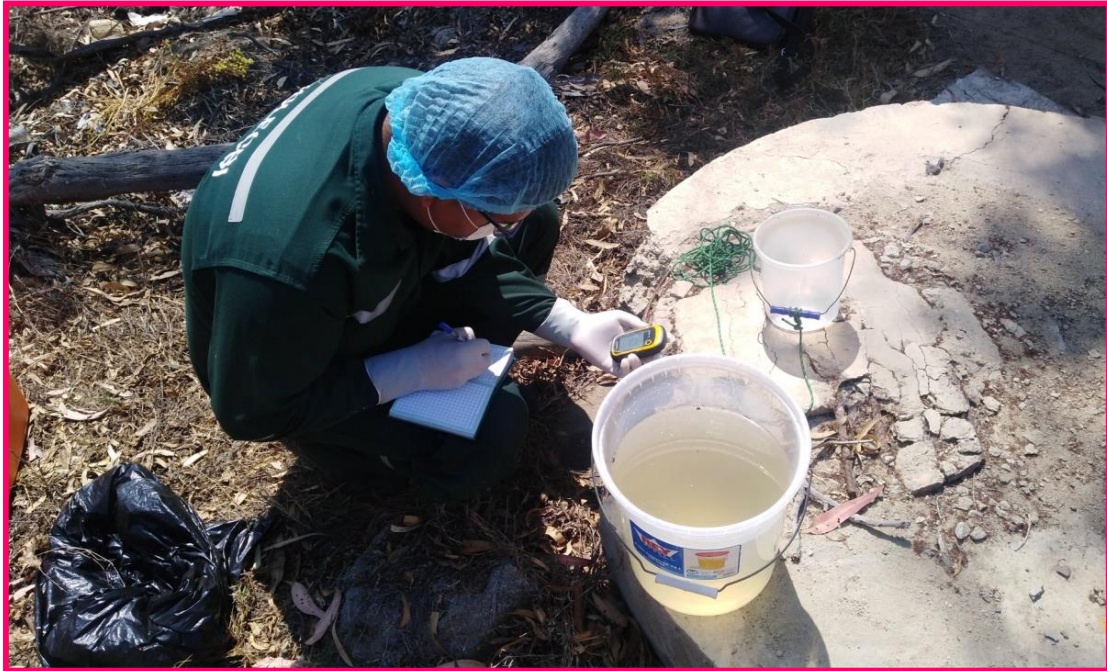
Figura N° 33: Medición de la temperatura del agua residual.
