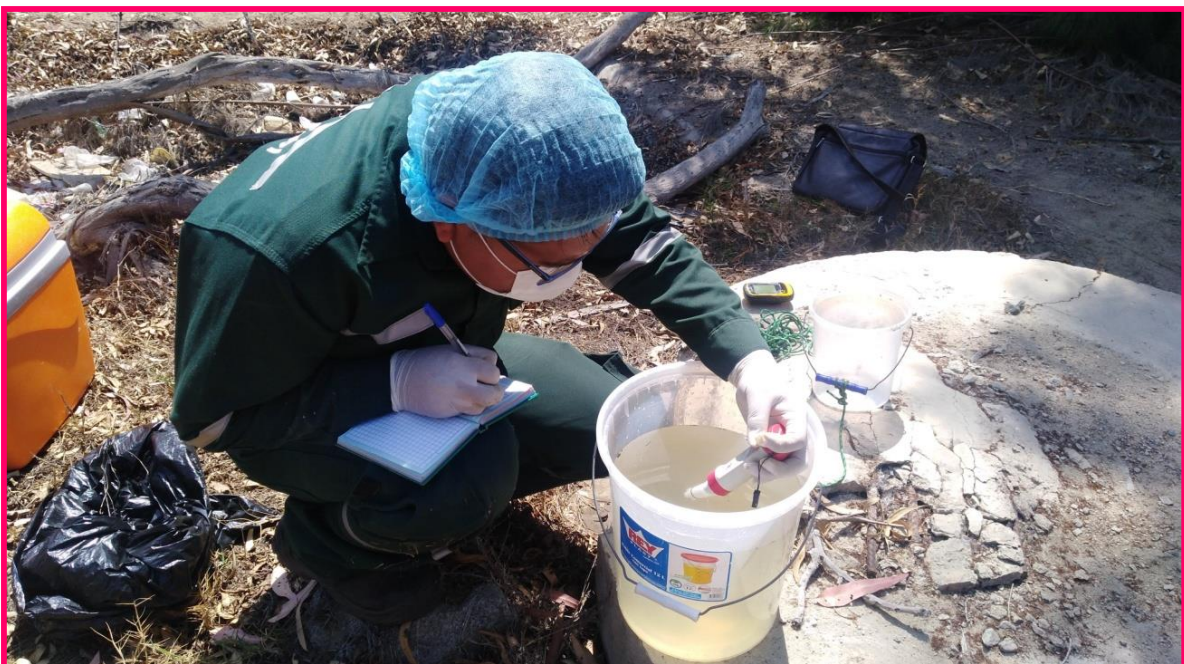
Figura N° 34: Medición del pH del agua residual.
