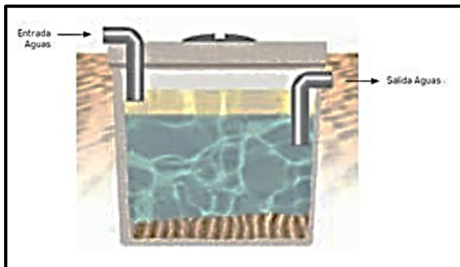
Figura N° 05: Esquema del desengrasado del agua servida
