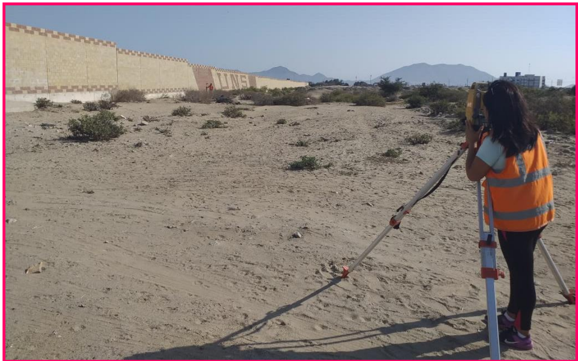
Figura N° 36: Levantamiento topográfico de la Zona de estudio, con estación total.
