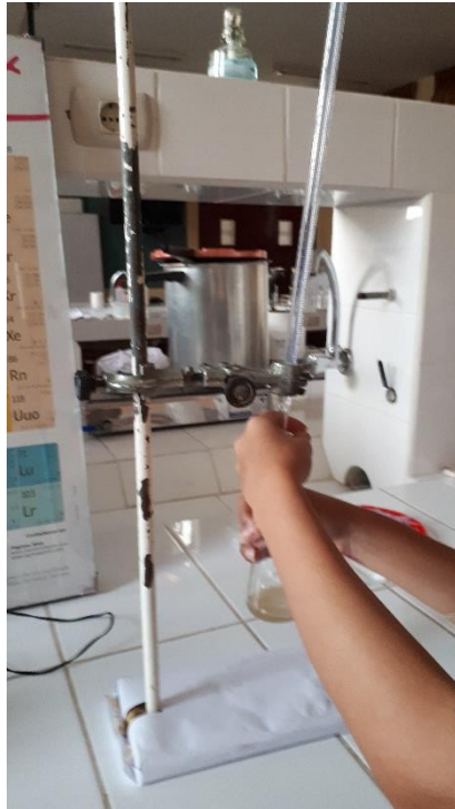
Figura 38: Agregado de etanol absoluto para la determinación de dextrana
