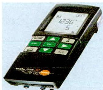
Figura 16. Analizador de gases de la combustión
