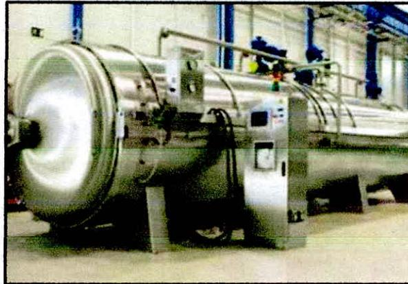
Figura 6. Cocedor de atún a vapor TUNIVAC
