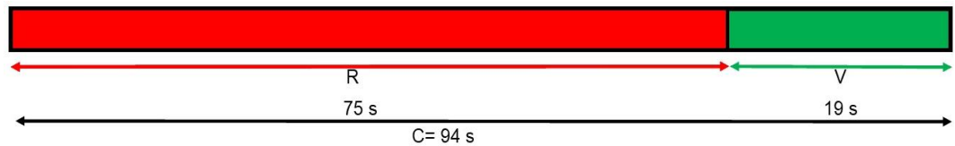
Figura 26. Diagrama de fases del Semáforo Peatonal N° 2 Intersección Jr. Alfonso Ugarte con Av. José Gálvez Sentido: Oeste – Este. Realizado el 04/12/17 Hora: 8 am. Fuente: Elaboración Propia.
