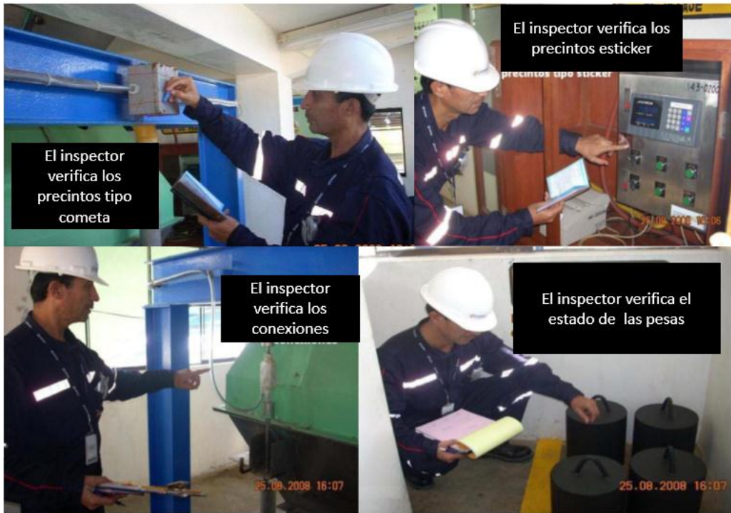
Fig. 9 Verificación de Requisitos Técnicos de Instrumentos de Pesaje (tolva).
