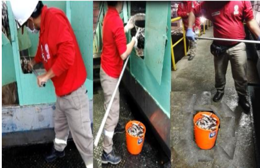
Fig. 13 Inspector tomando la muestra en la caída de la pre-tolva
